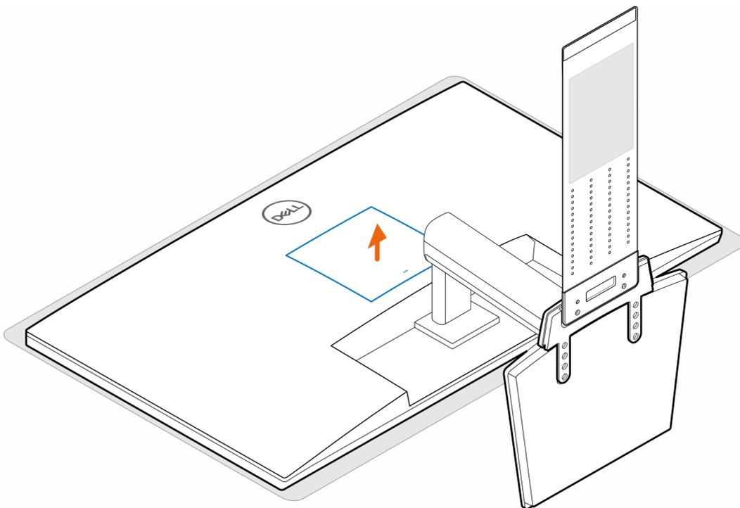
6. Instale os quatro parafusos (M4x10) para fixar o suporte VESA ao monitor.
