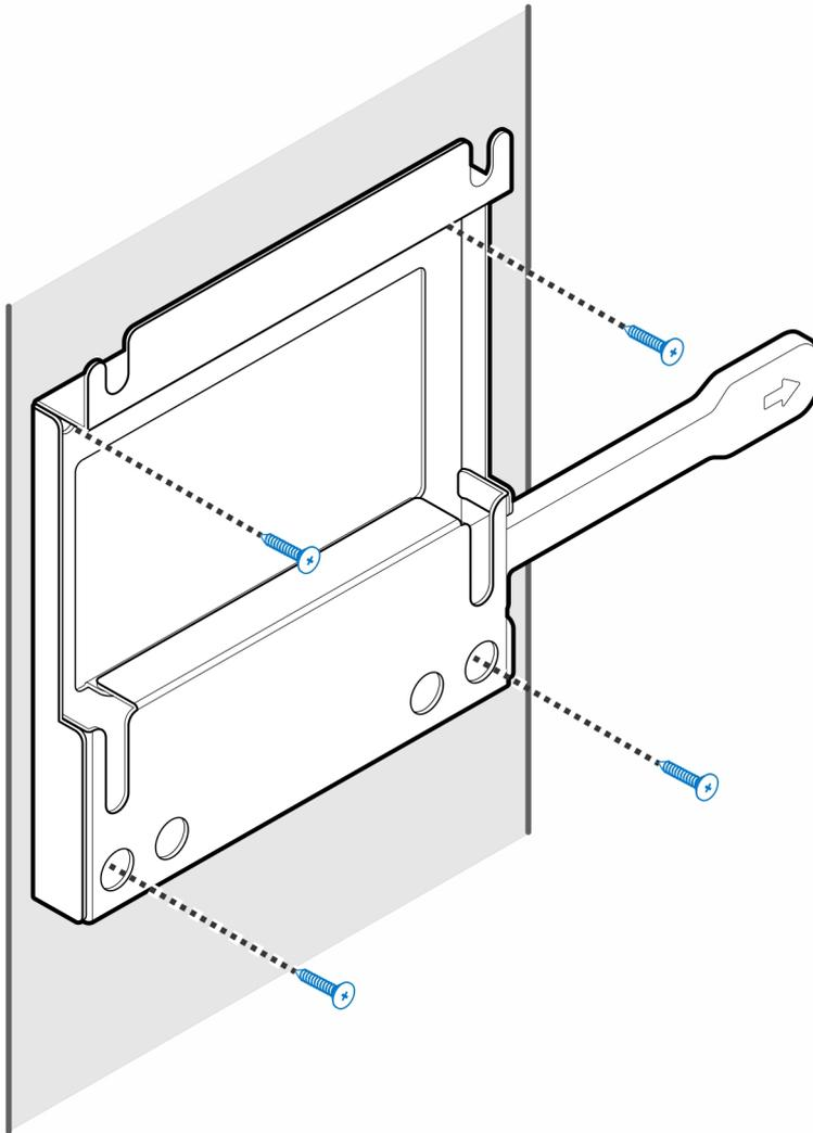
4. Instale os dois parafusos (M3x6) para fixar a camisa do transformador CA ao suporte VESA.
