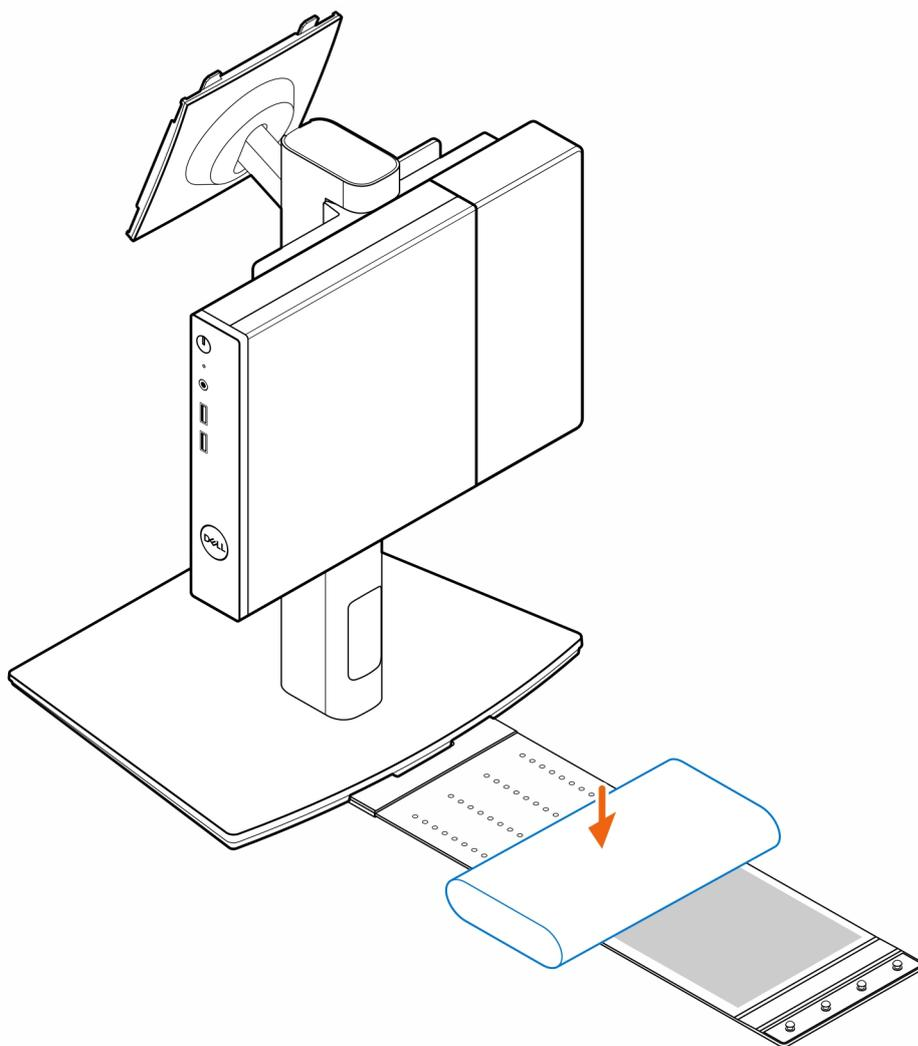
6. Envolve a camisa em volta do transformador CA e insira as patilhas de retenção dentro dos respectivos orifícios na camisa do transformador CA, num nível adequado.
