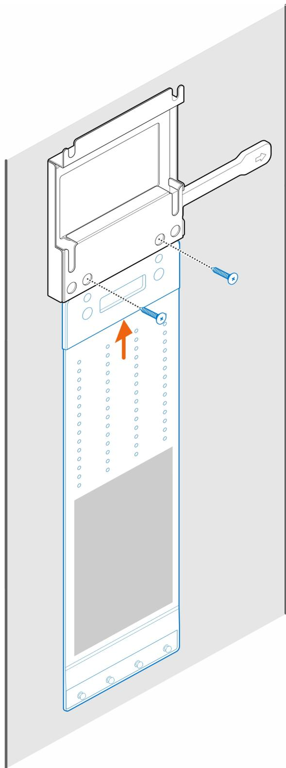
5. Instale os quatro parafusos de passo (M4x4) no chassis.
