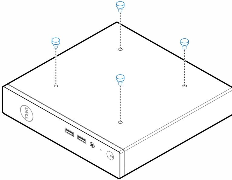
8. Alinhe os parafusos de passo (M4x4) com os entalhes no suporte VESA e monte o computador no suporte VESA.
