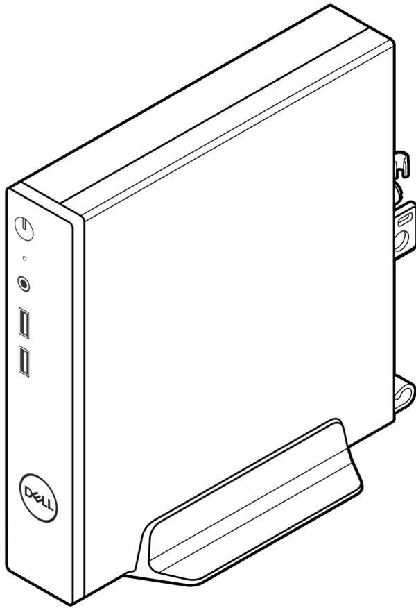
3. Encaminhe o cabo de alimentação através do gancho na base vertical para evitar a desconexão acidental do cabo de alimentação.
