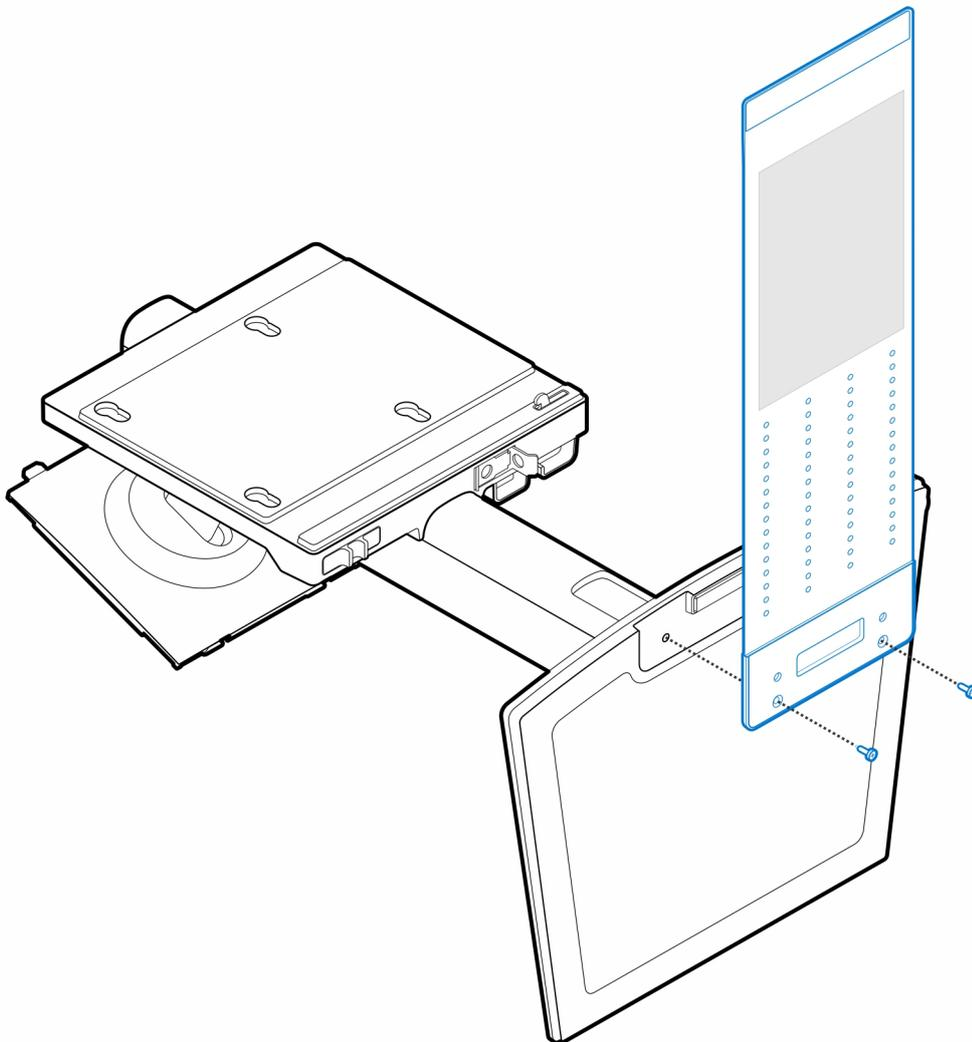
2. Instale os quatro parafusos de passo (M4x4) no chassis.
