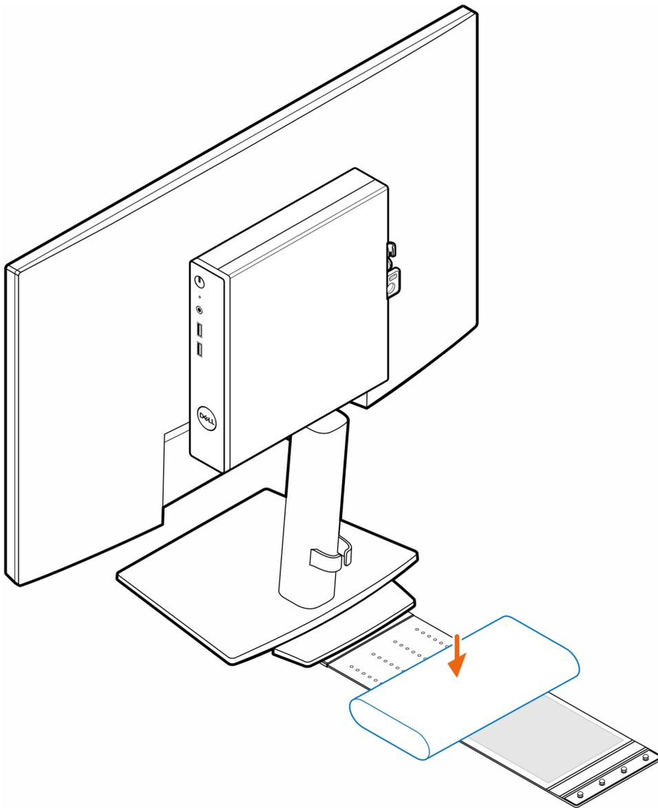
10. Envolve a camisa em volta do transformador CA e insira as patilhas de retenção dentro dos respectivos orifícios na camisa do transformador CA, num nível adequado.
