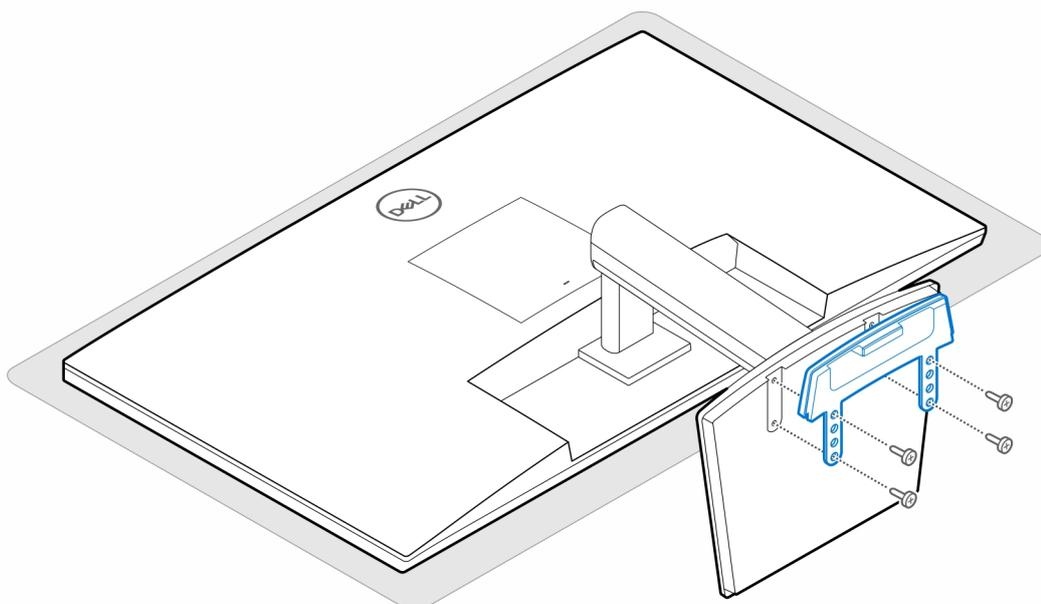
4. Instale os dois parafusos (M3x6) para fixar a camisa do transformador CA (upsell) à chapa extensora.
