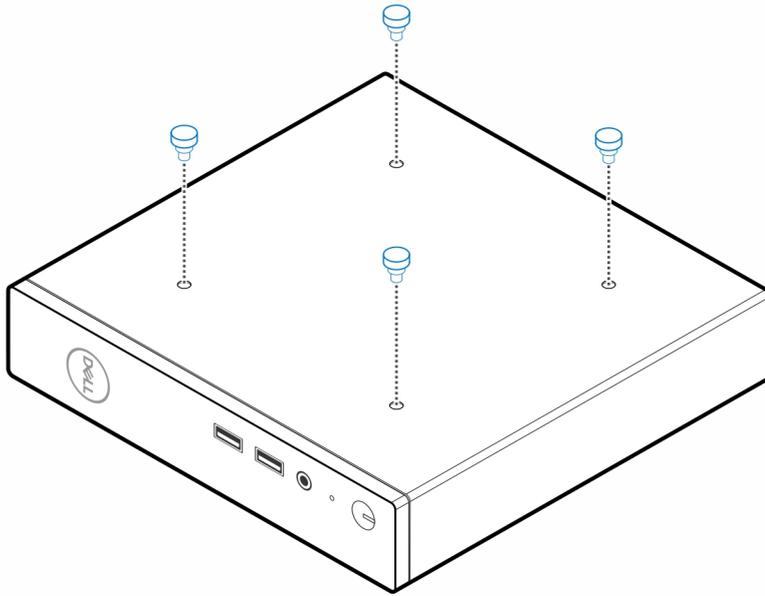
3. Alinhe os parafusos de passo (M4x4) com os entalhes no suporte multifunções e monte o computador no suporte multifunções.
