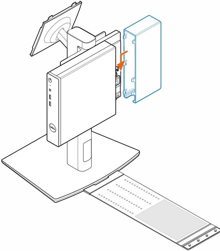
5. Coloque o transformador CA na camisa do transformador CA.
