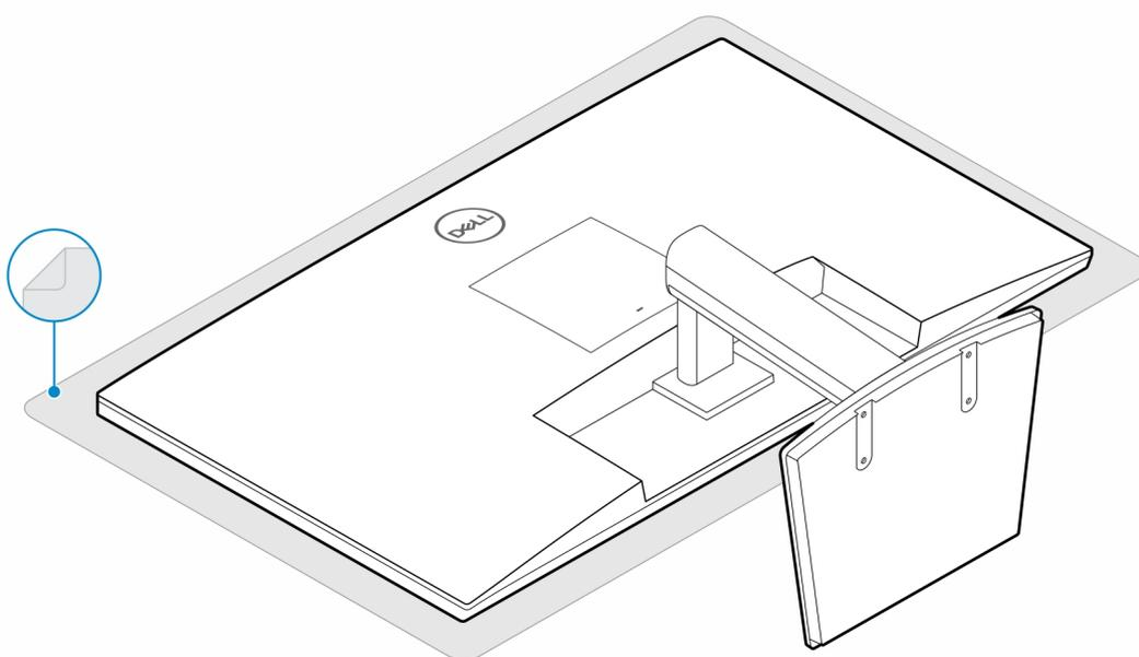
3. Instale os quatro parafusos (M2.5x7) para fixar o extensor ao suporte de monitor.
