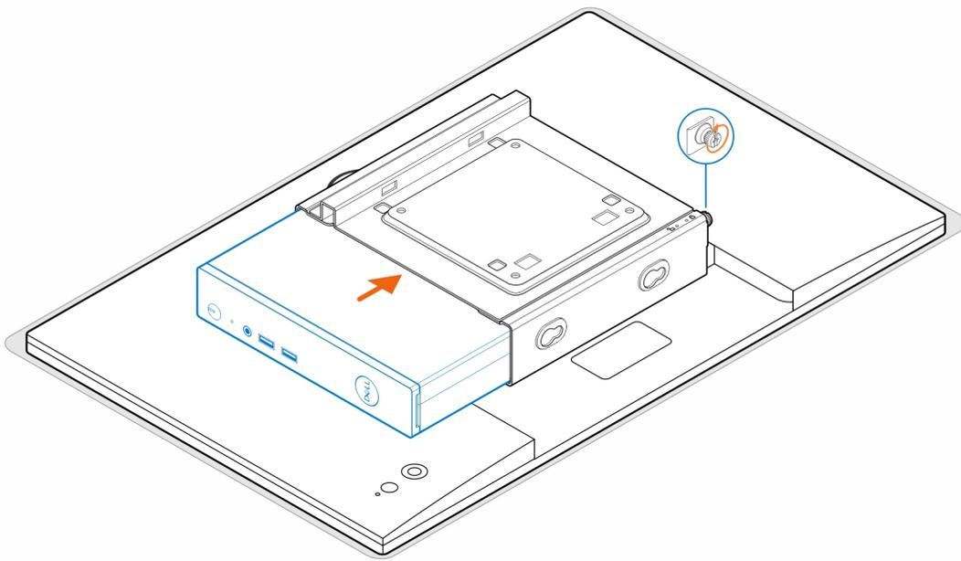
7. Alinhe os parafusos na caixa do transformador com os orifícios dos parafusos no suporte VESA e insira a caixa do transformador para a fixar no lugar.
