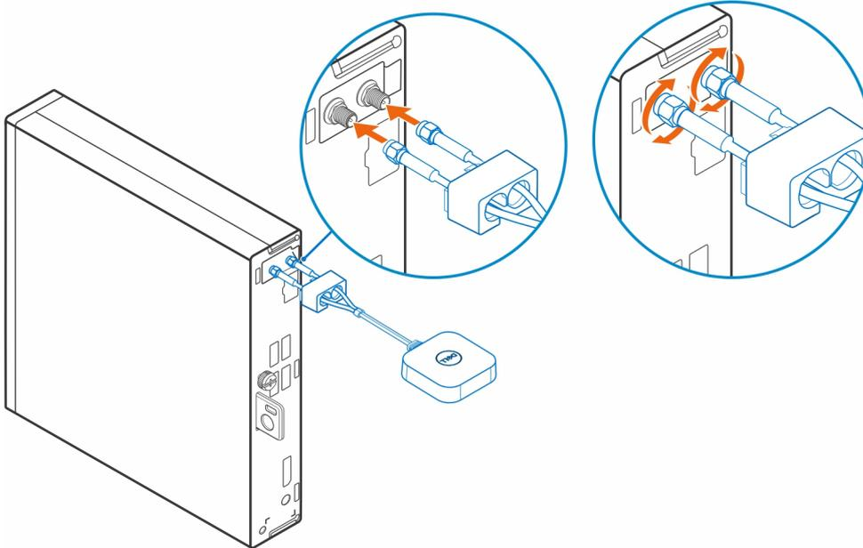
4. Deslize a tampa do SMA ao longo dos cabos da antena.
