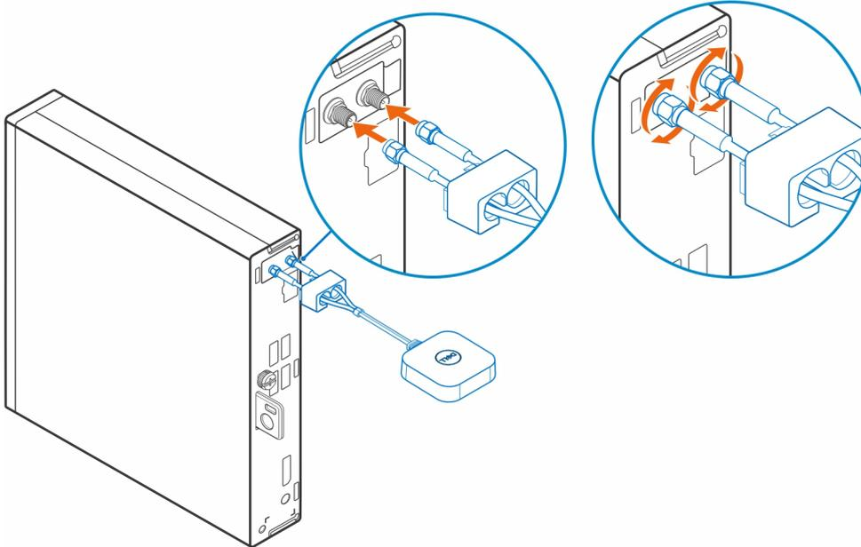
4. Deslize a tampa SMA sobre cabos da antena.
