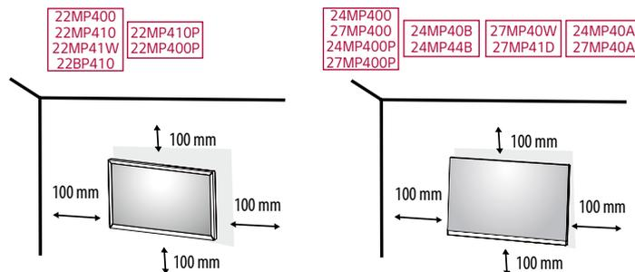
Per installare il monitor su una parete, fissare una staffa per montaggio a parete (opzionale) al retro del monitor. Assicurarsi che la staffa per montaggio a parete sia fissata saldamente al monitor e alla parete.
