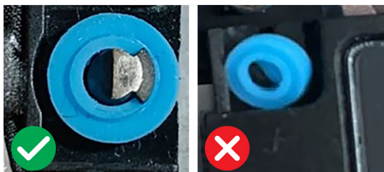
Afbeelding 40. Positie van de rubberen dichtingsringen
