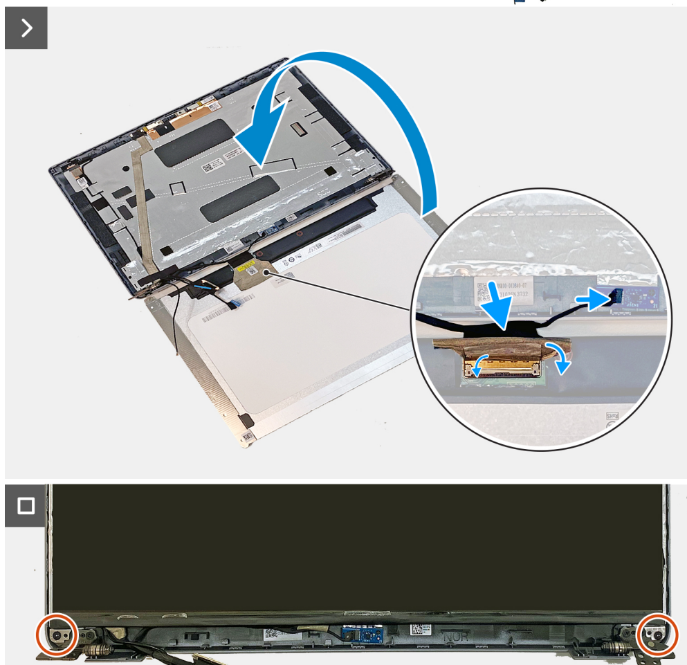
Afbeelding 57. Het beeldschermpaneel installeren
