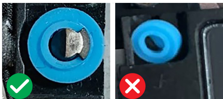
Figure 40. Positionnement des passe-câbles en caoutchouc
