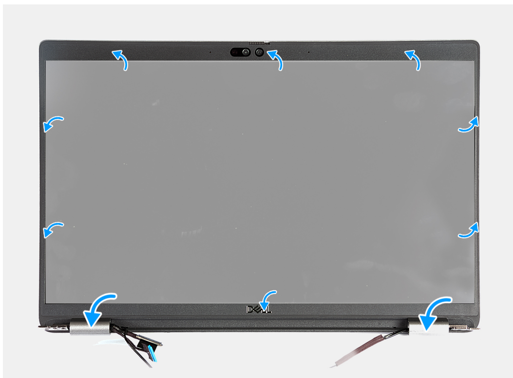
Figure 54. Installation de la bordure d'écran
