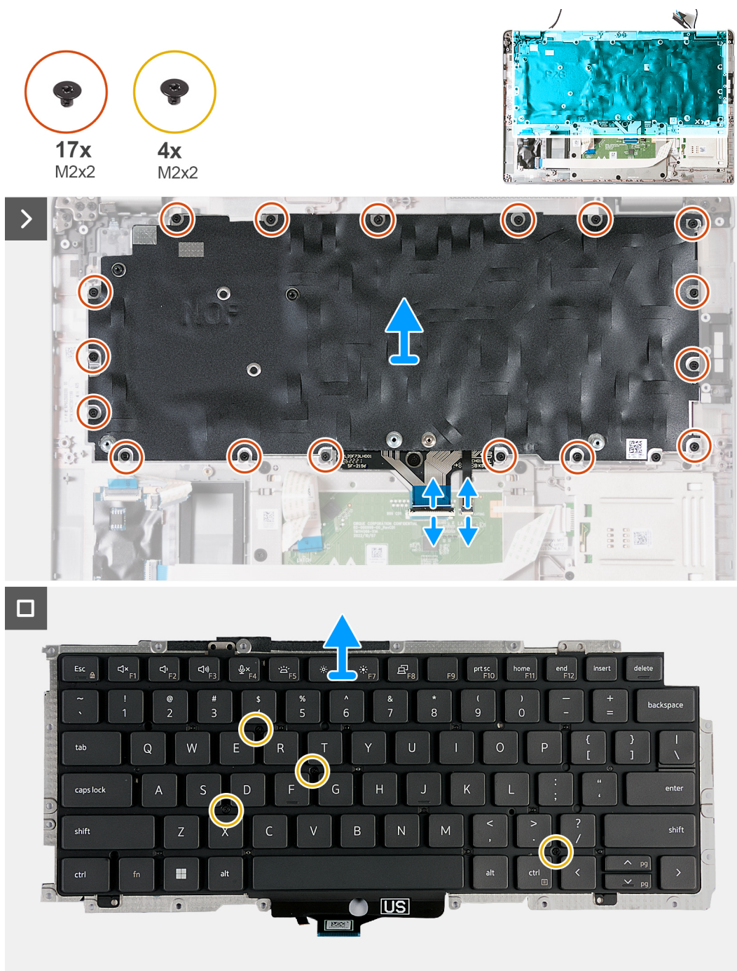
Figure 79. Retrait du clavier
