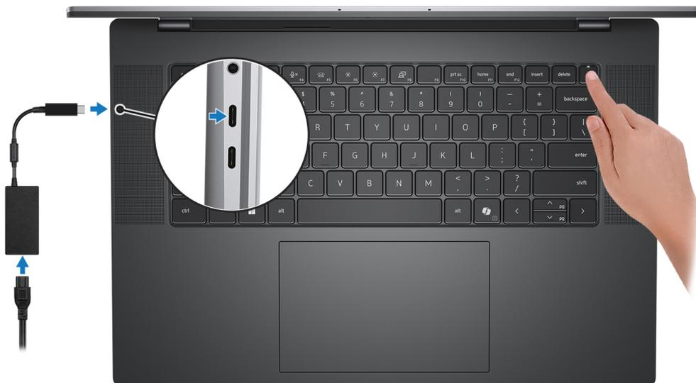
**Figure 10. Connexion de l'adaptateur secteur et appui sur le bouton d'alimentation**
