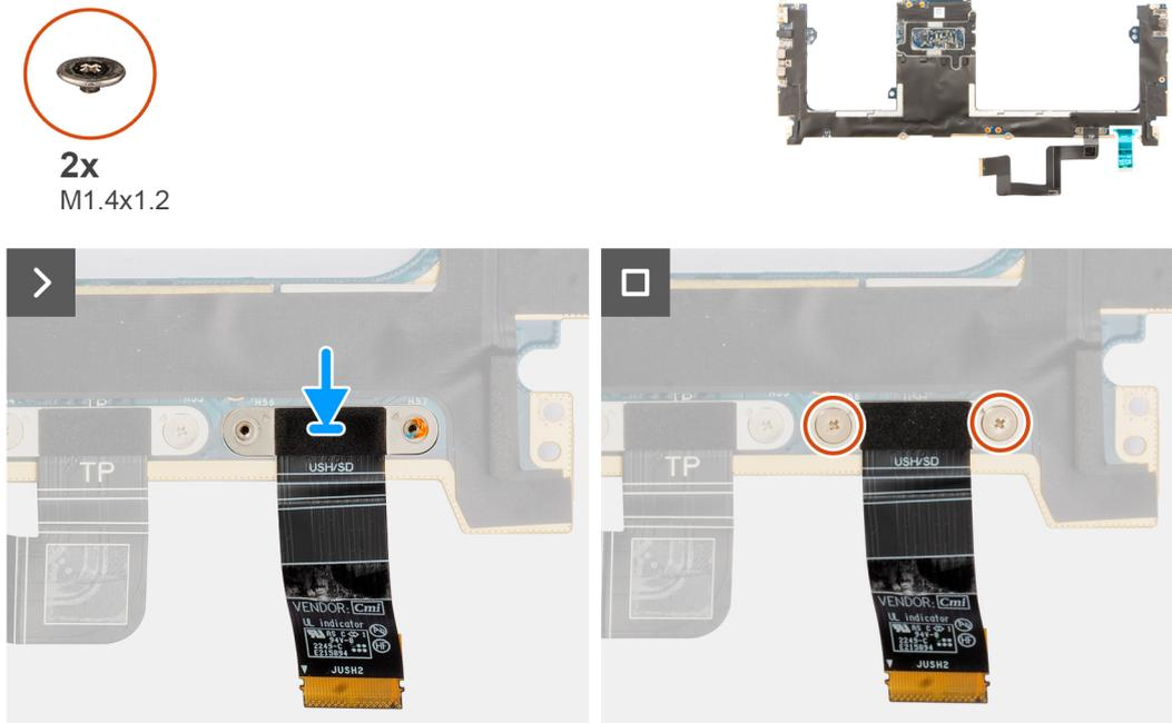
Abbildung 94. Installieren des FPC-Kabels der SD-Karten-Zusatzplatine
