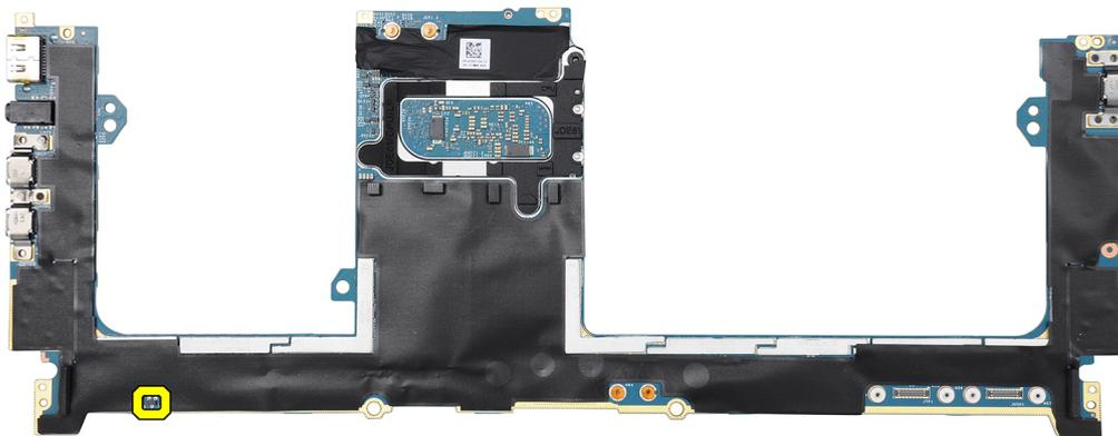
Abbildung 12. HALL-Sensor und Magnet des HALL-Sensors
