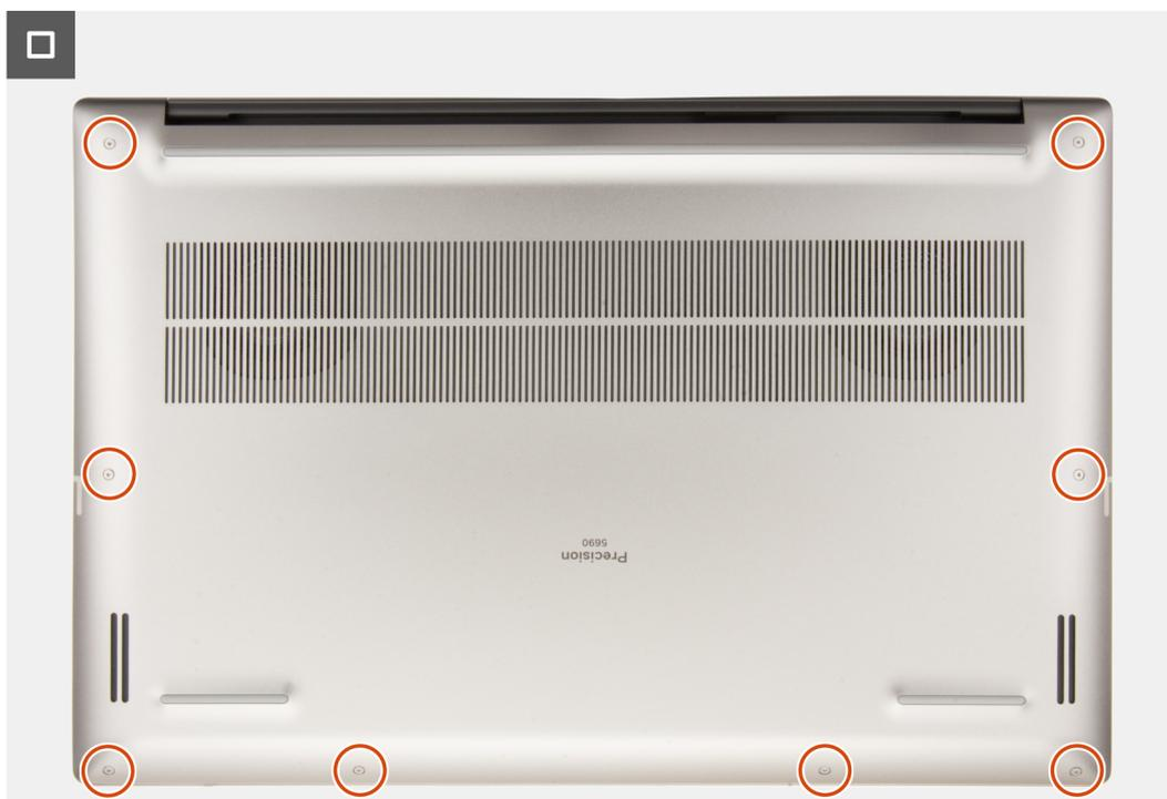
Abbildung 35. Installieren der Bodenabdeckung
