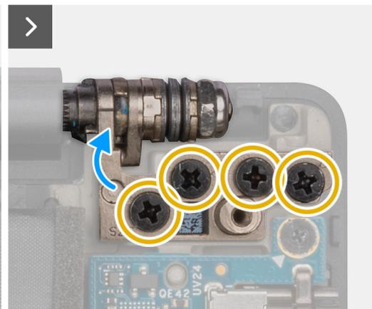
Abbildung 50. Entfernen der Displaybaugruppe
