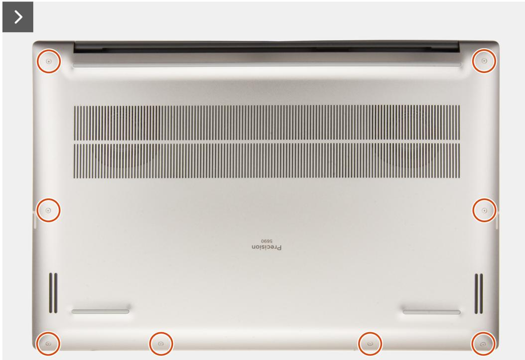
Abbildung 31. Entfernen der Bodenabdeckung
