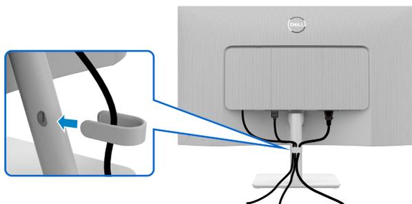
Dopo avere collegato tutti i cavi necessari al monitor ed al computer (fare riferimento alla sezione [Collegamento del monitor](#) per il collegamento dei cavi), organizzare tutti i cavi come mostrato sopra.
