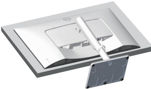
2. Appuyez sur le bouton de déverrouillage du support à l'arrière de l'écran et maintenez-le enfoncé.
