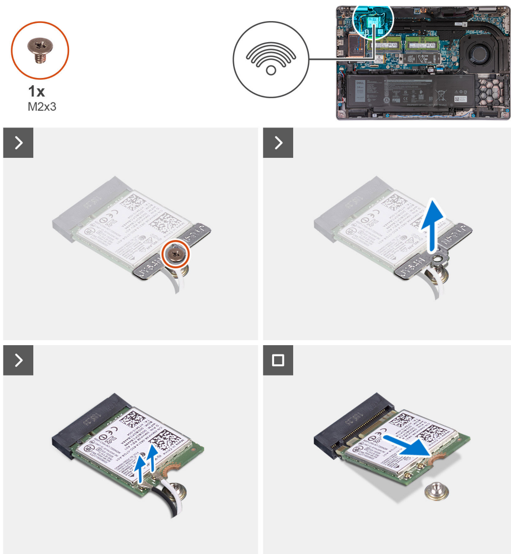
Rysunek 19. Wymontowywanie karty sieci bezprzewodowej
