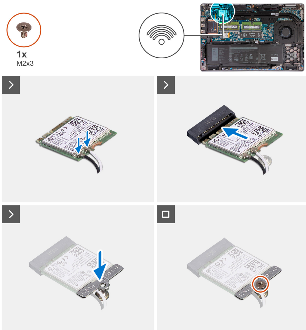
Rysunek 20. Instalowanie karty sieci bezprzewodowej
