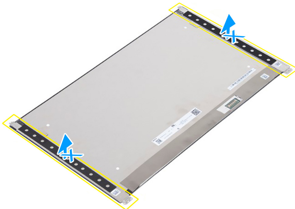
Rysunek 83. Nie ciągnij ani nie odrywaj taśmy elastycznej (SR)
