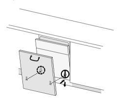
2 Rimuovere le 2 viti dal coperchio frontale. Fissare il pannello dello sportello allo sportello della lavastoviglie utilizzando le viti per legno fornite ( $\Phi$  4 x 40 mm).
