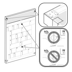
3 Utilizzare una punta da trapano del diametro di 2 mm per praticare fori pilota di 10 mm di profondità nei 10 punti tracciati sul modello.
