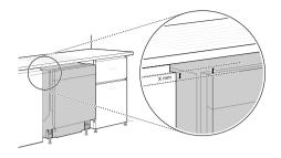
3 Utilizzando la misurazione dal passaggio 2, fare un segno (X mm) dalla parte inferiore di tutti e due i righelli alla parte superiore del modello di installazione in dotazione.
