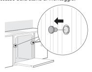
2 Inserire una vite per legno (Φ 4 x 16 mm) attraverso la staffa di montaggio e nel telaio dell'armadietto.
