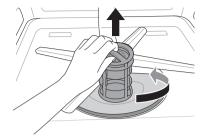
Pulire i filtri con una spazzola morbida sotto l'acqua corrente. Rimontare i filtri prima di reinstallarli.
