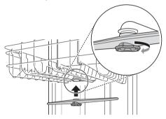
7 Dopo il montaggio, controllare che i bracci di spruzzo si muovano agevolmente.
