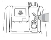
3 Chiudere il coperchio e serrare l'erogatore. Il brillantante viene erogato automaticamente durante il ciclo finale di risciacquo.
