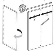
Allineare la linea superiore e centrale sul modello dell'installazione con la linea superiore e centrale del pannello dello sportello.
