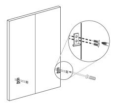
Attaccare una maniglia alla parte anteriore del pannello dello sportello prima di montare il pannello sulla lavastoviglie. Fare in modo di svasare le viti così da garantire il regolare scorrimento del pannello.
