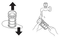
4 Per sostituire un filtro assemblato, posizionare il braccio di spruzzo in modo che l'apertura a V più ampia sia rivolta verso la parte anteriore. Montare nuovamente i filtri nel loro alloggiamento e bloccarli ruotando il filtro interno in senso orario fino a quando non si avverte un clic ed esso è bloccato in posizione.
