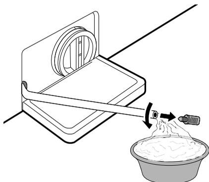
**4** Svitare il filtro della pompa di scarico lentamente per scaricare l'acqua rimanente e poi procedere alla rimozione di eventuali residui o oggetti dal filtro.
