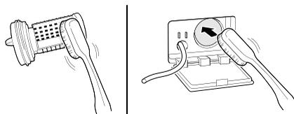
**6** Dopo aver pulito il filtro della pompa di scarico, reinserisca con attenzione il filtro e riavviti il tappo di scarico in senso orario, per evitare filettature incrociate e perdite.
