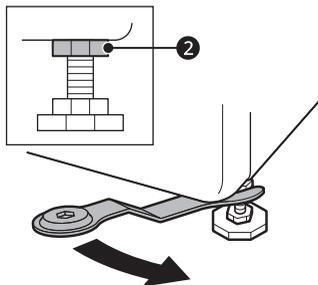
**4** Verificare se tutti i controdati sul fondo dell'elettrodomestico sono fissati adeguatamente.
