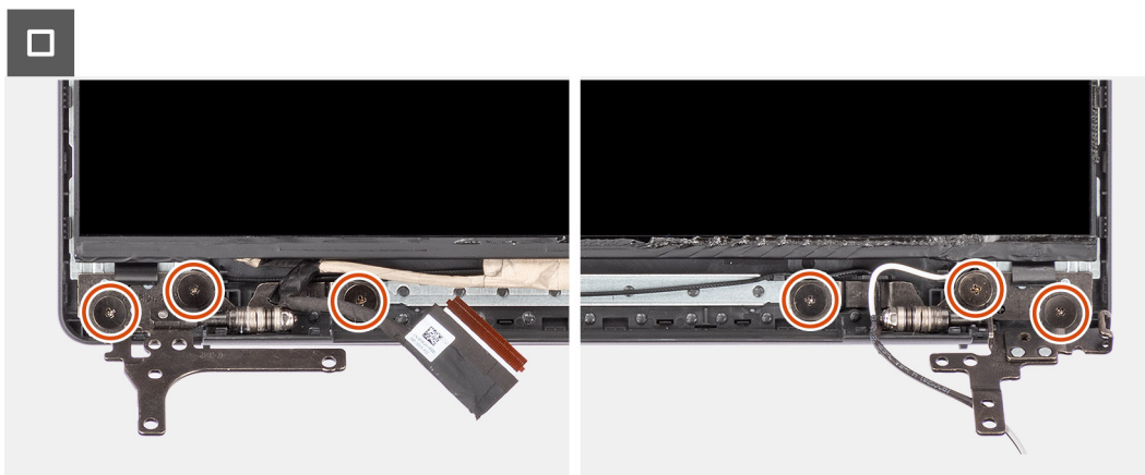
איור 86. התקנת לוח הצג
