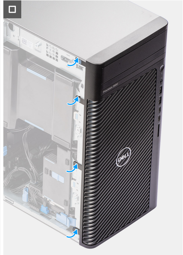
איור 13. התקנת מסגרת הצג הקדמית
