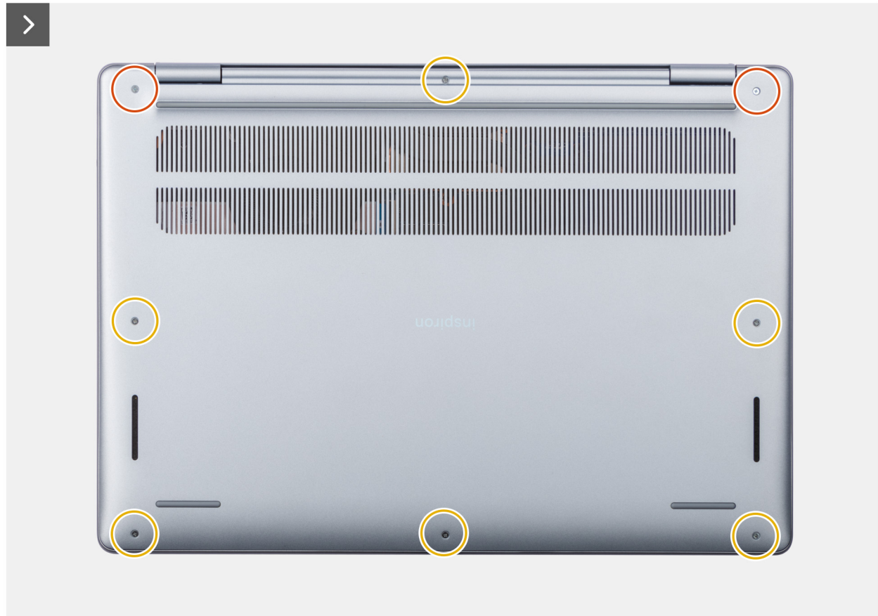
איור 9. הסרת כיסוי הבסיס
