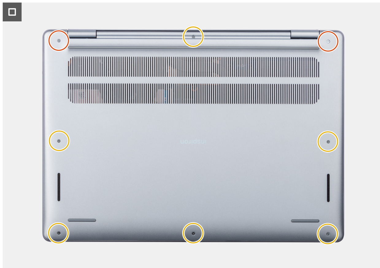
איור 12. התקנת כיסוי הבסיס
