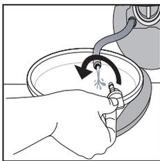
6. Quando il contenitore è pieno d'acqua, inserire il tappo nell'estremità del tubo e reintrodurre il tubo nella base della lavatrice. Quindi svuotare il contenitore e chiudere saldamente il tubo di scarico di emergenza con il tappo.
