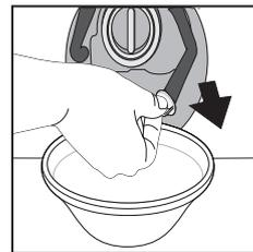
5. Ruotare il tappo del "tubo di scarico di emergenza" all'estremità del tubo e lasciar defluire l'acqua nel contenitore.
