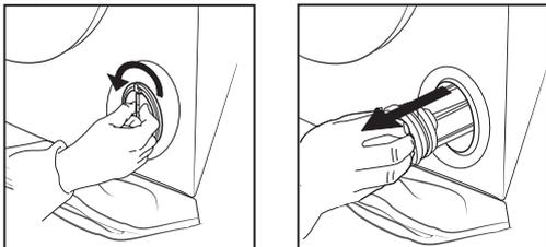
8. Pulire il filtro della pompa di scarico: eliminare i residui presenti nel filtro e lavarlo sotto l'acqua corrente.
