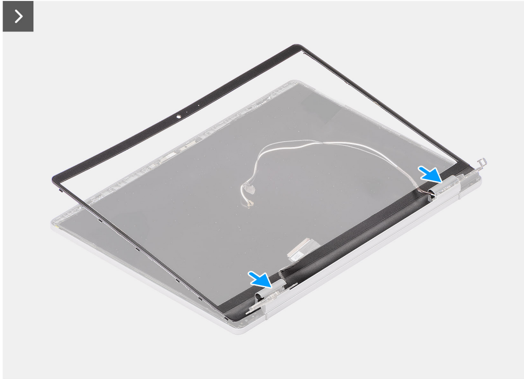
איור 51. התקנת מסגרת הצג
