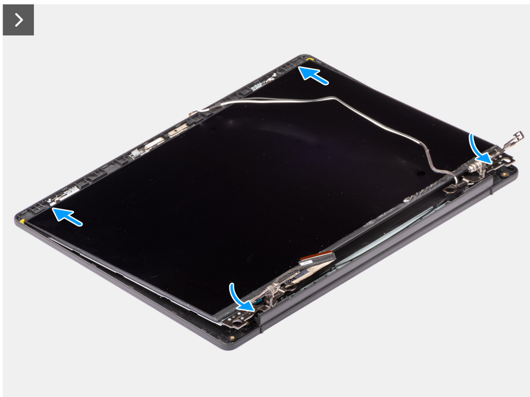
איור 59. התקנת לוח הצג
