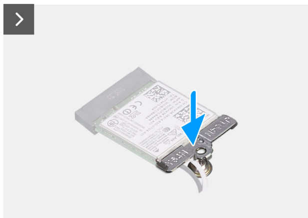
Rysunek 19. Instalowanie karty sieci bezprzewodowej
