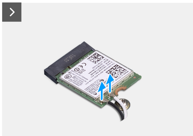
Rysunek 18. Wymontowywanie karty sieci bezprzewodowej
