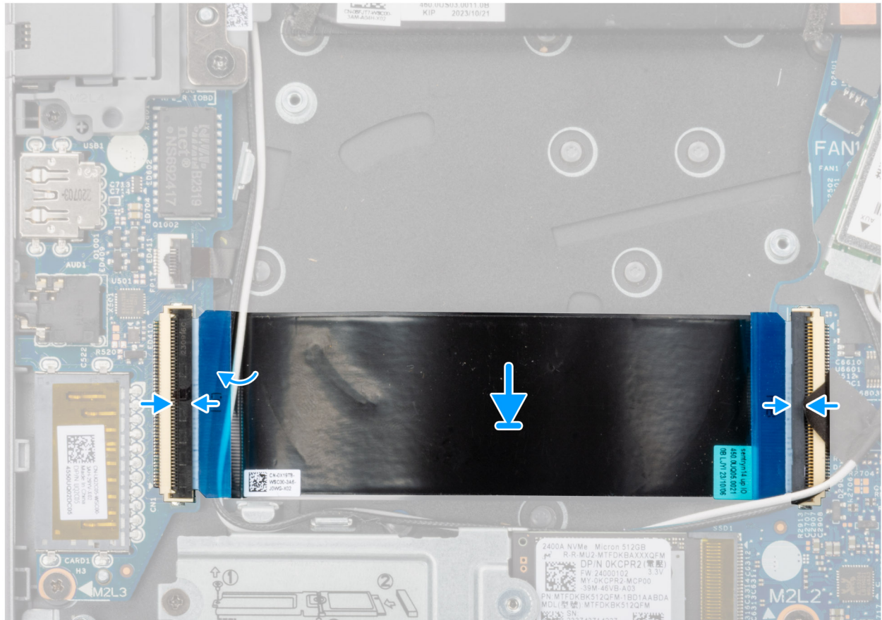
איור 35. התקנת כבל לוח הקלט/פלט
