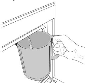
Po wybraniu funkcji „Opróżnianie” wykonać wskazane działania: Otworzyć drzwiczki i włożyć duży dzbanek pod dyszę spustową znajdująca się u dołu po prawej stronie panelu. Po rozpoczęciu opróżniania, utrzymać dzbanek w niezmienionej pozycji, aż do zakończenia operacji. Średni czas trwania opróżniania przy pełnym
