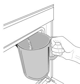
Po vybrání funkce „Vypustit vodu“ provedte uváděné kroky: Otevřete dvířka a pod vypouštěcí trysku na spodní straně panelu vložte velkou nádobu. Jakmile se spustí vypouštění, držte nádobu na místě, dokud není proces dokončen. Průměrná doba odtoku vody při plném naplnění je přibližně tři minuty.
