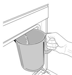
Kad ir atlasīta funkcija “Izliešana”, veiciet norādītās darbības. Atveriet ierīces durvis un zem izliešanas sprauslas, kas atrodas paneļa apakšējā daļā pa labi, novietojiet lielu krūzi. Sākat izliešanu, turiet krūzi paredzētā vietā, līdz izliešana ir pabeigta. Vidējais pilnas izliešanas ilgums ir apmēram trīs minūtes.
