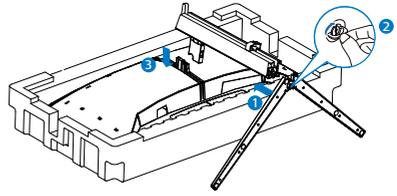
3. Richten Sie den Monitor nach Anbringung der Basis auf, indem Sie ihn mit beiden Händen sicher gemeinsam mit dem Styropor greifen. Nun können Sie das Styropor herausziehen. Drücken Sie den Bildschirm beim Herausziehen des Styropors nicht zusammen. Andernfalls könnte er beschädigt werden.
