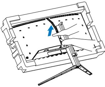
3. Bringen Sie die Verriegelung vorsichtig an der VESA-Halterung an, bis die VESA-Halterung an der Verriegelung einrastet.
