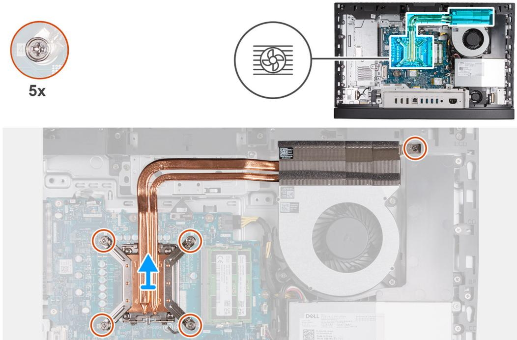
Abbildung 62. Kühlkörper entfernen
