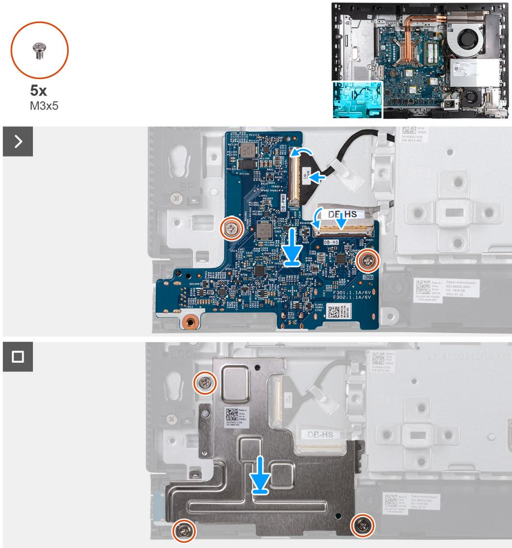
Abbildung 73. Einbauen der Netzschalter- und E/A-Platine
