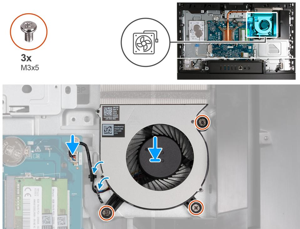
Abbildung 104. Einbauen des Lüfters
