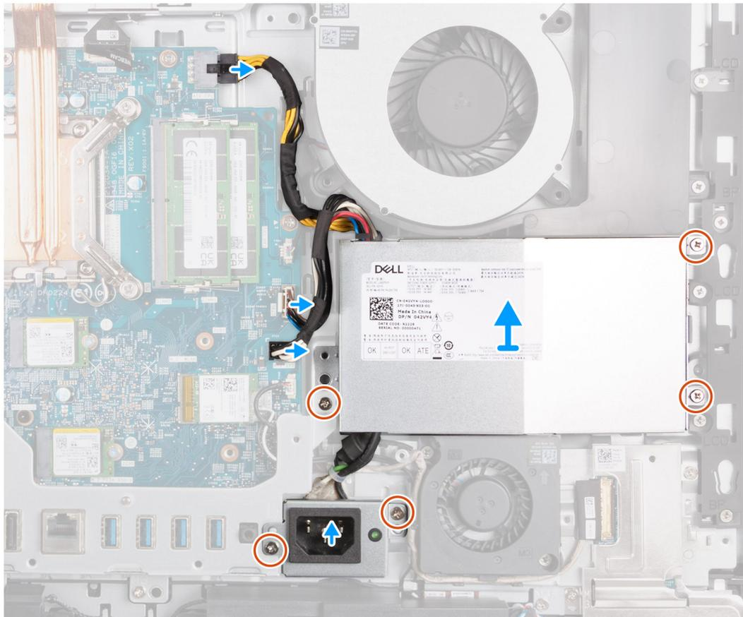
Abbildung 50. Entfernen der Stromversorgungseinheit
