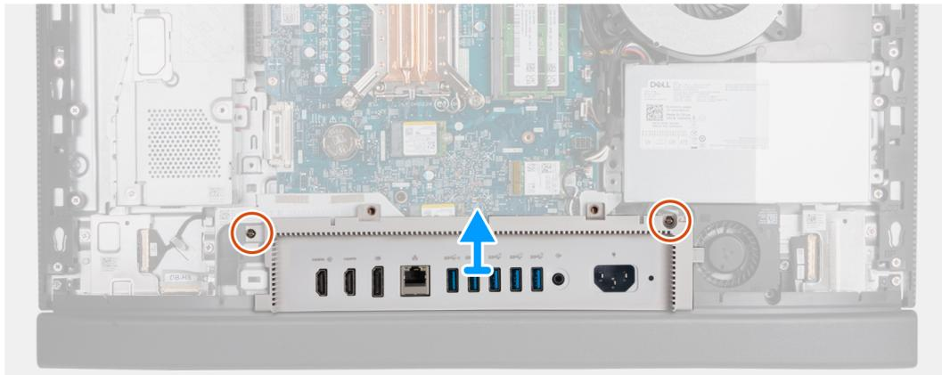
**Abbildung 42. Entfernen der I/O-Abdeckung**
