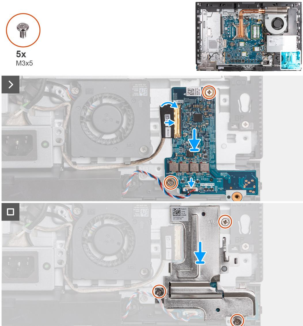
Abbildung 75. Einbauen der Audioplatine
