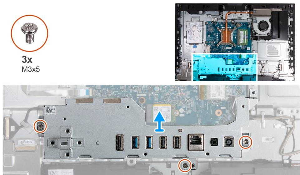
Abbildung 105. Entfernen der E/A-Halterung
