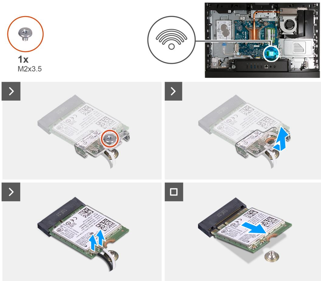
Abbildung 88. Entfernen der Wireless-Karte
