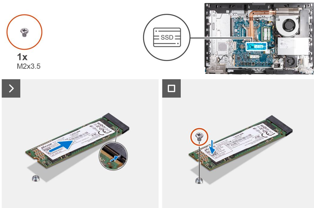
Abbildung 33. Installieren des M.2 2280-SSD-Laufwerks in M.2-Steckplatz 0
