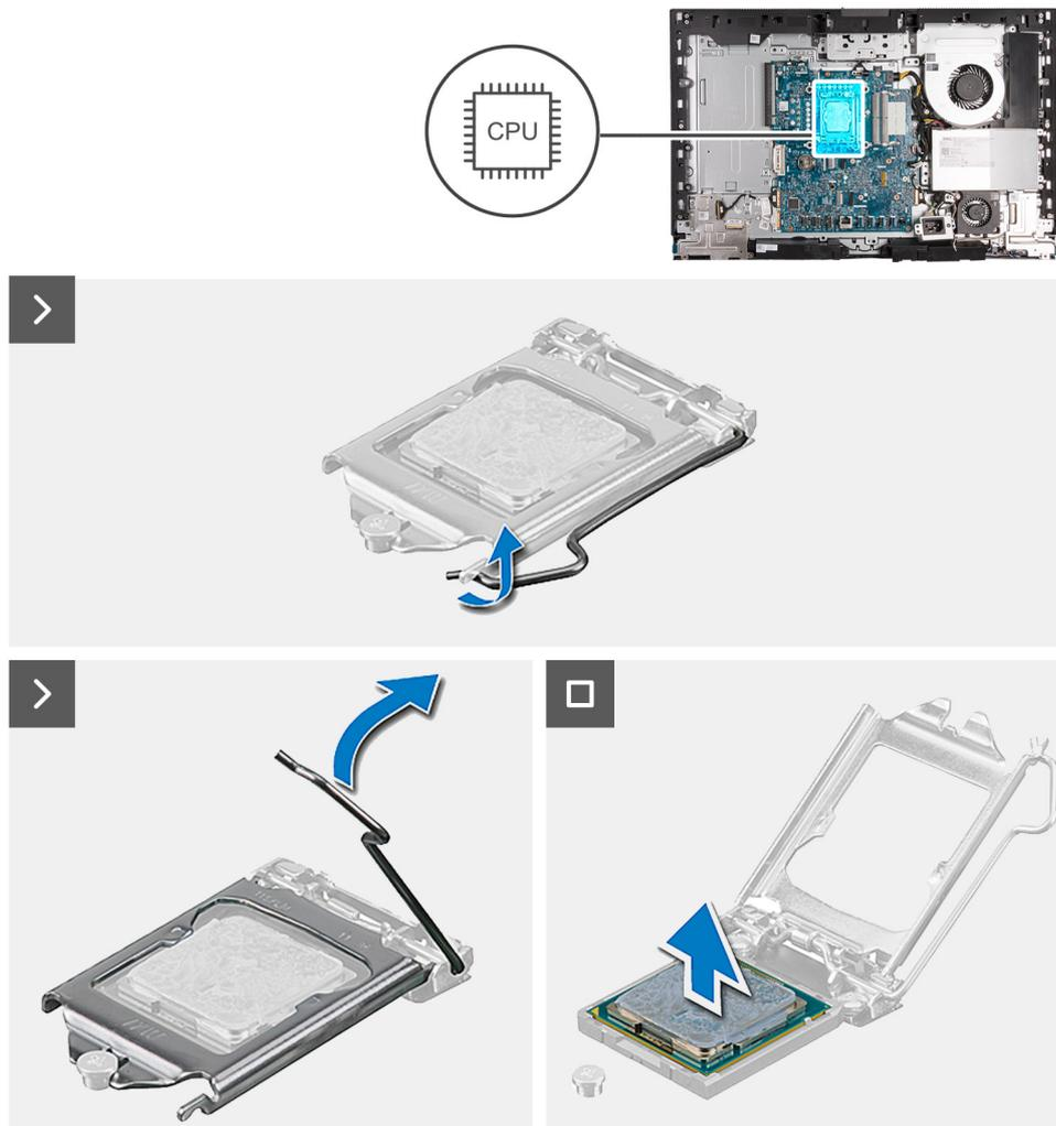
Abbildung 64. Entfernen des Prozessors
