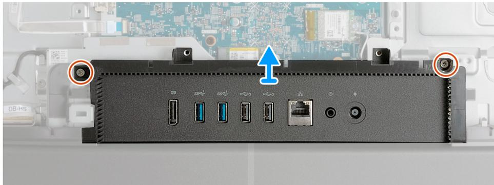
**Abbildung 97. Entfernen der E/A-Abdeckung**
