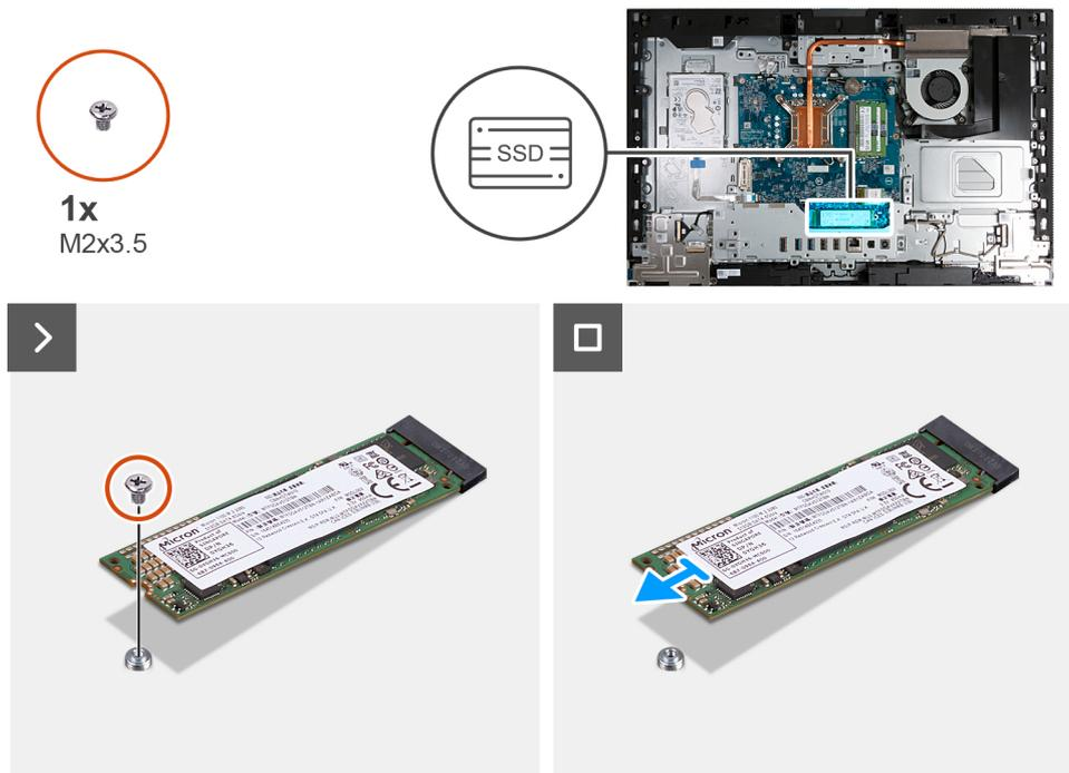
Abbildung 92. Entfernen des M.2-2280-Solid-State-Laufwerks
