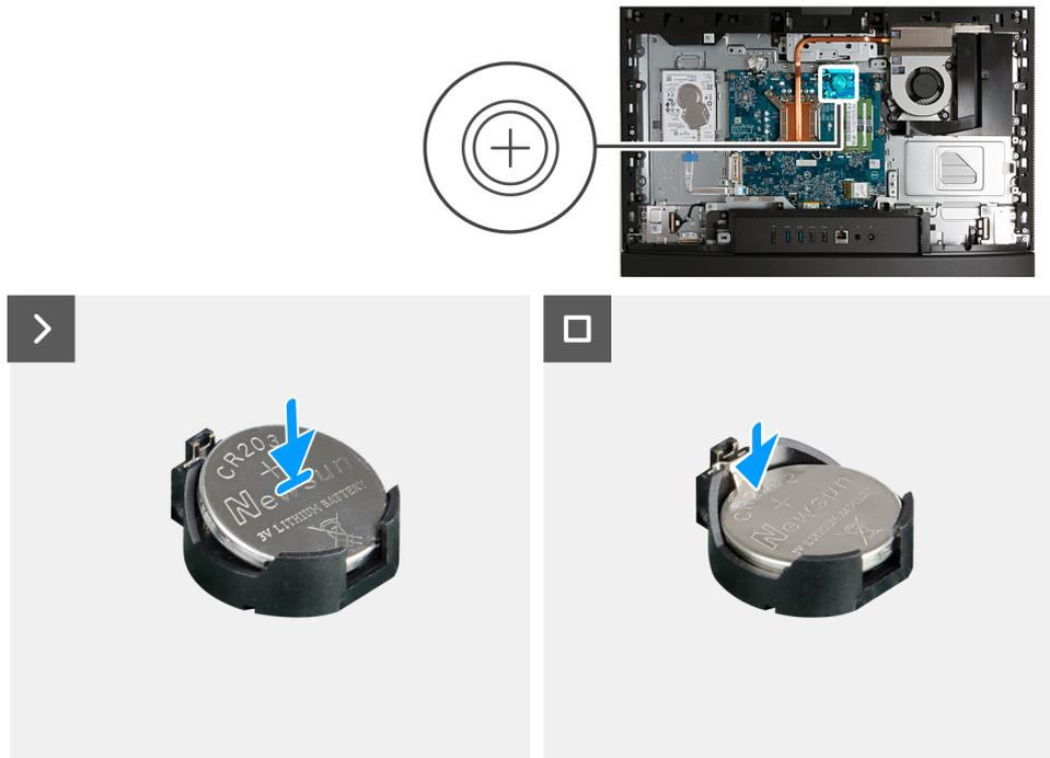
Abbildung 96. Einsetzen der Knopfzellenbatterie
