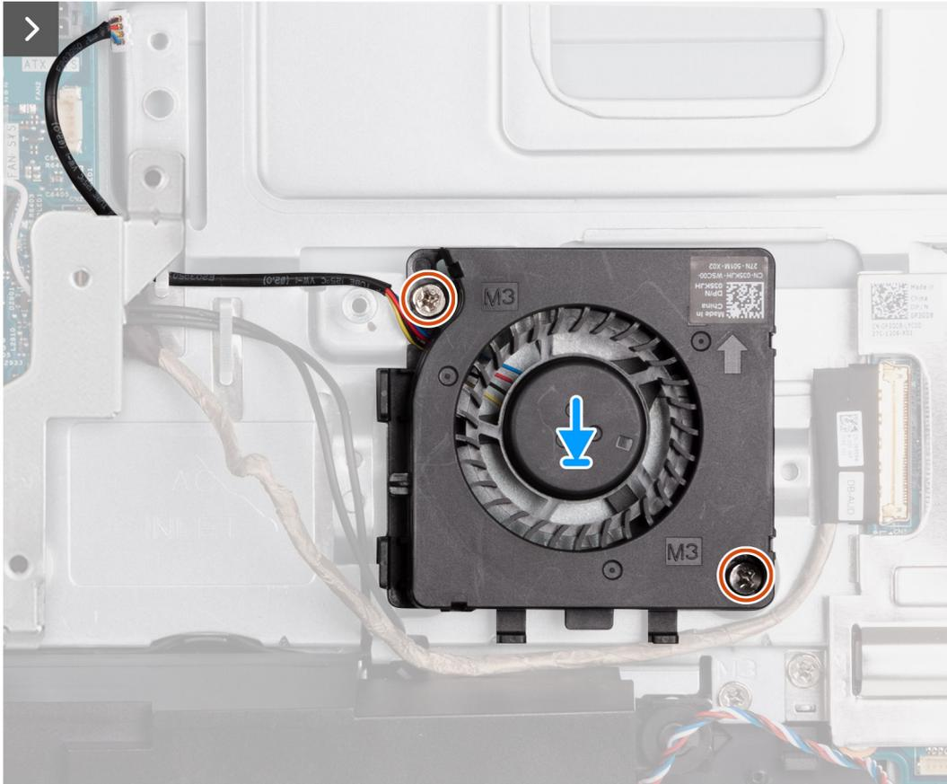
Abbildung 55. Einbauen des Netzteil­lüfters
