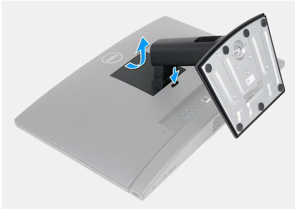
Abbildung 78. Entfernen des Ständers
