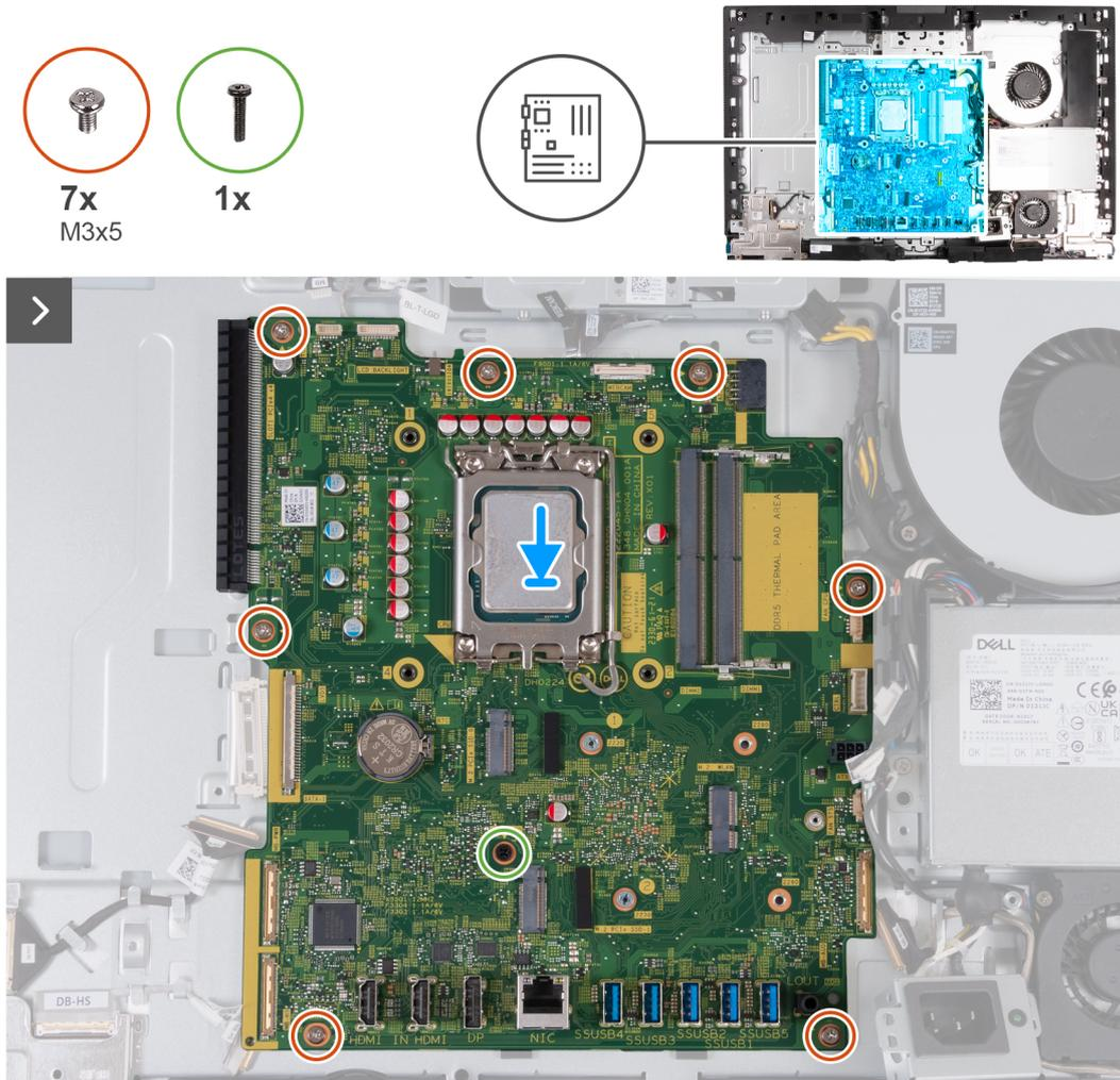
Abbildung 70. Einbauen der Systemplatine
