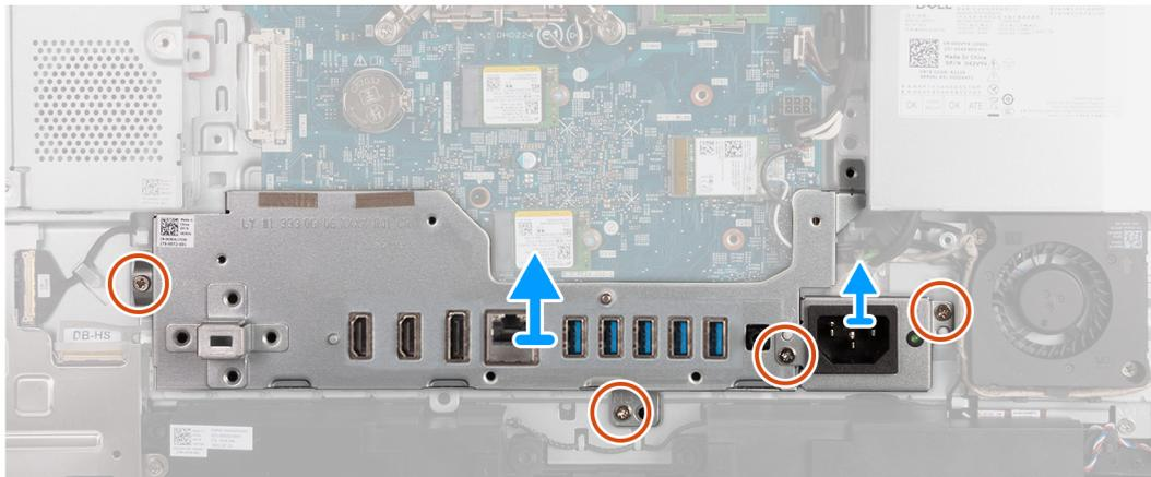
Abbildung 58. Entfernen der E/A-Halterung
