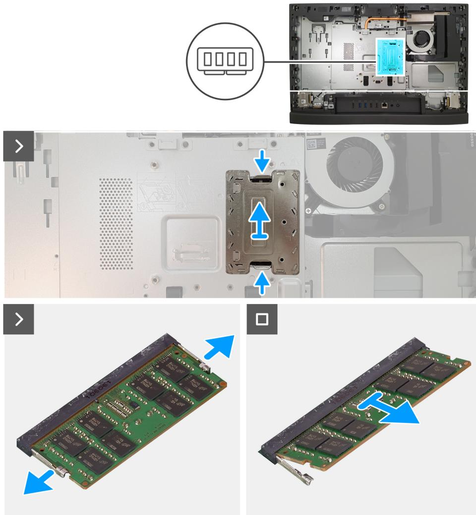
Abbildung 84. Entfernen des Speichers
