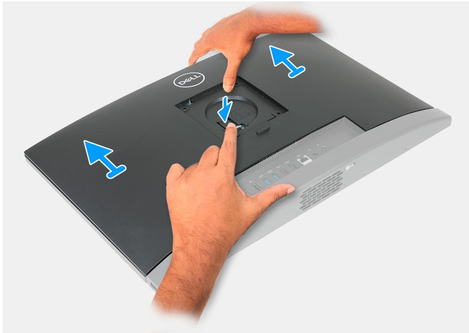
**Abbildung 82. Entfernen der rückseitigen Abdeckung**
