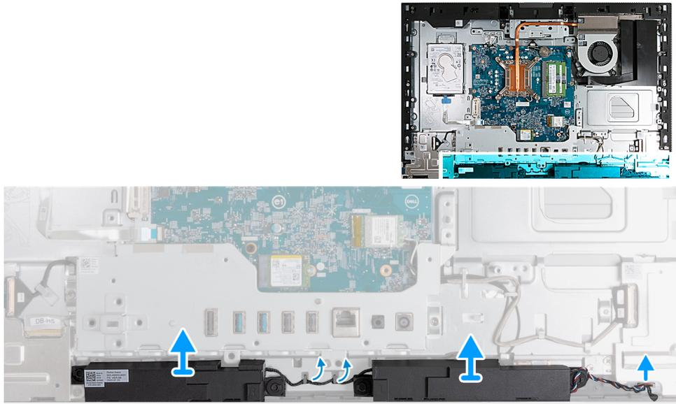
Abbildung 107. Entfernen der Lautsprecher
