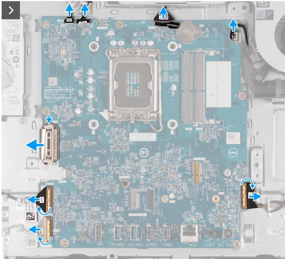
Abbildung 114. Systemplatine entfernen
