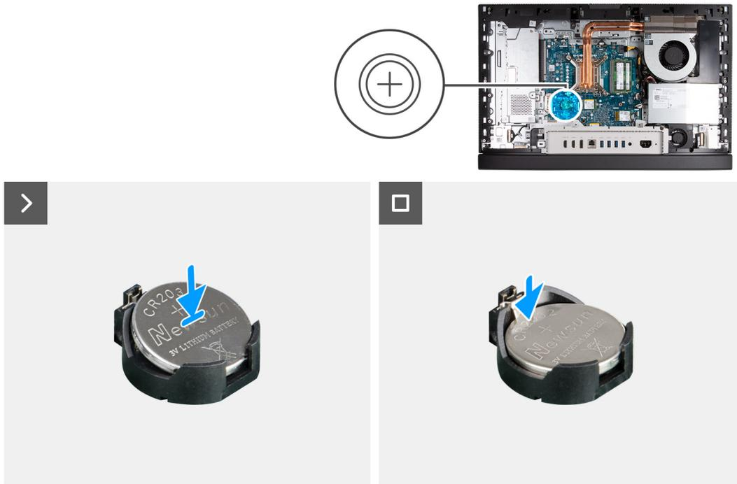
**Abbildung 41. Einsetzen der Knopfzellenbatterie**
