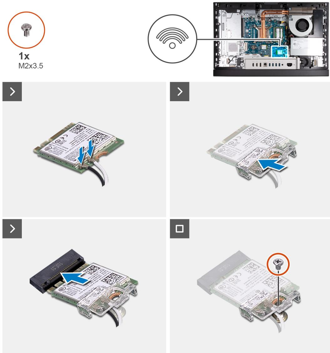
Abbildung 29. Einbauen der Wireless-Karte
