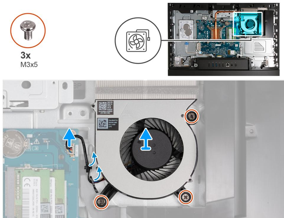
Abbildung 103. Entfernen des Lüfters
