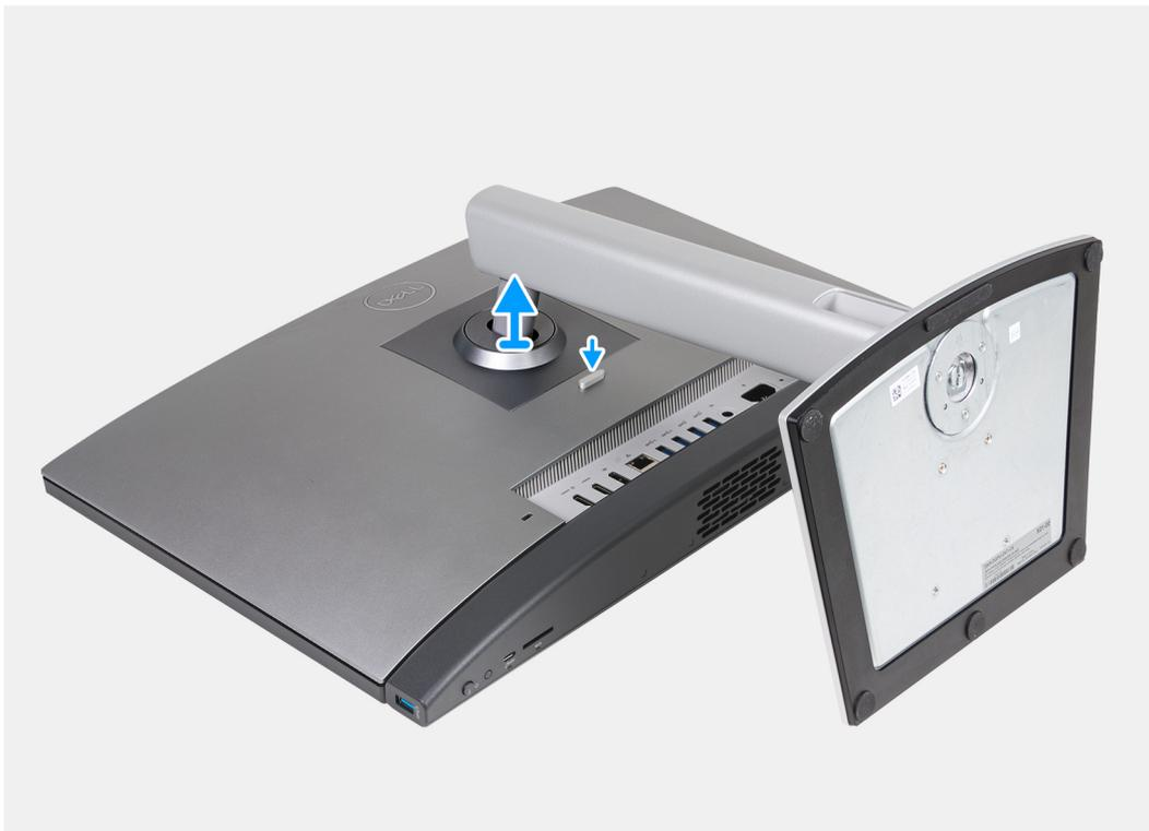
Abbildung 79. Entfernen des Ständers
