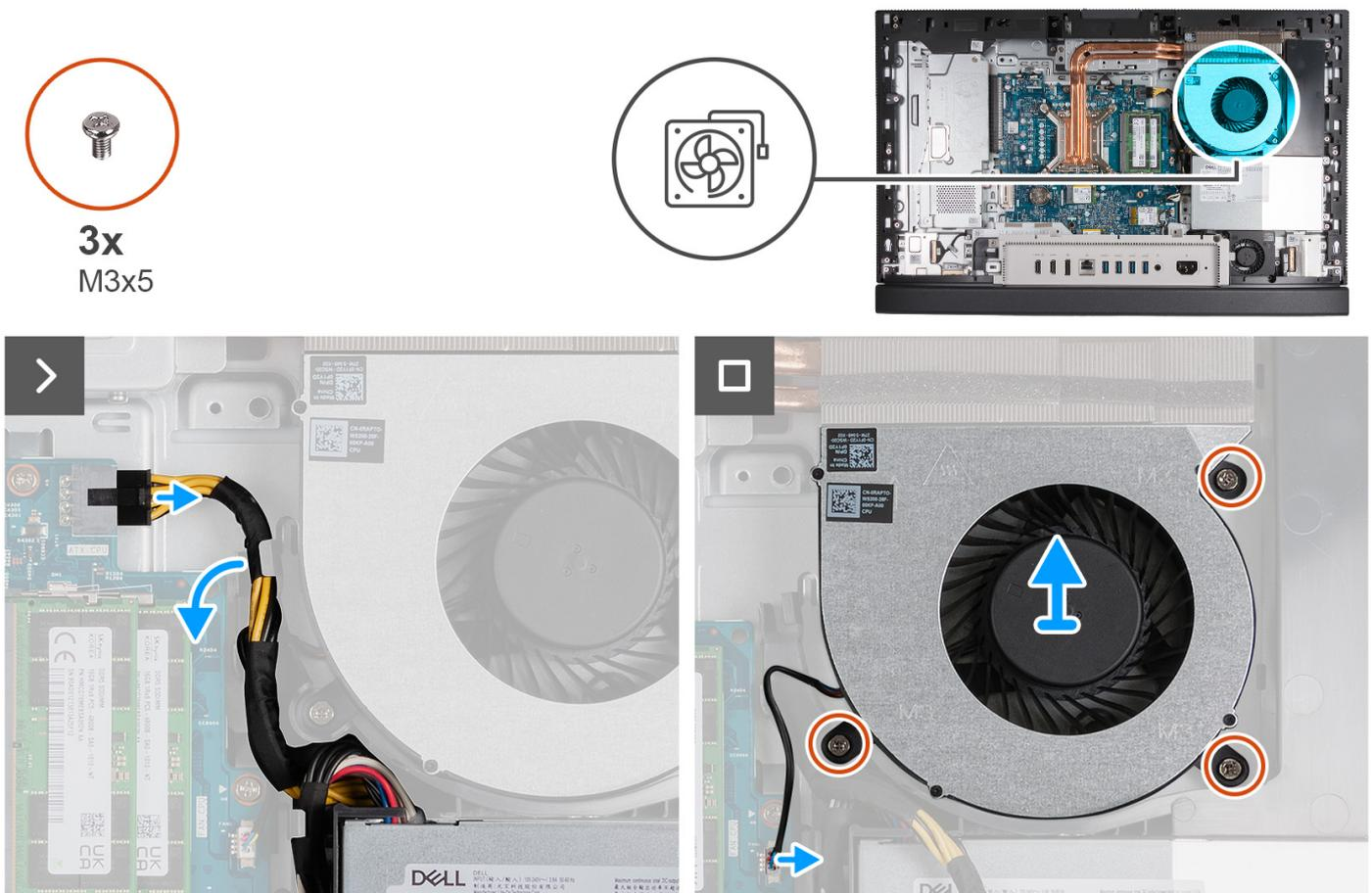
Abbildung 48. Entfernen des Lüfters
