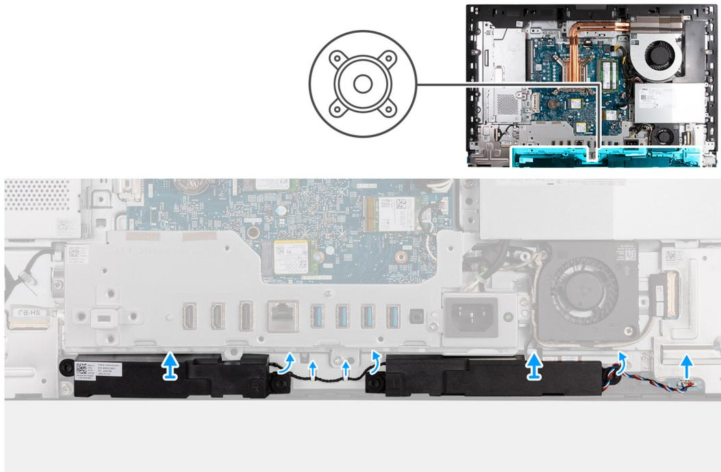
**Abbildung 60. Entfernen der Lautsprecher**
