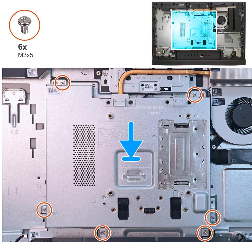
Abbildung 87. Einbauen der Abdeckung der Systemplatine
