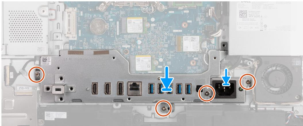
Abbildung 59. Einbauen der E/A-Halterung
