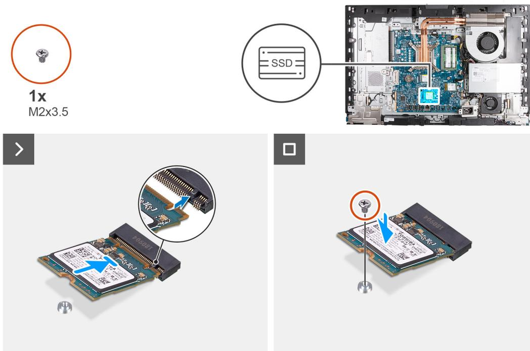
**Abbildung 36. Installieren des M.2-2230-SSD-Laufwerks in M.2-Steckplatz 1**
