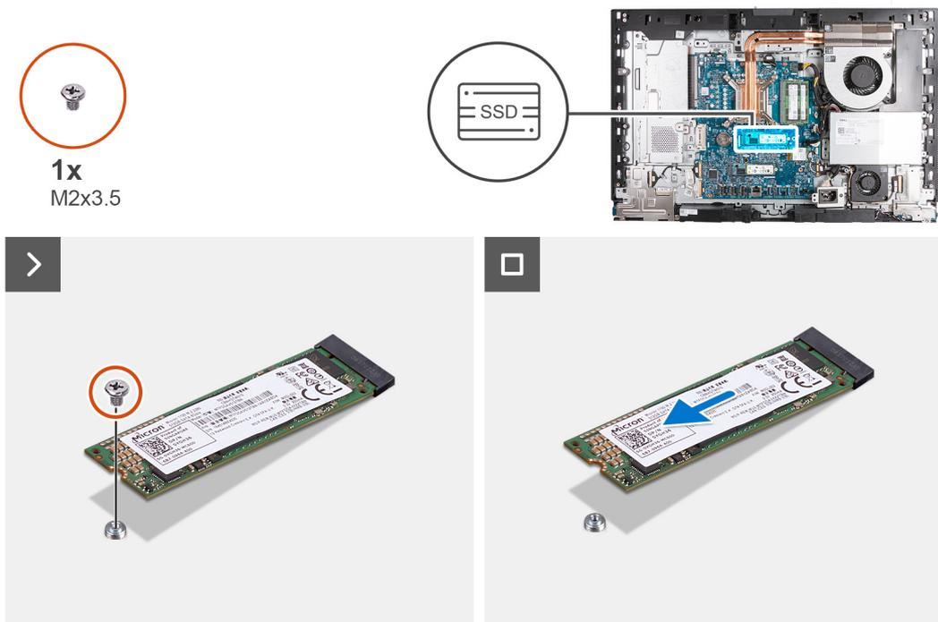
Abbildung 32. Entfernen des M.2 2280-SSD-Laufwerks aus M.2-Steckplatz 0
