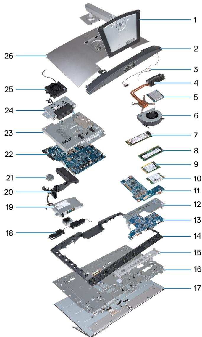
**Abbildung 16. Hauptkomponenten Ihres OptiPlex All-in-One 7420 mit einem Hochleistungsprozessor**
