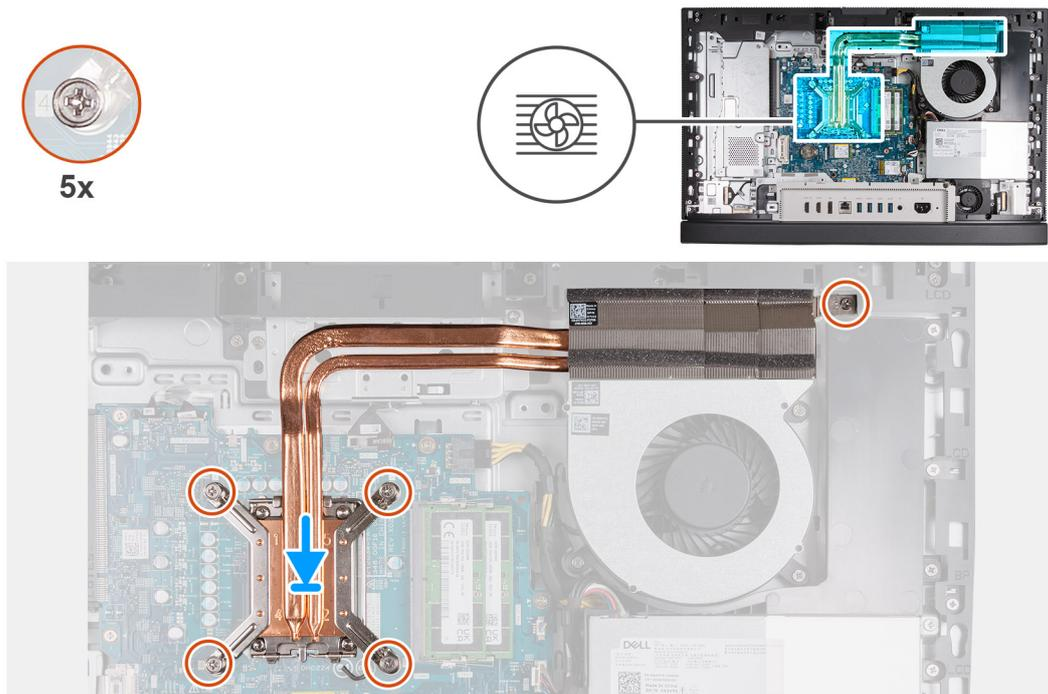
Abbildung 63. Einsetzen des Kühlkörpers
