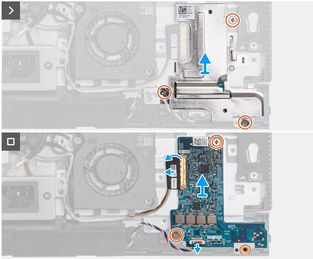
Abbildung 74. Entfernen der Audioplatine
