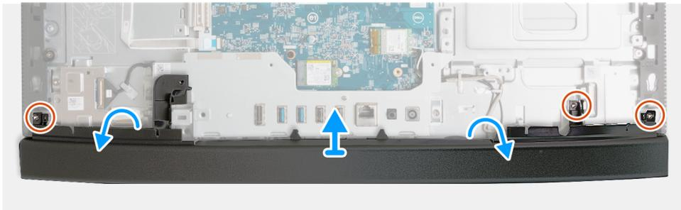
**Abbildung 99. Entfernen der unteren Abdeckung**
