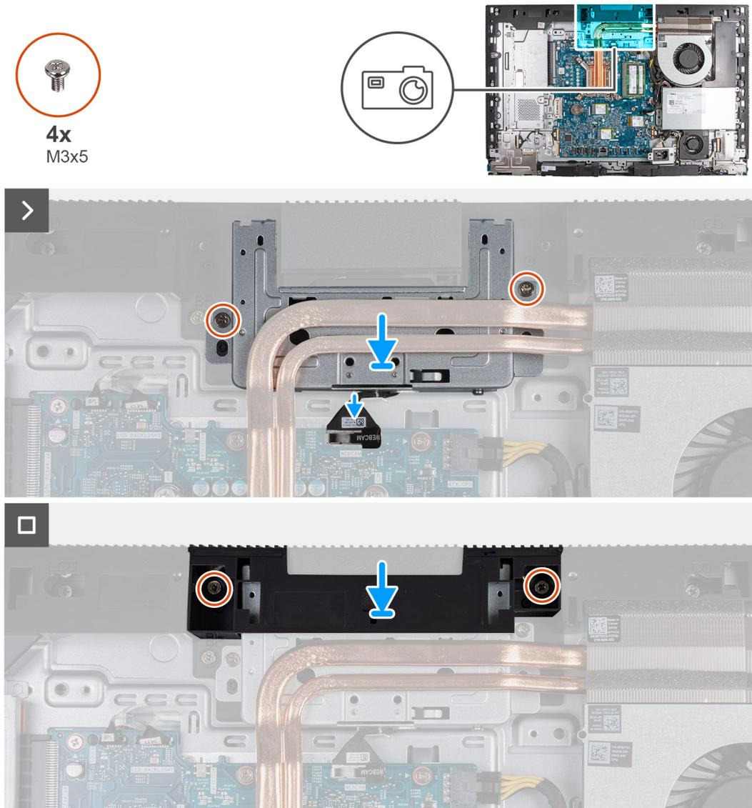
Abbildung 47. Installieren der einziehbaren Kamerabaugruppe
