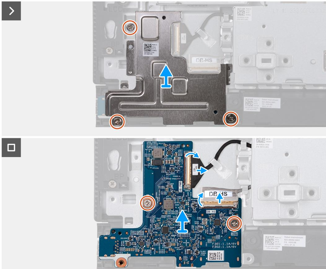
Abbildung 72. Entfernen des Netzschalters und der E/A-Platine
