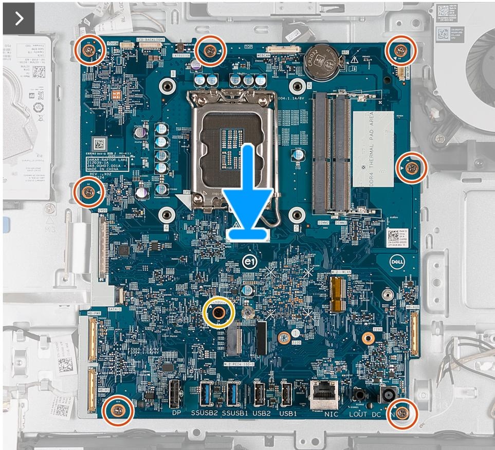
Abbildung 117. Einbauen der Systemplatine
