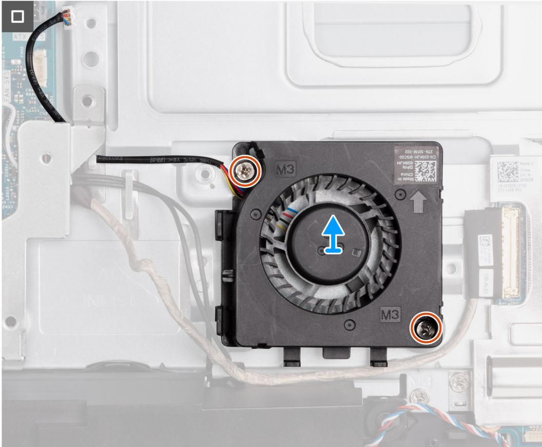
Abbildung 54. Entfernen des Netzteilüfters
