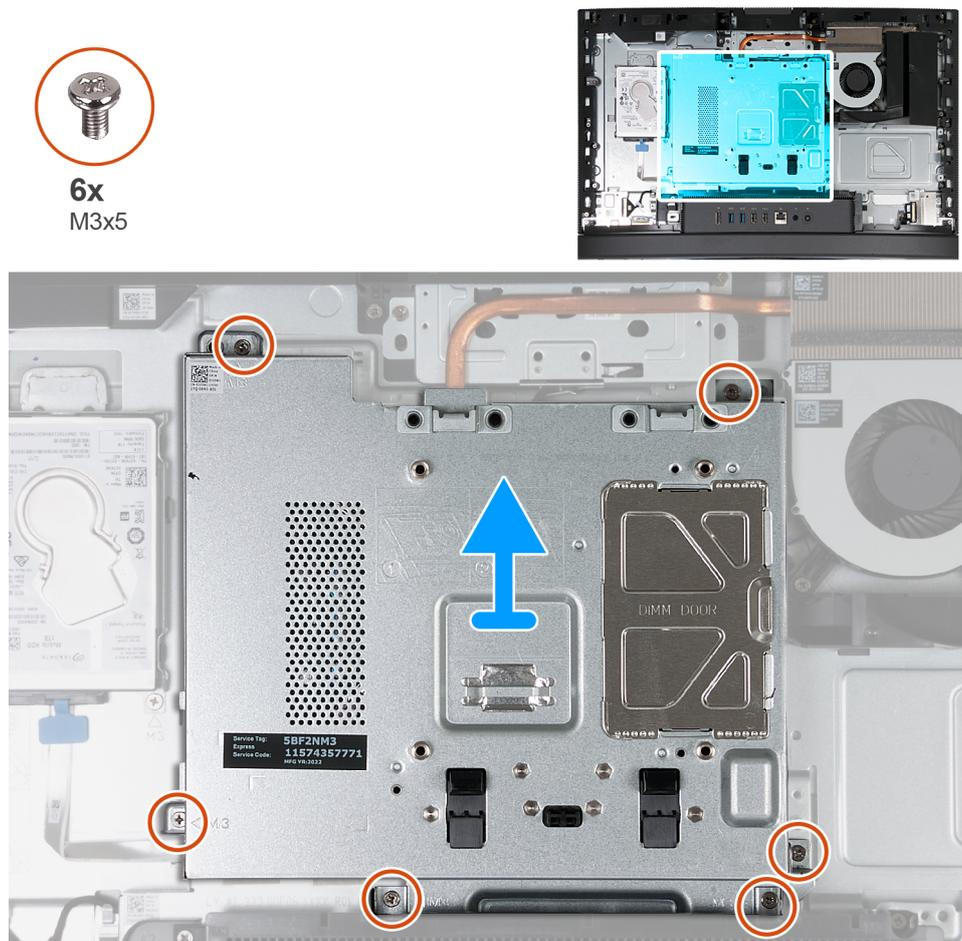
Abbildung 26. Entfernen der Abdeckung der Systemplatine
