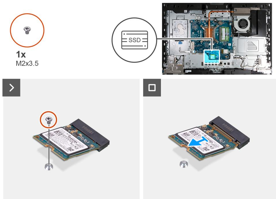
Abbildung 90. Entfernen des M.2-2230-Solid-State-Laufwerks
