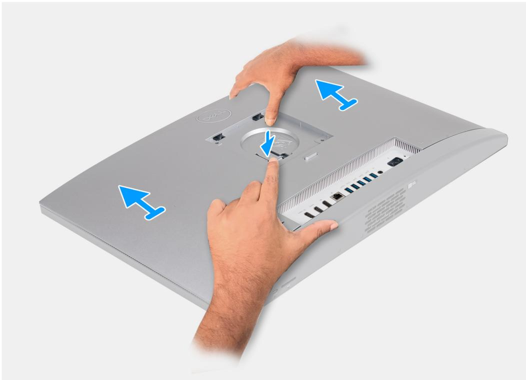
**Abbildung 22. Entfernen der rückseitigen Abdeckung**
