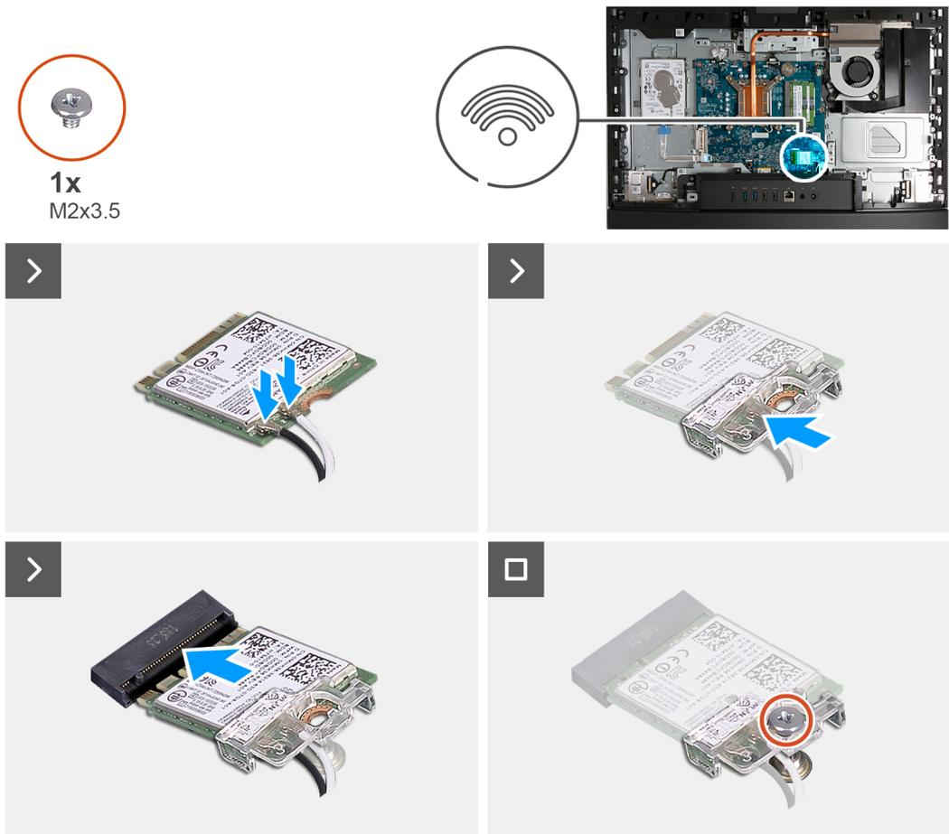
Abbildung 89. Einbauen der Wireless-Karte
