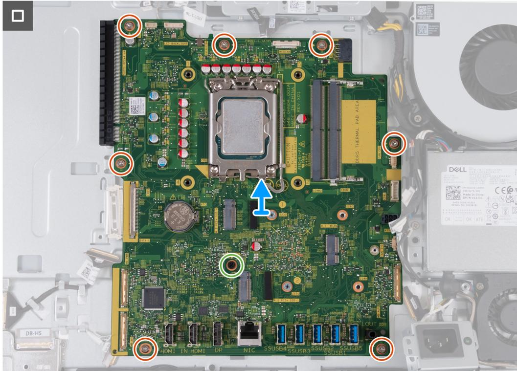
**Abbildung 68. Systemplatine entfernen**
