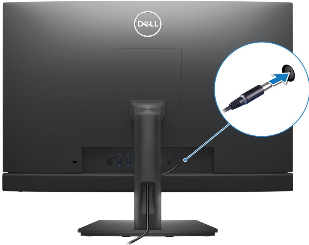
Abbildung 12. Anschließen des Netzadapterkabels
