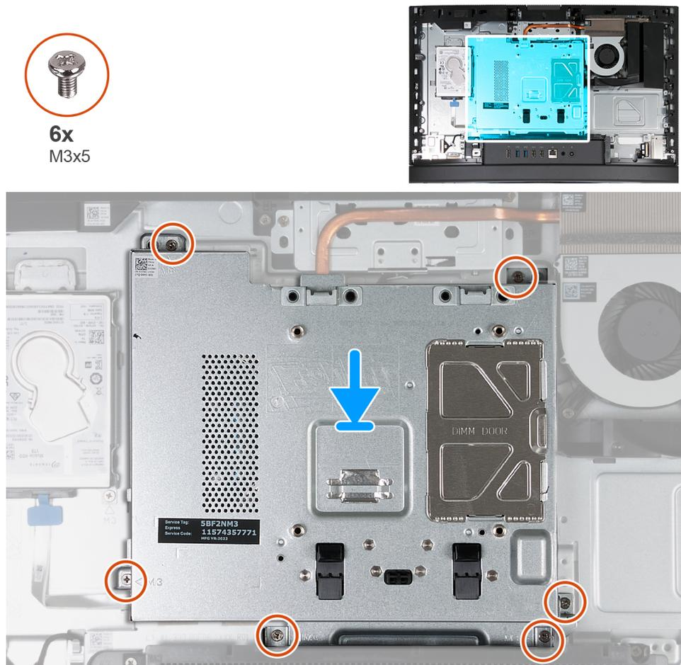
Abbildung 27. Einbauen der Abdeckung der Systemplatine
