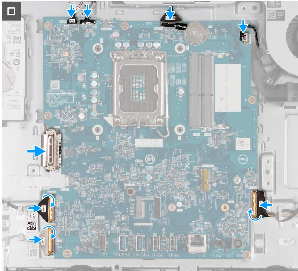
**Abbildung 118. Einbauen der Systemplatine**
