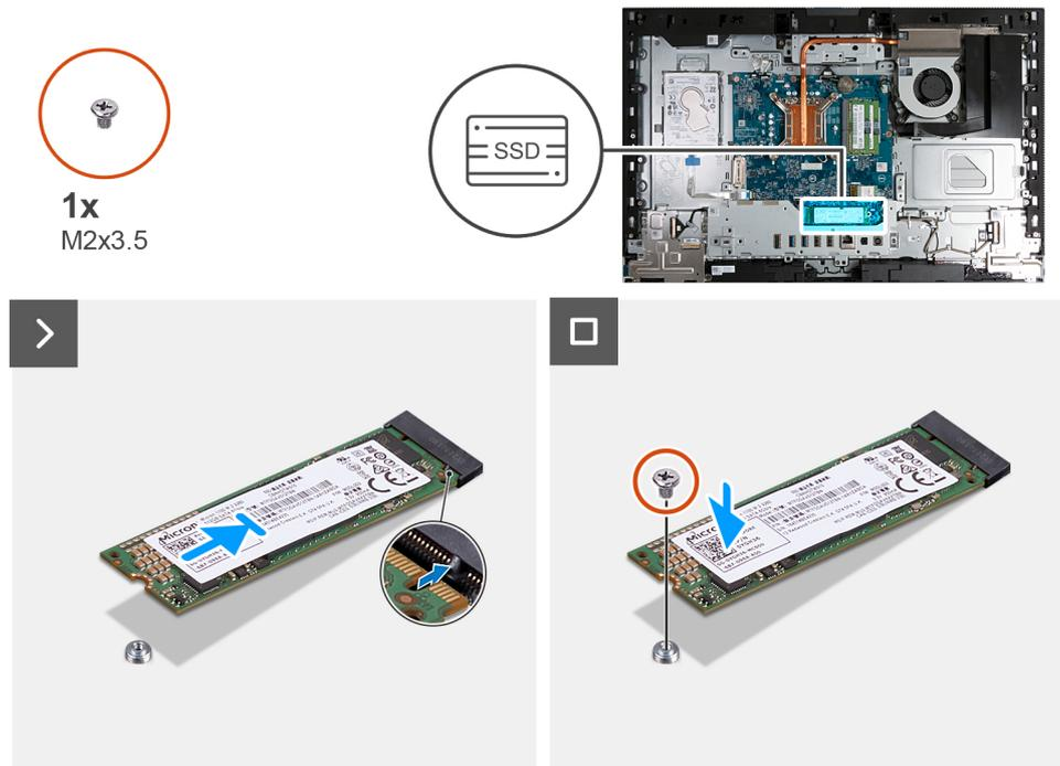
Abbildung 93. Einbauen des M.2-2280-Solid-State-Laufwerks
