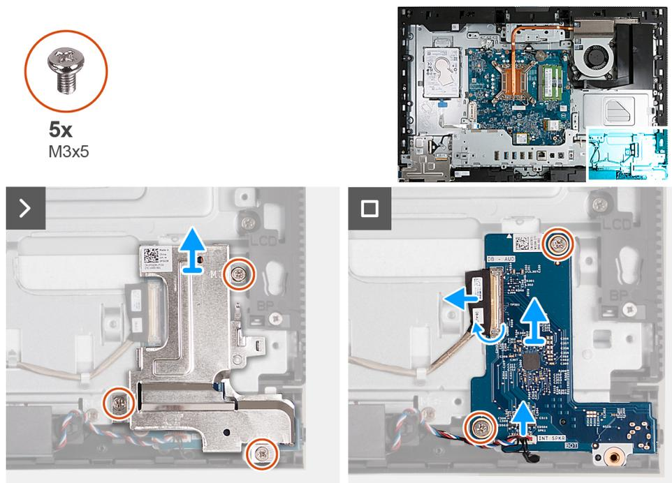
Abbildung 121. Entfernen der Audioplatine
