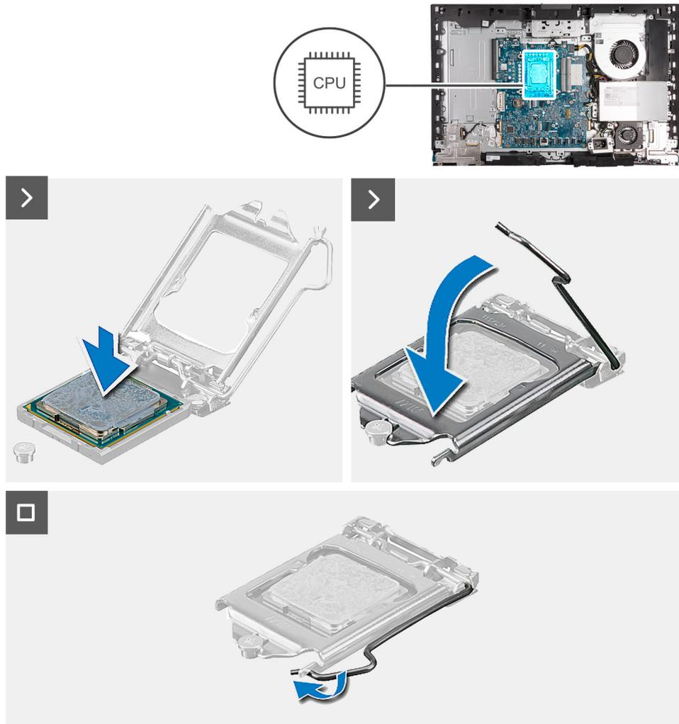
Abbildung 65. Einbauen des Prozessors
