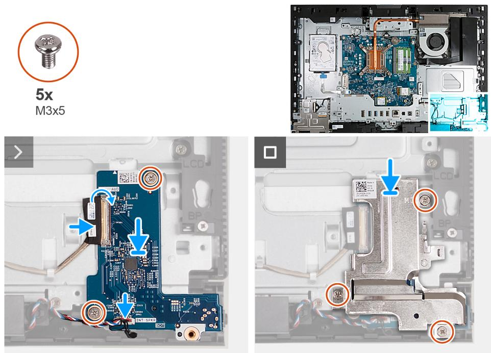
Abbildung 122. Einbauen der Audioplatine
