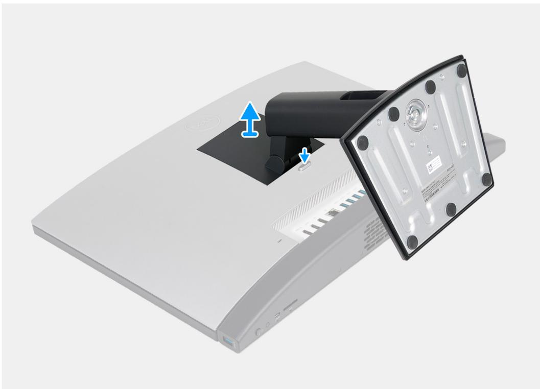
Abbildung 19. Entfernen des feststehenden Ständers
