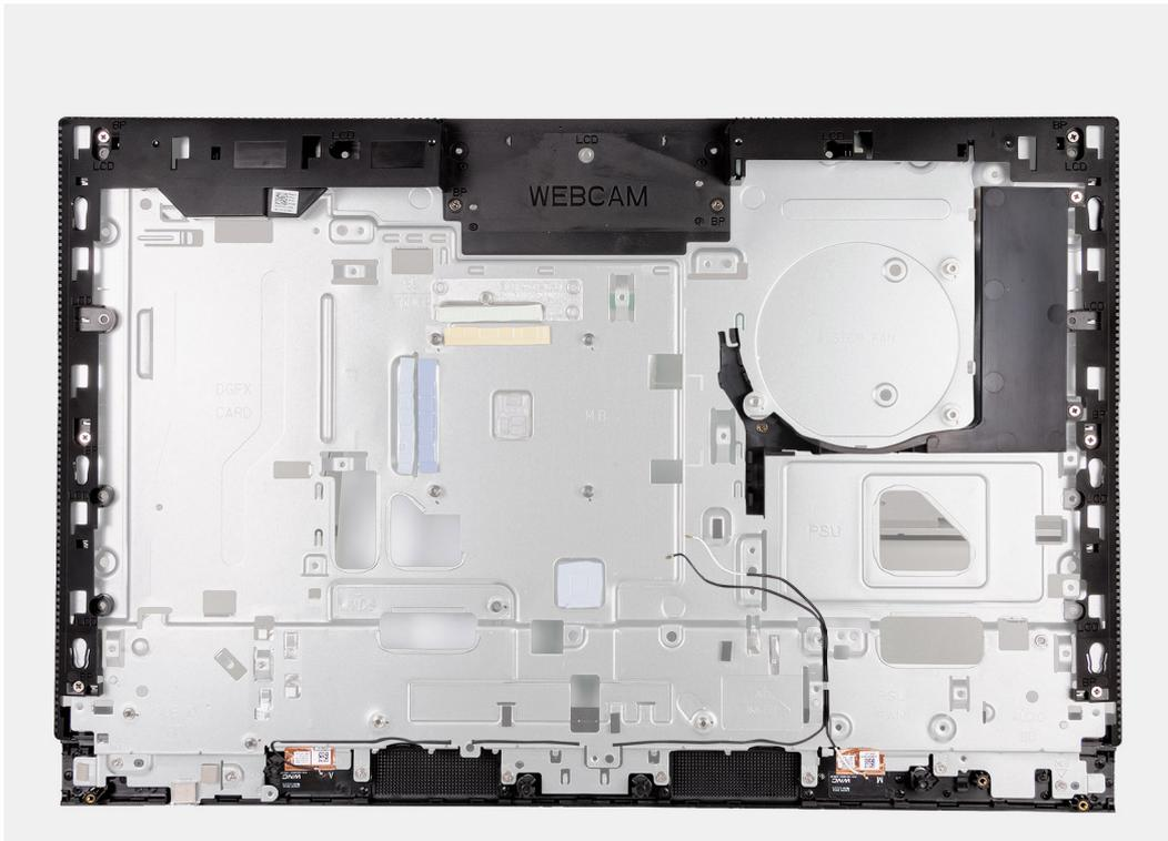
**Abbildung 77. Einbau der Grundplatte der Bildschirmbaugruppe**
