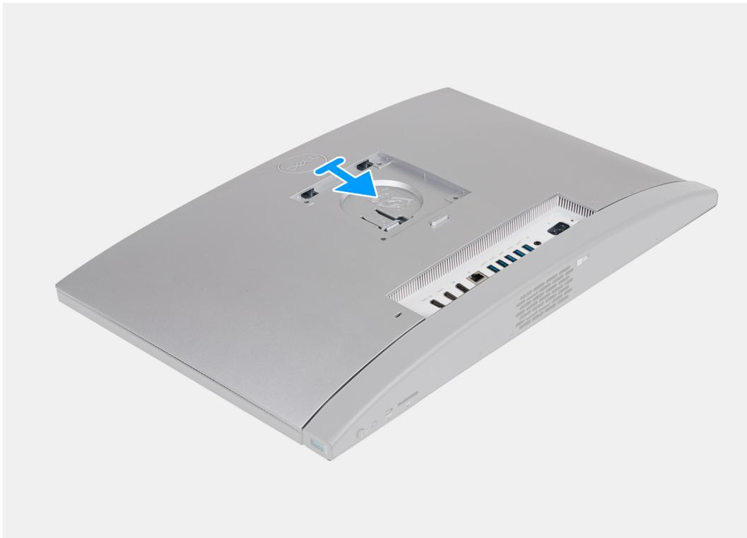
**Abbildung 23. Einbauen der rückseitigen Abdeckung**
