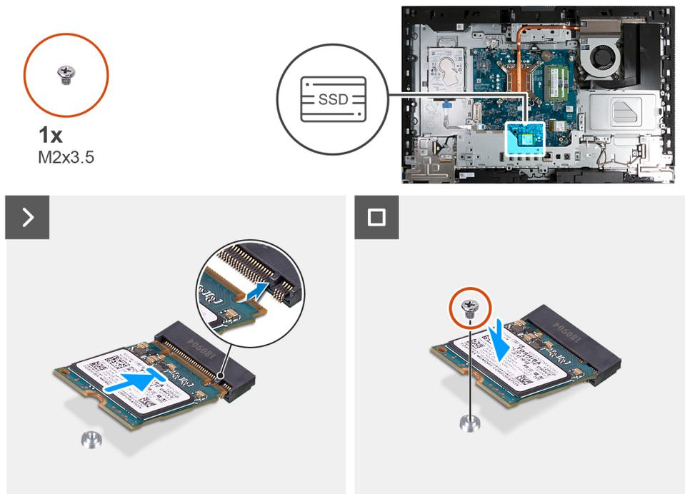
Abbildung 91. Installieren des M.2-2230-Solid-State-Laufwerks
