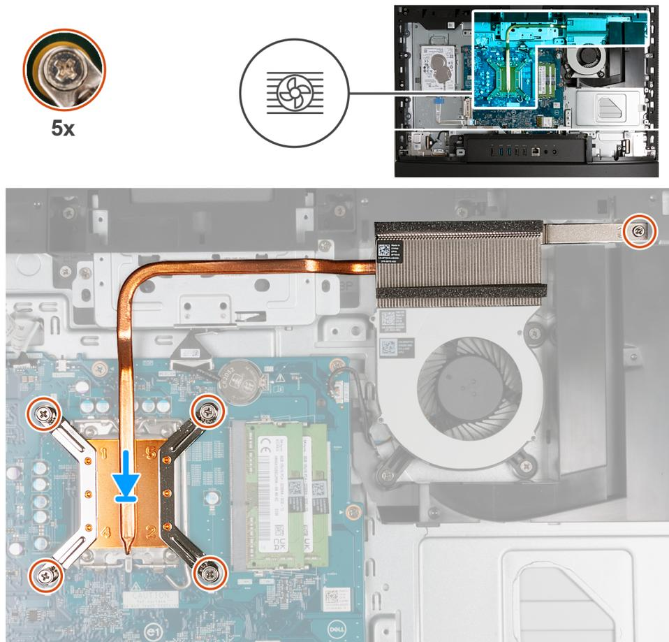
Abbildung 110. Einsetzen des Kühlkörpers
