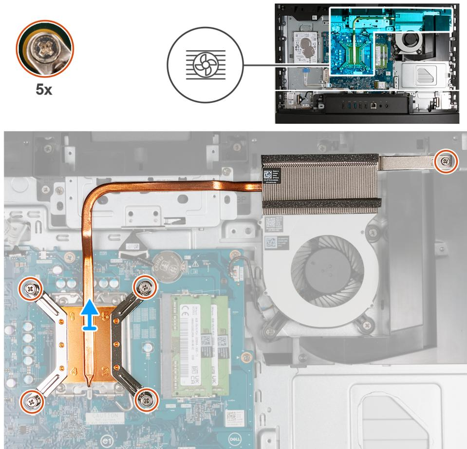
Abbildung 109. Kühlkörper entfernen
