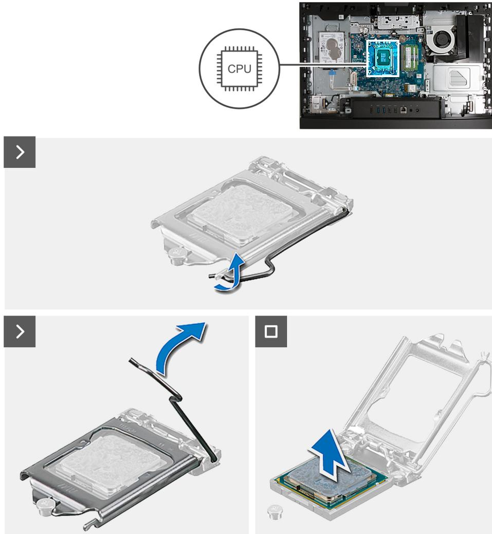
Abbildung 111. Entfernen des Prozessors
