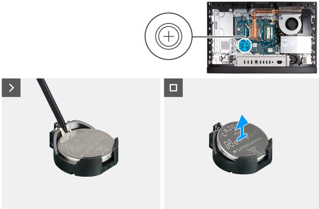
Abbildung 40. Entfernen der Knopfzellenbatterie
