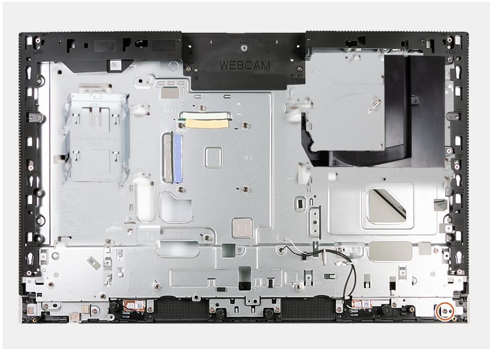
Abbildung 123. Entfernen der Grundplatte der Bildschirmbaugruppe
