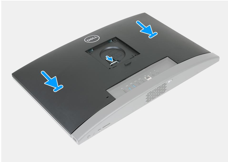
**Abbildung 83. Einbauen der rückseitigen Abdeckung**
