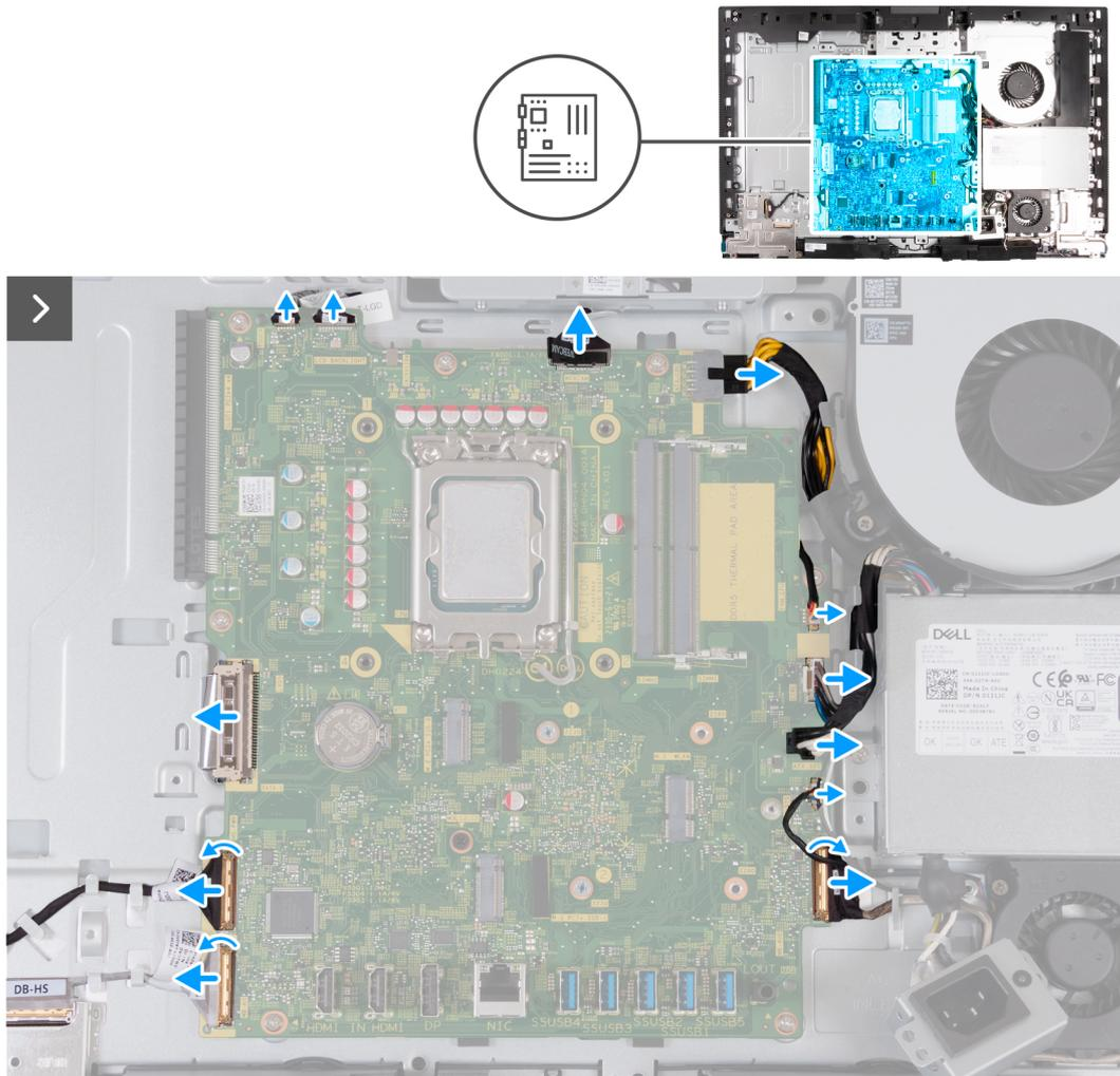
Abbildung 67. Systemplatine entfernen
