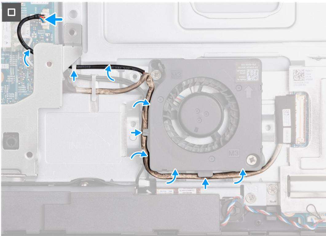
Abbildung 57. Einbauen des Netzteil Lüfters
