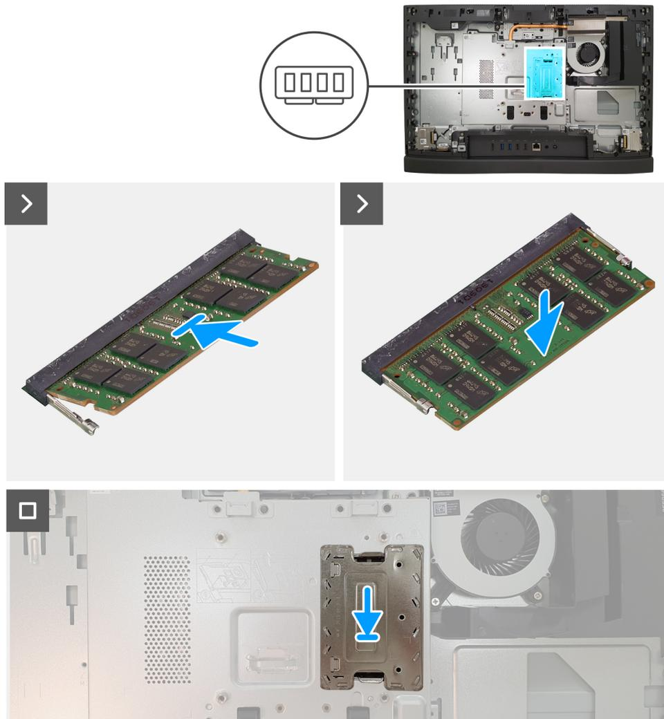
**Abbildung 85. Installieren des Speichers**
