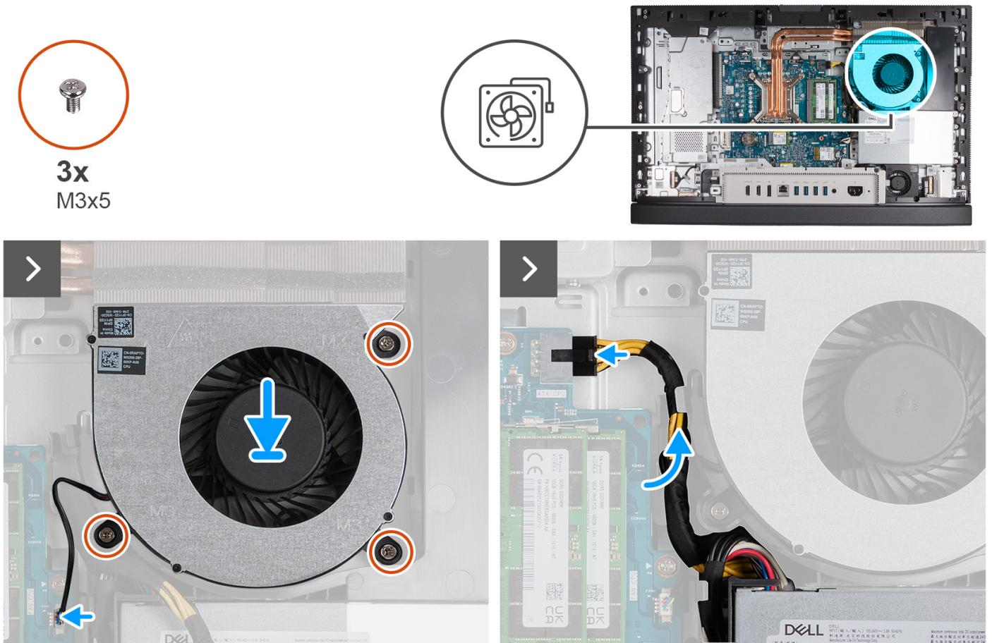
Abbildung 49. Einbauen des Lüfters
