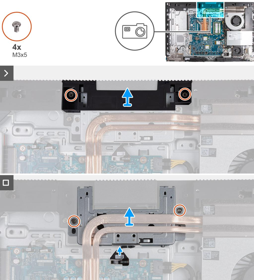
**Abbildung 46. Entfernen der einziehbaren Kamerabaugruppe**
