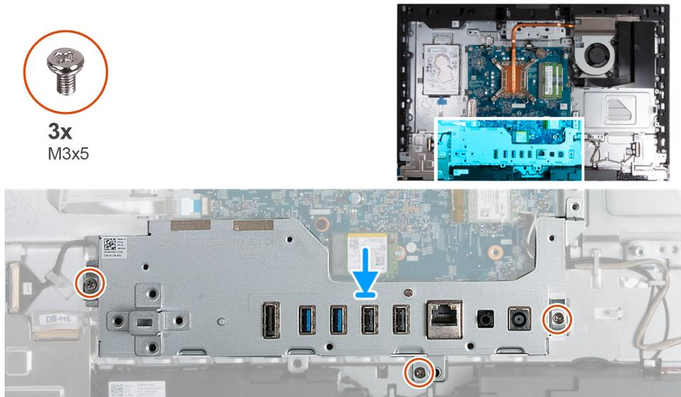
Abbildung 106. Einbauen der E/A-Halterung
