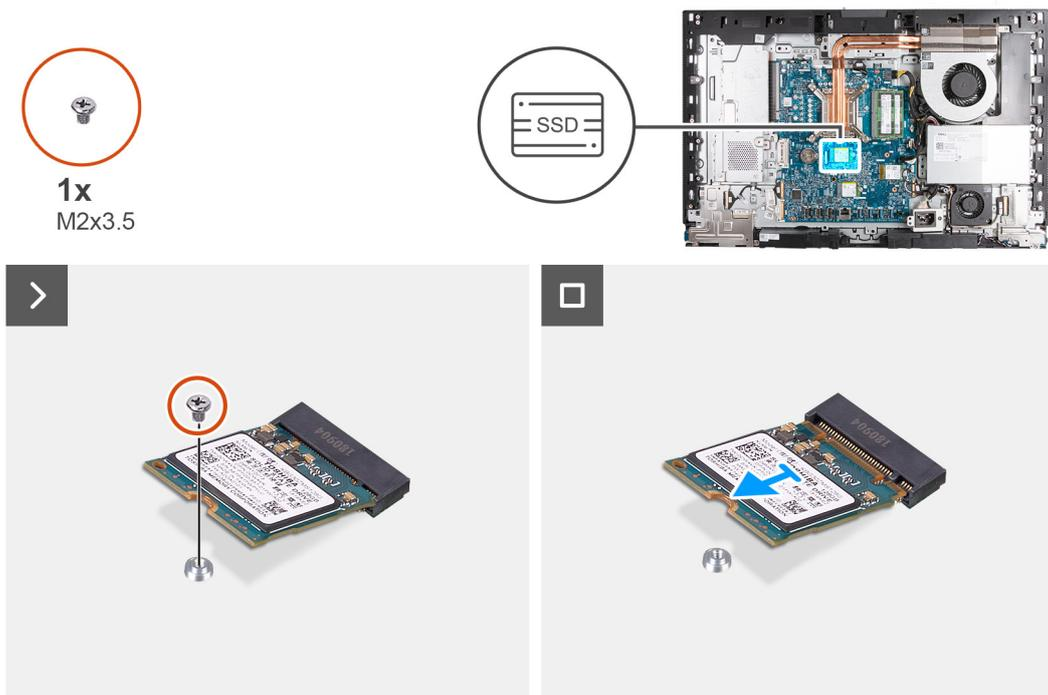
Abbildung 30. Entfernen des M.2 2230-SSD-Laufwerks aus M.2-Steckplatz 0
