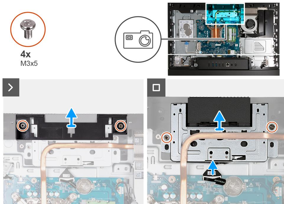
Abbildung 101. Entfernen der einziehbaren Kamerabaugruppe
