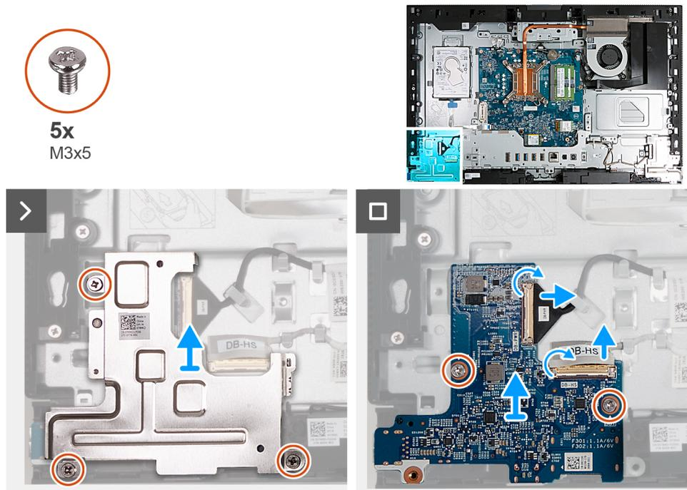
Abbildung 119. Entfernen des Netzschalters und der E/A-Platine
