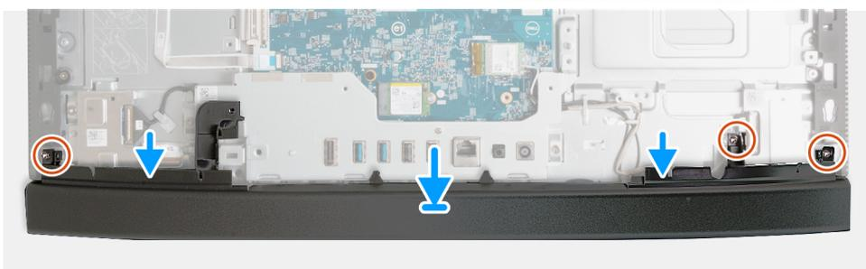
**Abbildung 100. Anbringen der unteren Abdeckung**
