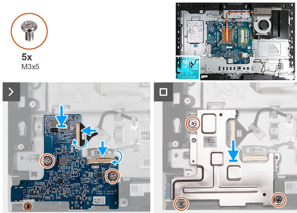
Abbildung 120. Einbauen der Netzschalter- und E/A-Platine
