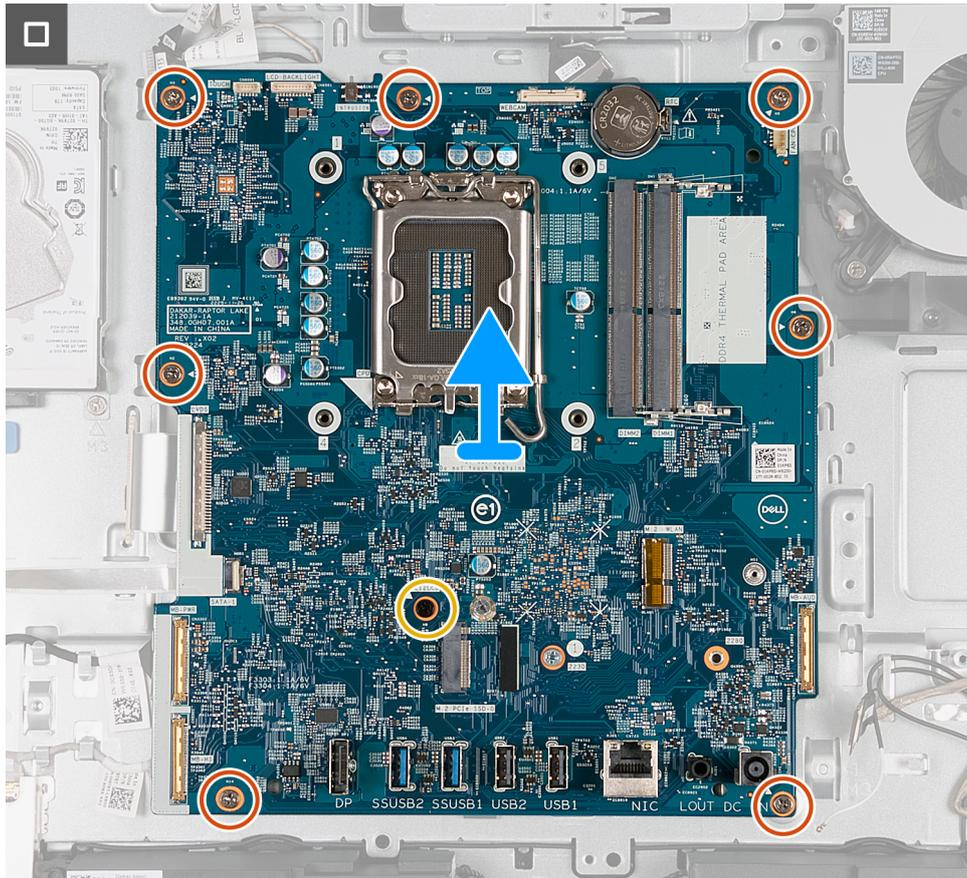
Abbildung 115. Systemplatine entfernen
