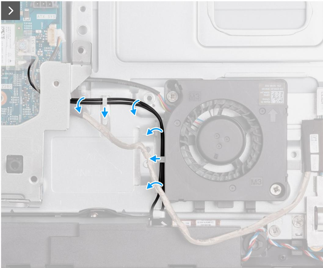
Abbildung 53. Entfernen des Netzteilüfters
