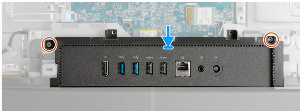
Abbildung 98. Installieren der E/A-Abdeckung
