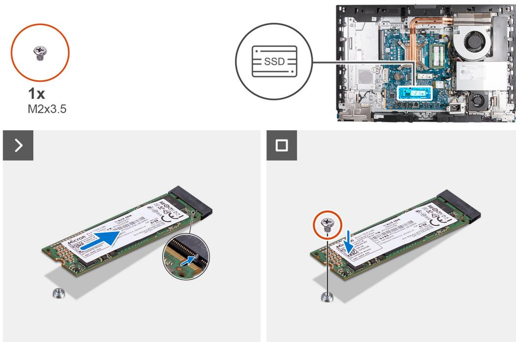
**Abbildung 38. Installieren des M.2 2280-SSD-Laufwerks in M.2-Steckplatz 1**
