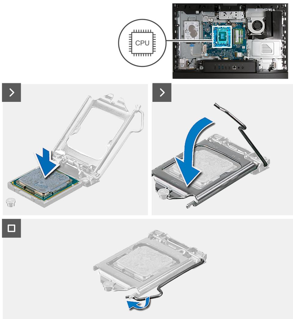
Abbildung 112. Einbauen des Prozessors
