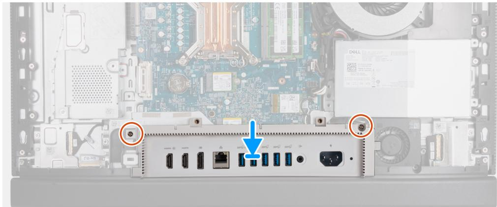
Abbildung 43. Einbauen der E/A-Abdeckung
