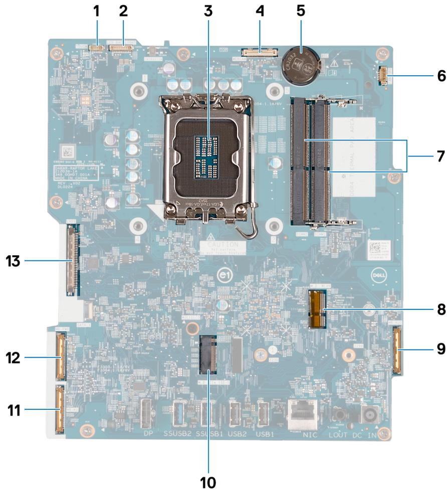
**Abbildung 113. Systemplatinenbeschriftung**
