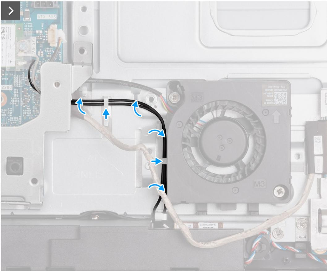
Abbildung 56. Einbauen des Netzteil Lüfters
