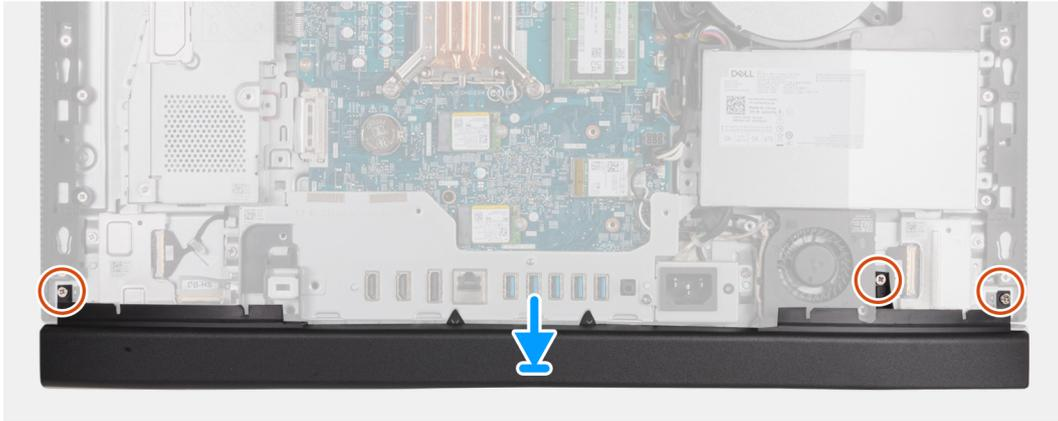
**Abbildung 45. Anbringen der unteren Abdeckung**
