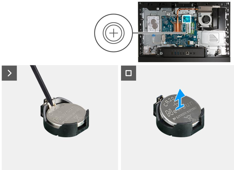
Abbildung 95. Entfernen der Knopfzellenbatterie
