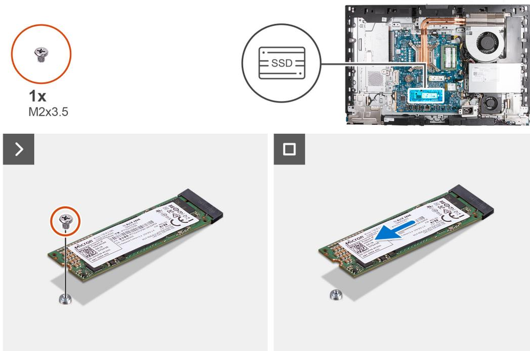
Abbildung 37. Entfernen des M.2 2280-SSD-Laufwerks aus M.2-Steckplatz 1
