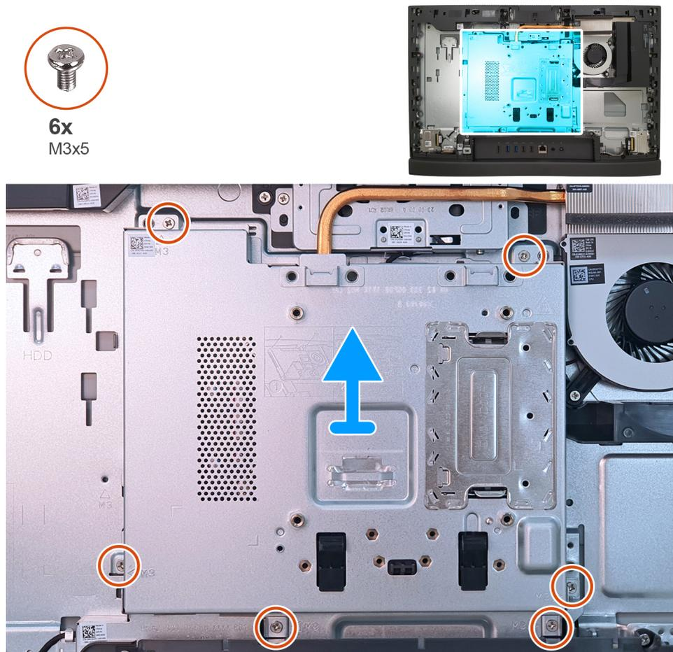
Abbildung 86. Entfernen der Abdeckung der Systemplatine
