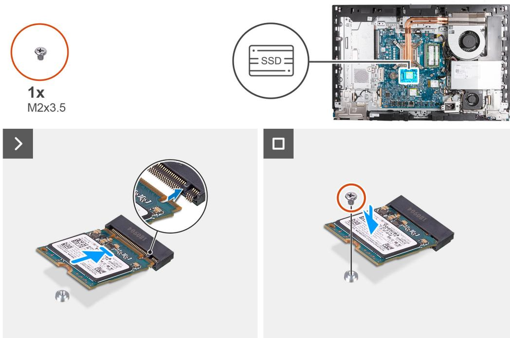
**Abbildung 31. Installieren des M.2 2230-SSD-Laufwerks in M.2-Steckplatz 0**
