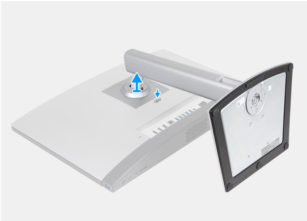
Abbildung 18. Entfernen des höhenverstellbaren Ständers (HAS)
