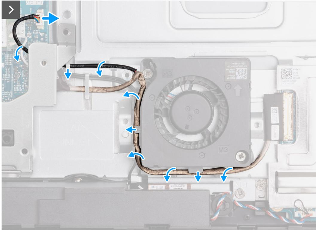
Abbildung 52. Entfernen des Netzteilüfters
