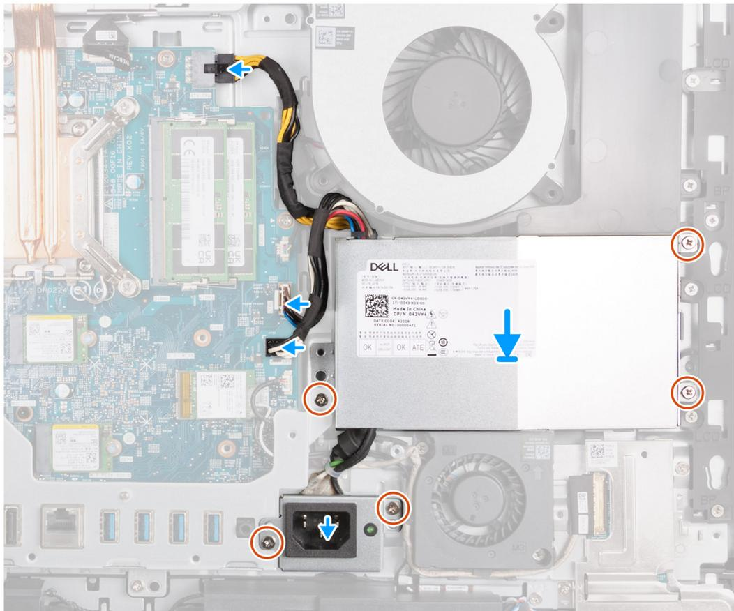
Abbildung 51. Installieren der Stromversorgungseinheit
