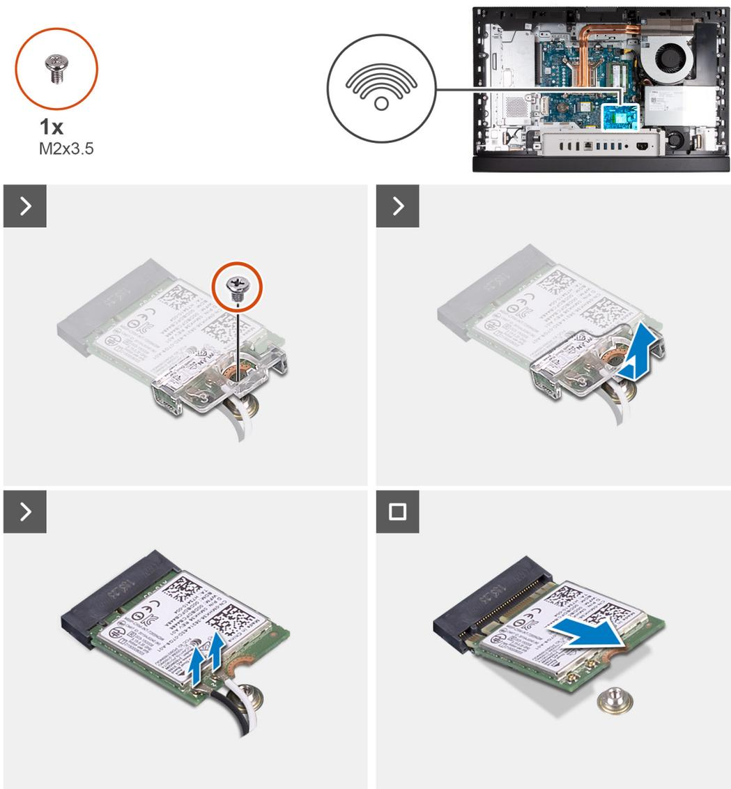
Abbildung 28. Entfernen der Wireless-Karte
