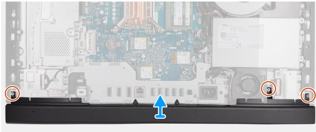
**Abbildung 44. Entfernen der unteren Abdeckung**
