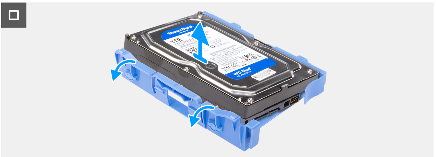
Afbeelding 9. De 3,5 inch harde schijf verwijderen
