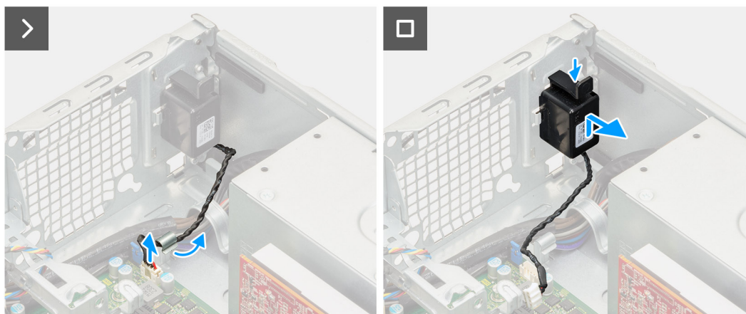
Afbeelding 35. De luidspreker verwijderen
