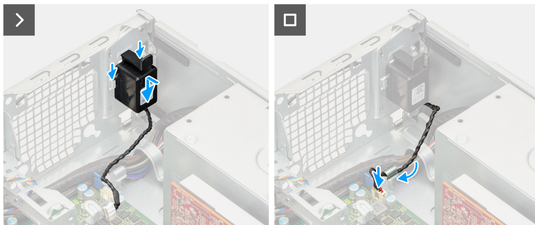
Afbeelding 36. De luidspreker plaatsen
