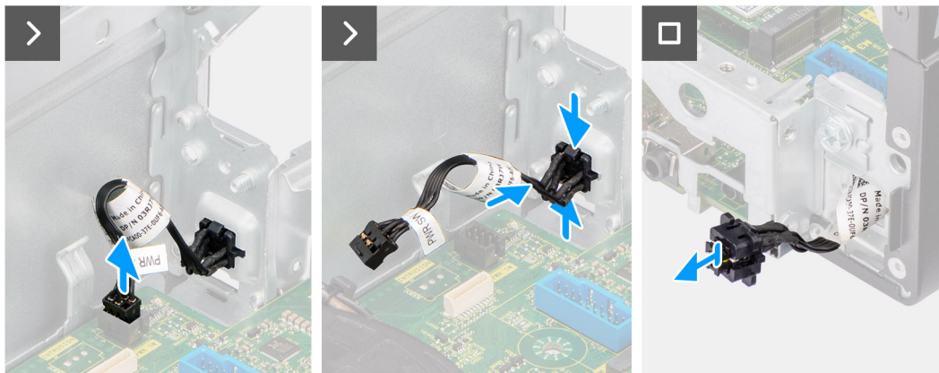
Afbeelding 39. De aan/uit-knop verwijderen
