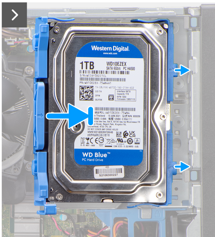
Figure 10. Installation du disque dur de 3,5 pouces
