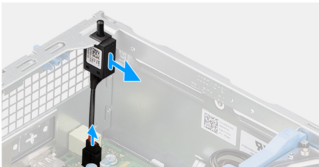
Figure 37. Retrait du commutateur d'intrusion
