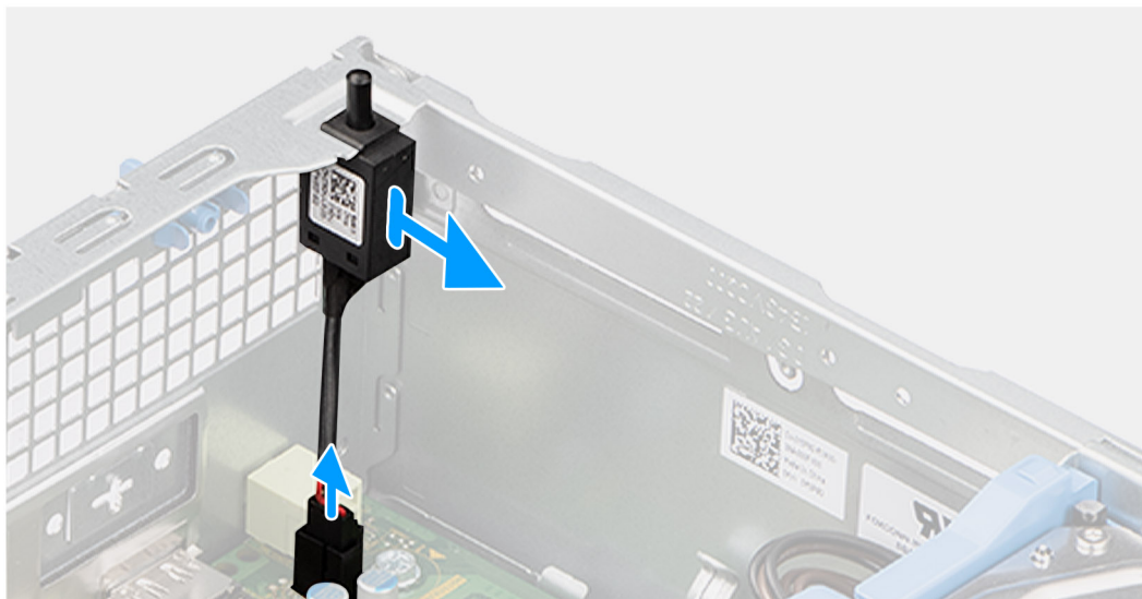
Abbildung 37. Entfernen des Eingriffsschalters
