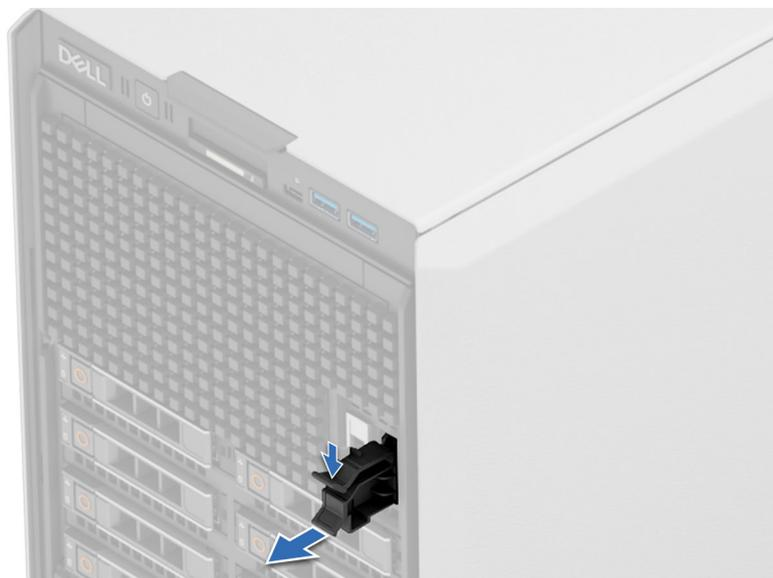
**Abbildung 198. Entfernen des Platzhalters für das BOSS-N1-Modul**
