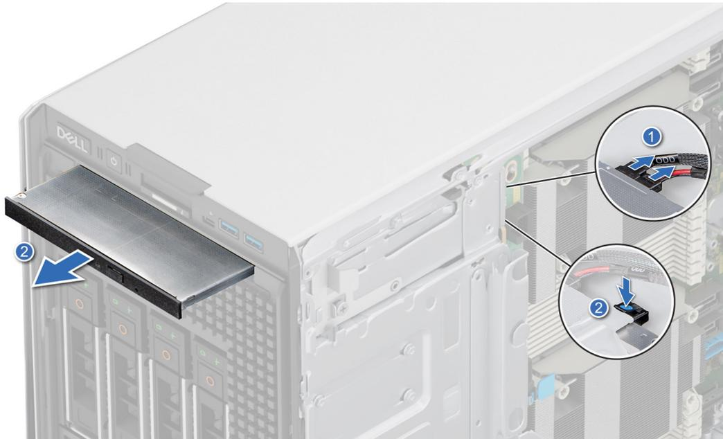
Abbildung 127. Entfernen des optischen Laufwerks
