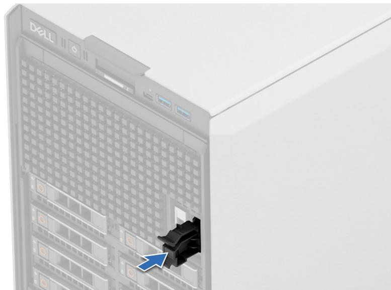
**Abbildung 144. Installieren des Platzhalters für den BOSS-N1-Kartenträger**
