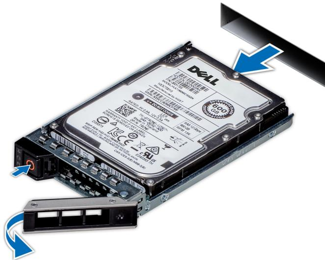
Abbildung 102. Entfernen eines Laufwerkträgers
