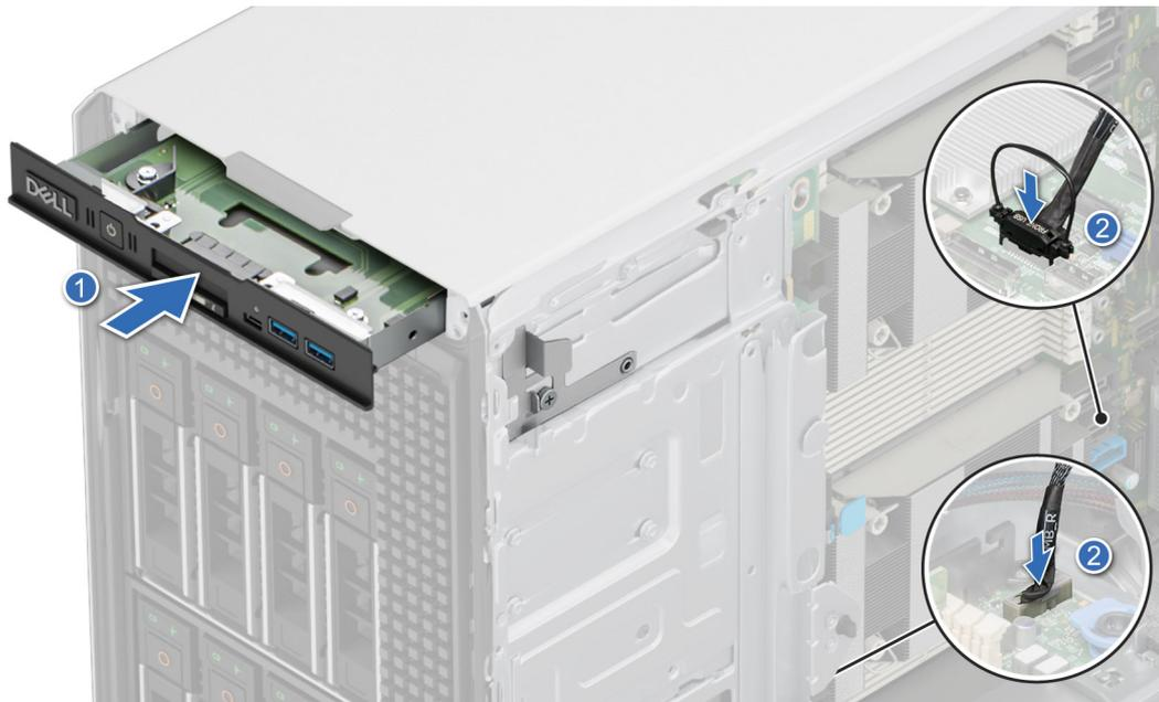
**Abbildung 134. Installieren des vorderen I/O-Moduls**
