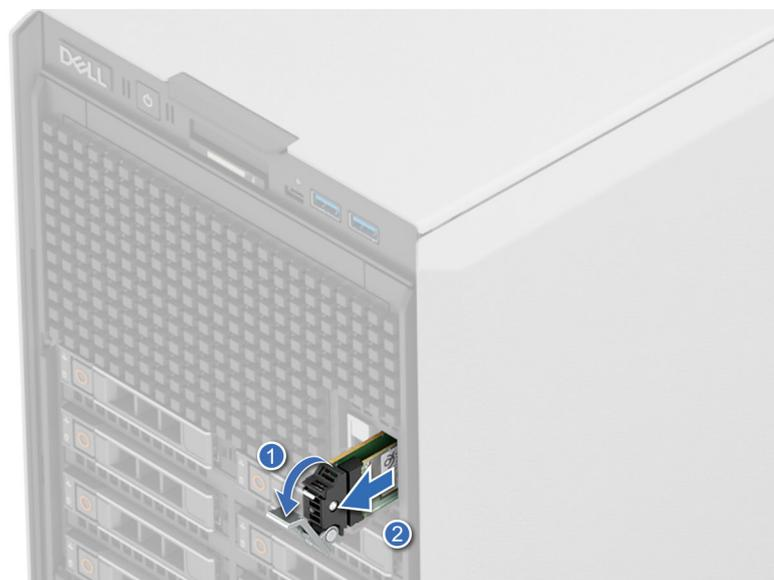
Abbildung 142. Entfernen des BOSS-N1-Kartenträgers
