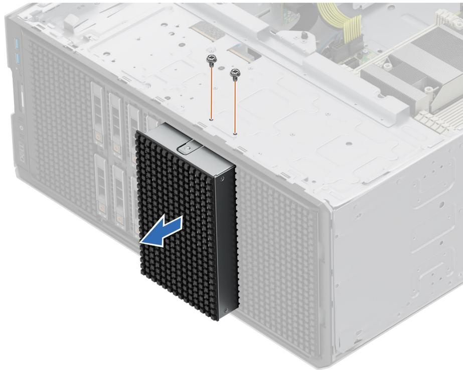
Abbildung 113. Entfernen des Laufwerksschacht-Platzhalters
