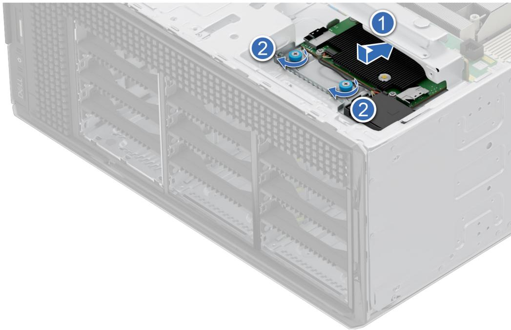
Abbildung 98. Installieren des fPERC-Moduls in der 3,5"-Laufwerkrückwandplatine
