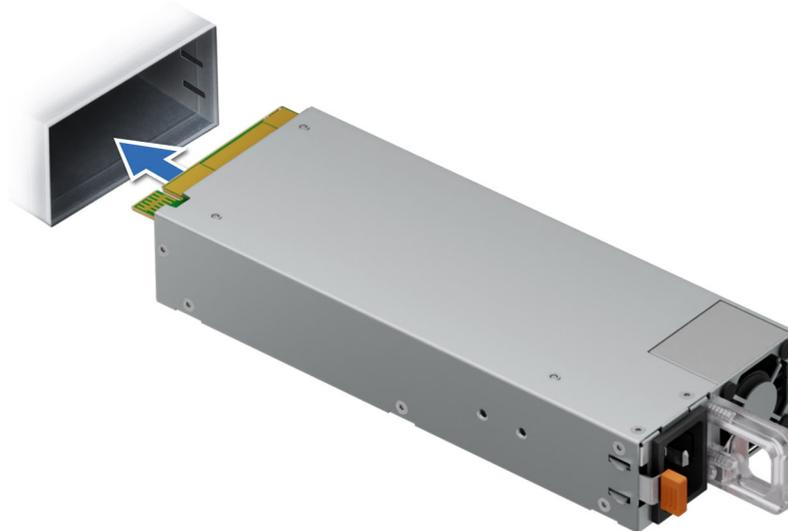
Abbildung 191. Installieren eines 86-mm-Netzteils
