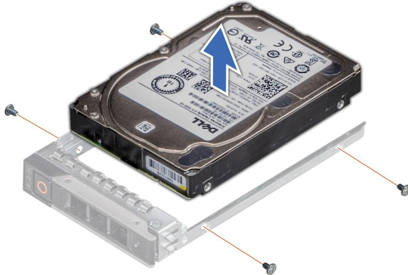
Abbildung 105. Entfernen des Laufwerks aus dem Laufwerkträger
