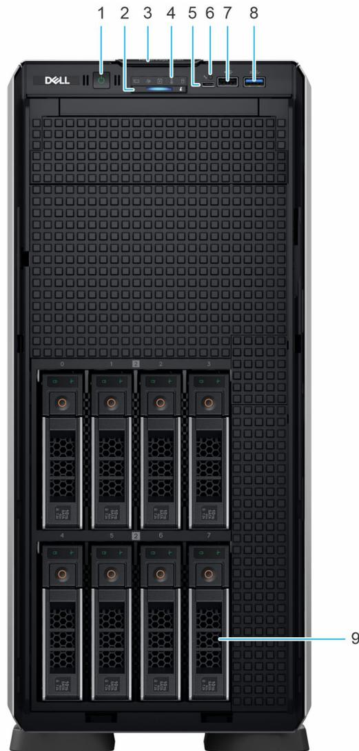
Abbildung 5. Vorderansicht eines Systems mit 8 x 3,5-Zoll-Laufwerken
