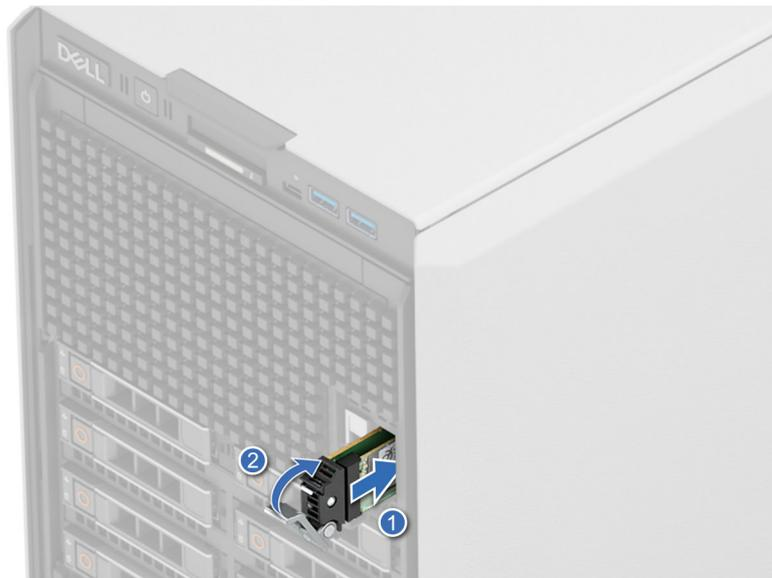
Abbildung 147. Installieren des BOSS-N1-Kartenträgers
