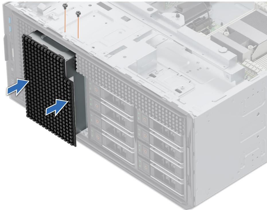
**Abbildung 118. Installieren des NVMe-Laufwerksschacht-Platzhalters**
