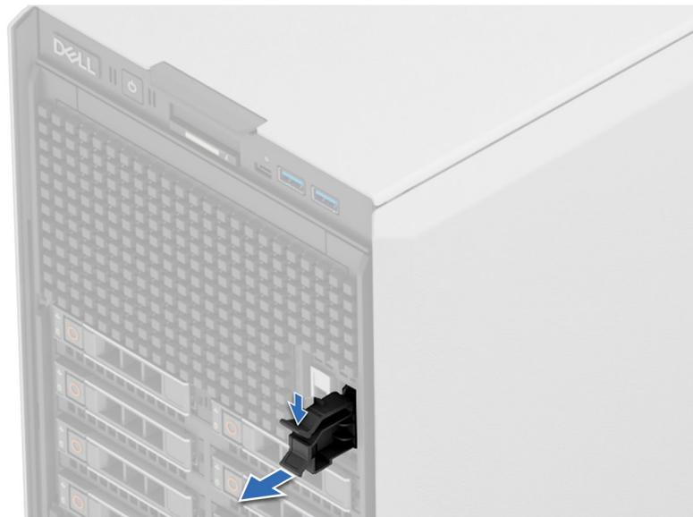
**Abbildung 145. Entfernen des Platzhalters für den BOSS-N1-Kartenträger**
