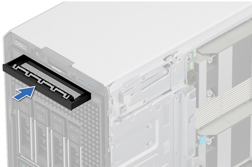
Abbildung 126. Installieren des Platzhalters für das optische Laufwerk
