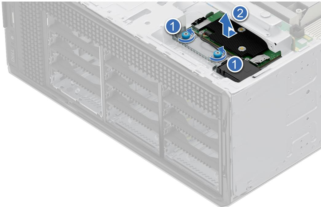
Abbildung 96. Entfernen des fPERC-Moduls von der 3,5"-Laufwerkrückwandplatine
