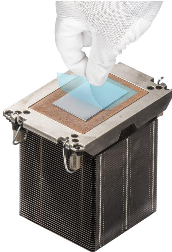
**Abbildung 168. Entfernen der TIM-Schutzfolie (Thermal Interface Material)**
