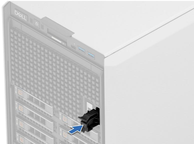
**Abbildung 199. Installieren des Platzhalters für das BOSS-N1-Modul**
