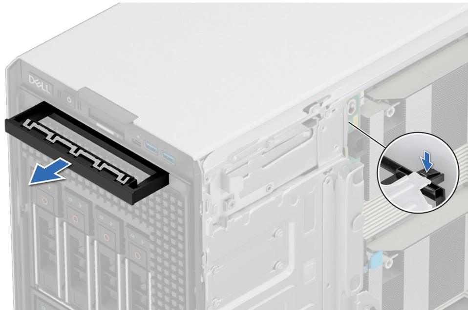
Abbildung 125. Entfernen des Platzhalters für das optische Laufwerk
