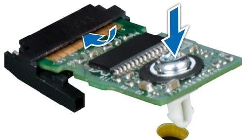
**Ilustración 126. Instalación del TPM**
