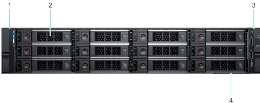
**Ilustración 2. Vista frontal del sistema de unidades de 12 x 3,5 pulgadas**
