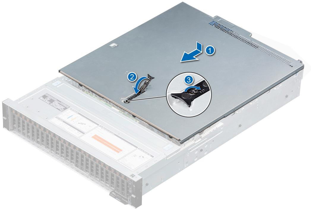
**Ilustración 20. Instalación de la cubierta del sistema**
