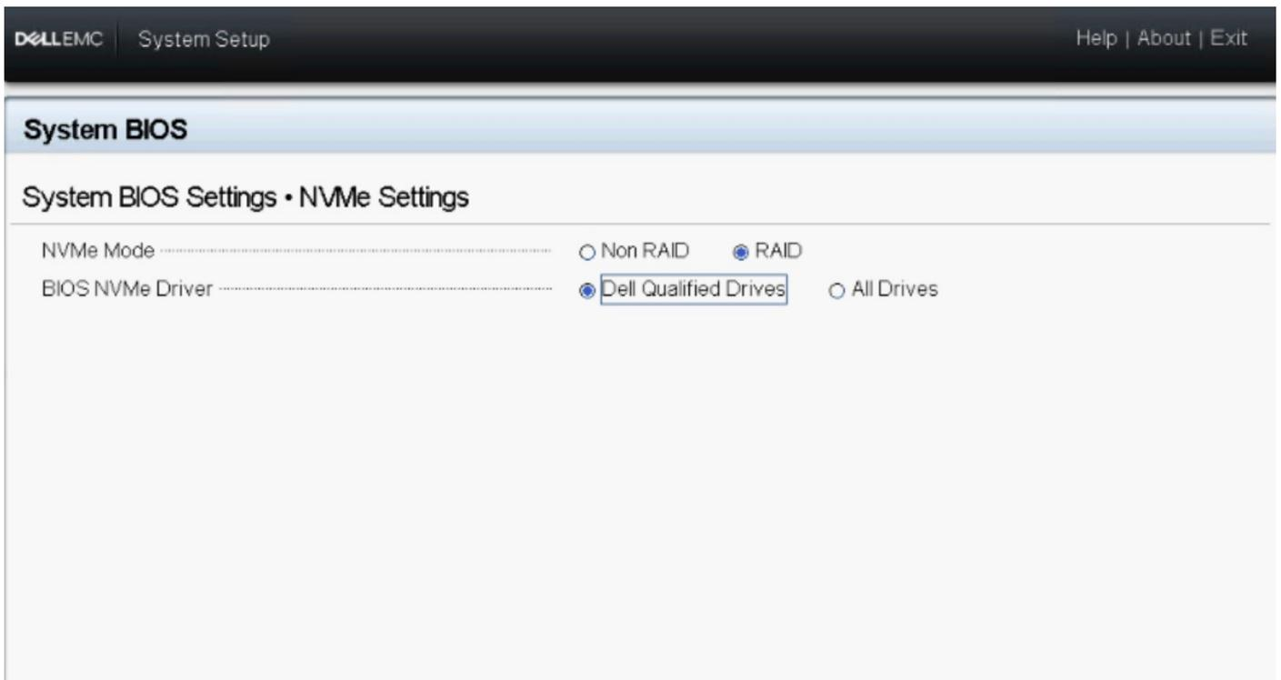
Figure 7. Paramètres NVMe dans le BIOS
