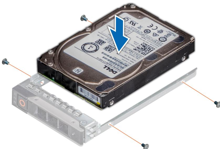
Figure 69. Installation d'un disque dans un support de disque
