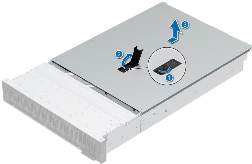
Figure 31. Retrait du capot du système
