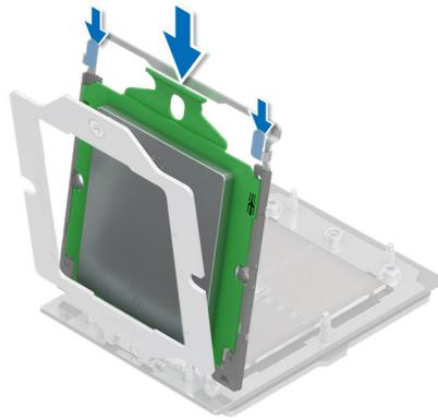
**Figure 150. Positionnement du cadre porteur dans le cadre à glissière**
