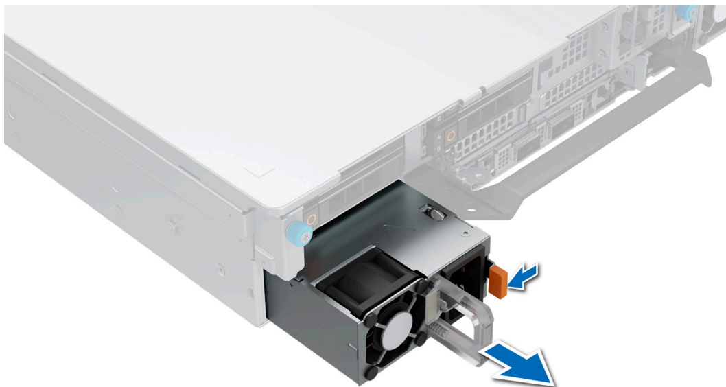
Ilustración 239. Extracción de una fuente de alimentación
