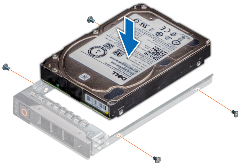
Ilustración 69. Instalación de una unidad en el portaunidades
