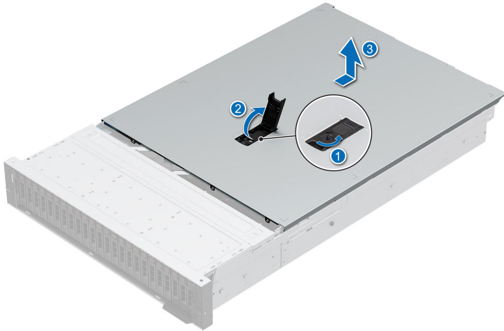
Abbildung 31. Systemabdeckung entfernen
