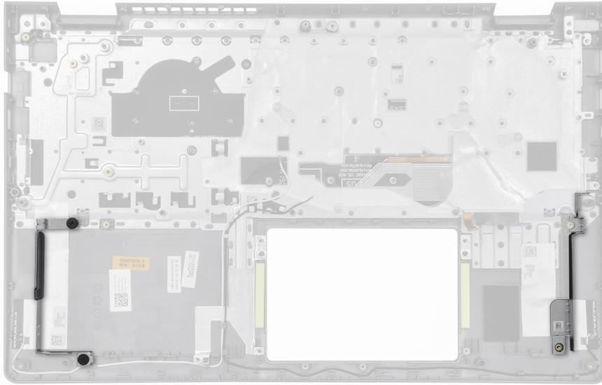
2. Para computadoras enviadas con chasis de aluminio, quite los soportes de pared metálicos de RF izquierdo y derecho del ensamblaje del teclado y del reposamanos.
