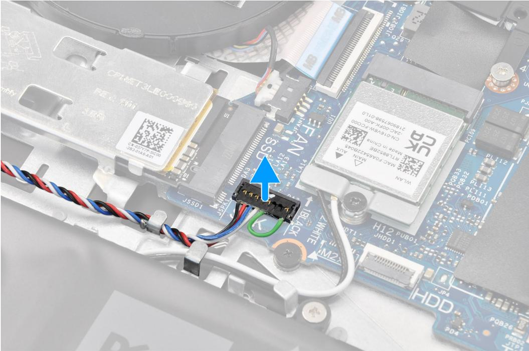
2. Saque y quite el cable de los parlantes de las guías de enrutamiento en el ensamblaje del teclado y del reposamanos.
