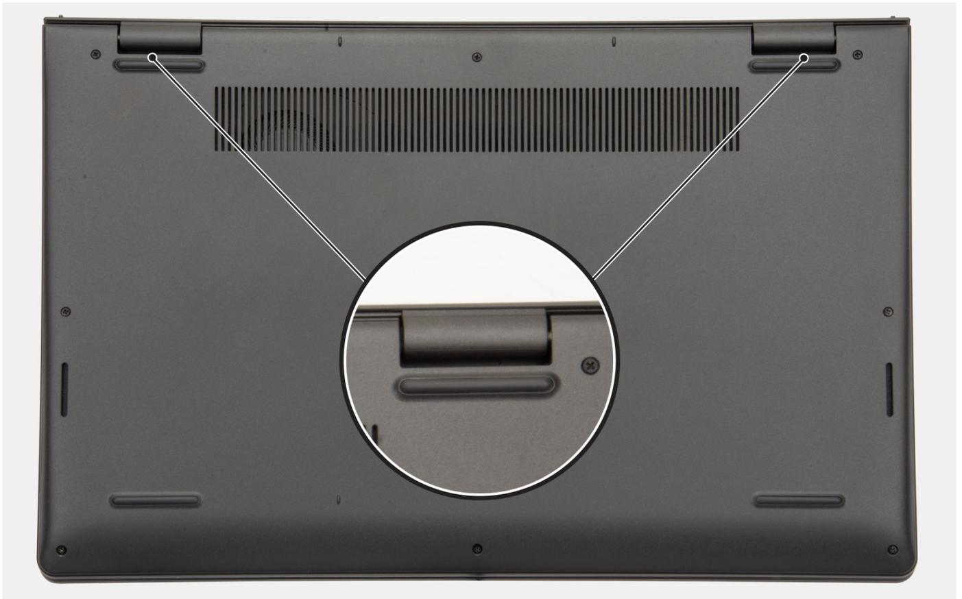
3. Haga palanca para abrir la parte superior de la cubierta de la base y continúe trabajando en los lados izquierdo y derecho para abrir la cubierta de la base.
