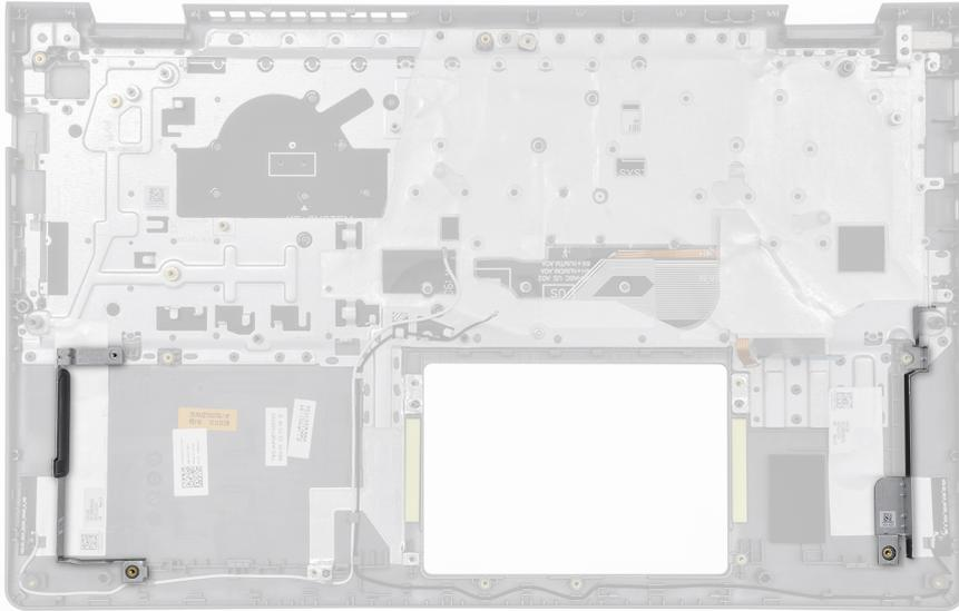
3. Para computadoras enviadas con un chasis de aluminio y una batería de 4 celdas instalada, coloque los dos tornillos (M2x2) para fijar el soporte de pared metálico de RF izquierdo al ensamblaje del teclado y del reposamanos.
