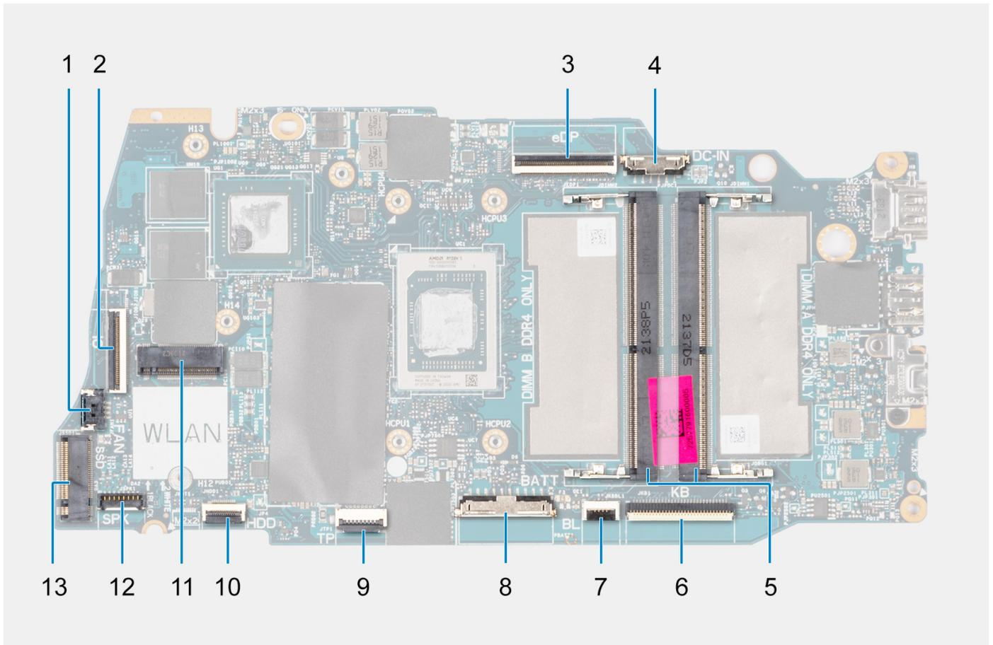
1. Conector del cable del ventilador
