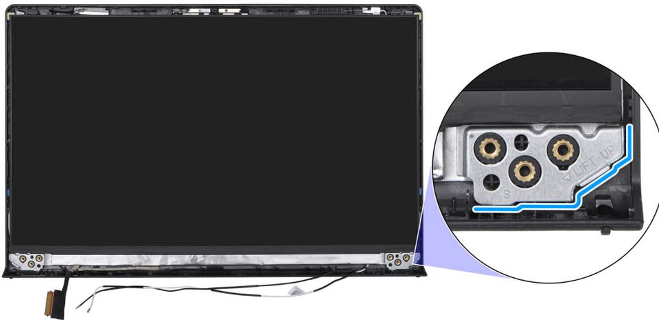
2. Utilice las manos para hacer palanca en el panel de pantalla desde las pestañas a lo largo del lateral derecho del ensamblaje de la antena y la cubierta posterior de la pantalla.
