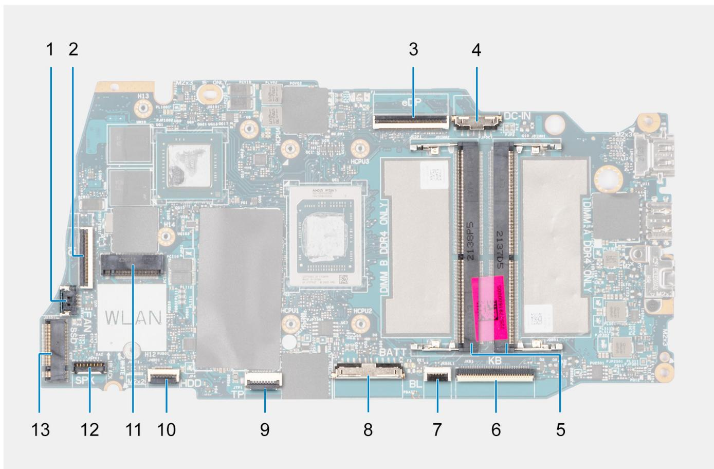
1. Conector del cable del ventilador
