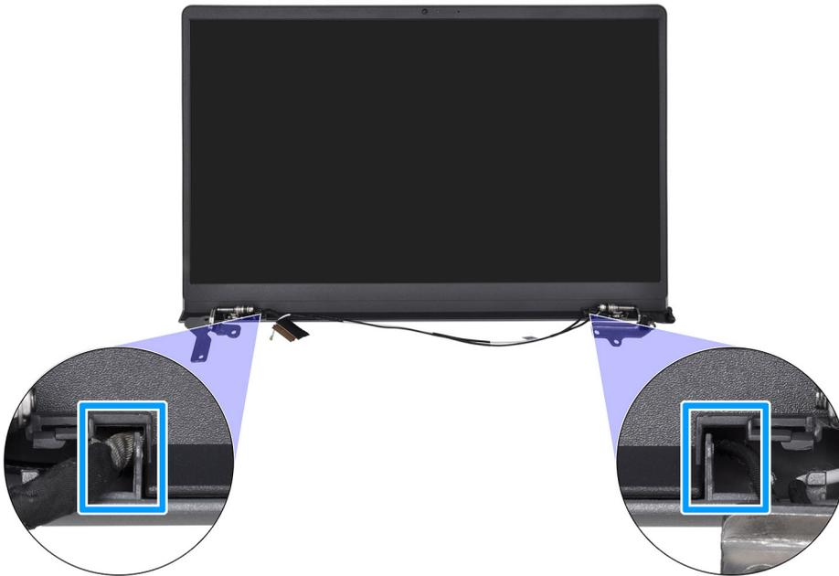
2. Haga palanca con cuidado para abrir el borde externo de la parte inferior del bisel de la pantalla.
