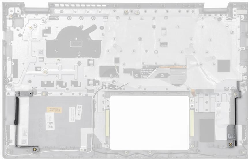
3. Después de realizar los requisitos previos, queda el ensamblaje del teclado y del reposamanos.
