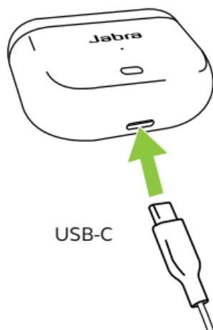
L'étui connecté utilise une tension USB standard de 5 V +/- 0,25 V. Nous vous déconseillons de recharger les écouteurs avec une alimentation électrique affichant une tension supérieure.
