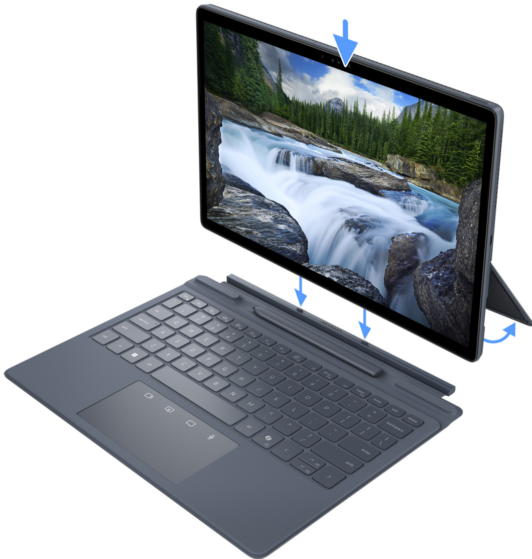
Abbildung 9. Befestigen der Latitude 7350 Detachable Collaboration-Tastatur
