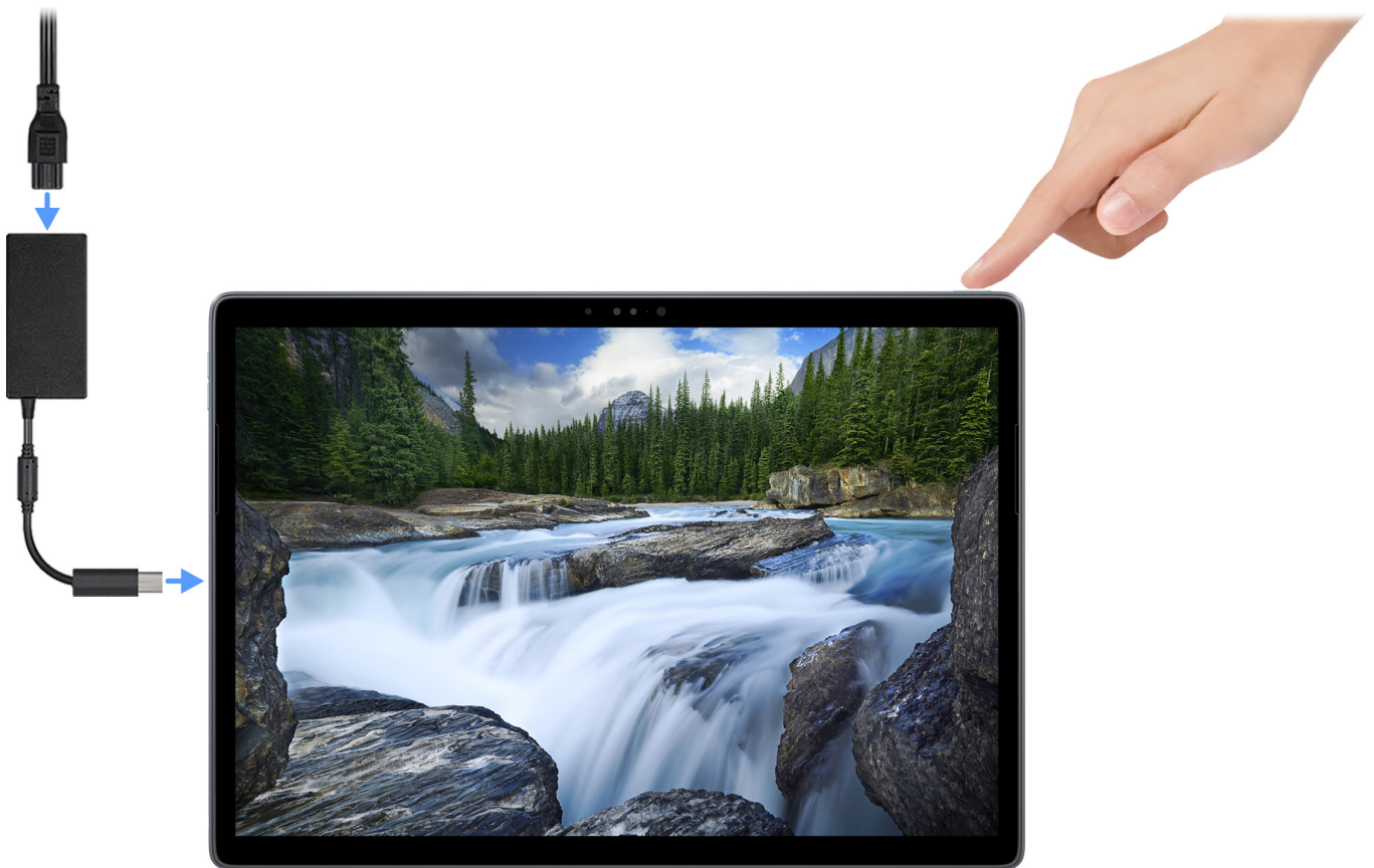
Abbildung 8. Anschließen des Netzadapters und Drücken des Betriebsschalters
