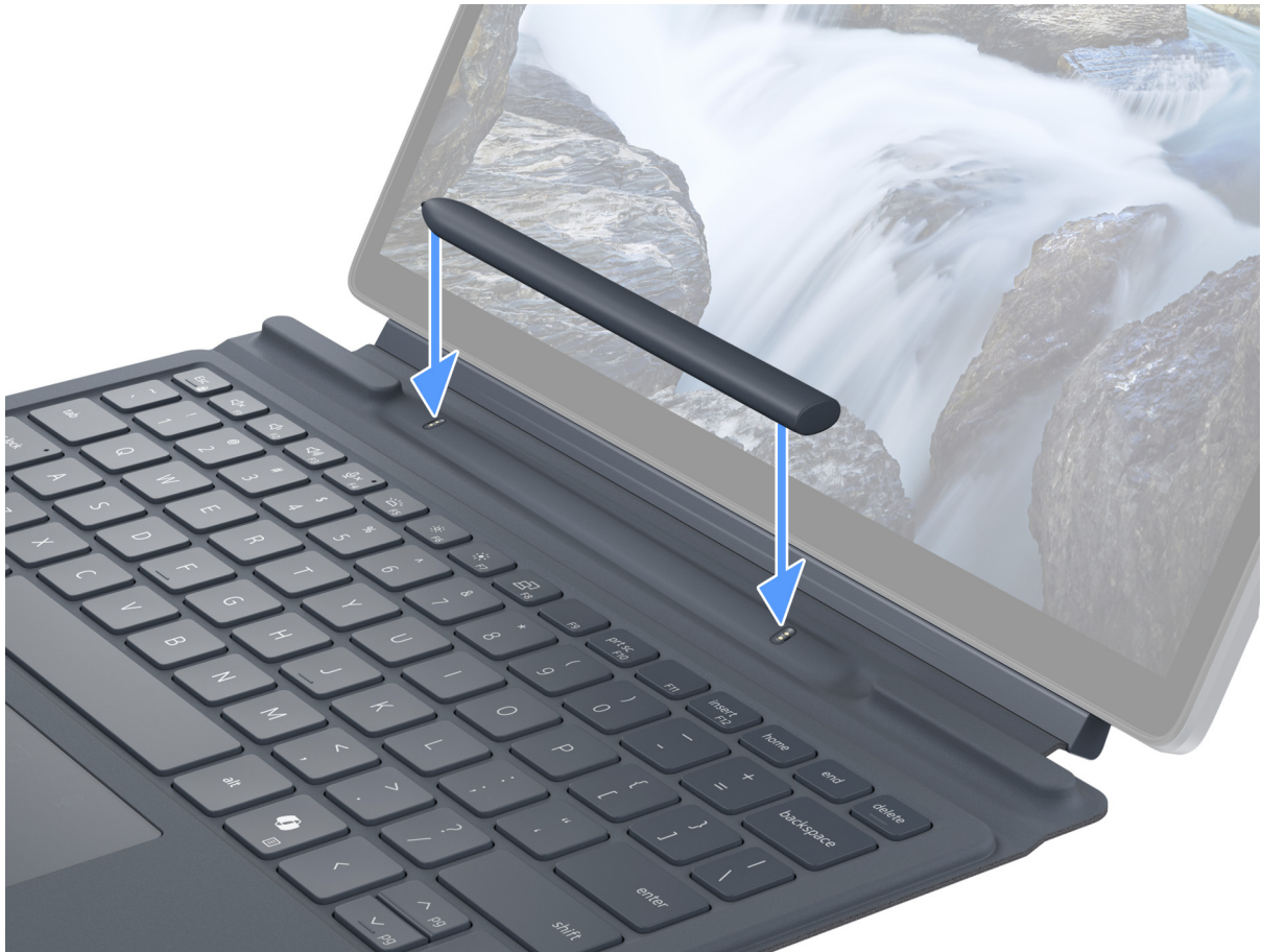
Abbildung 10. Andocken des Active Pen für Latitude 7350 Detachable
