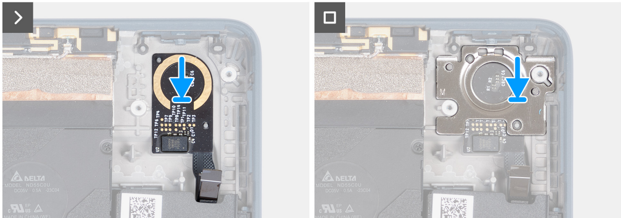
Abbildung 64. Installieren des Fingerabdruck-Lesegeräts
