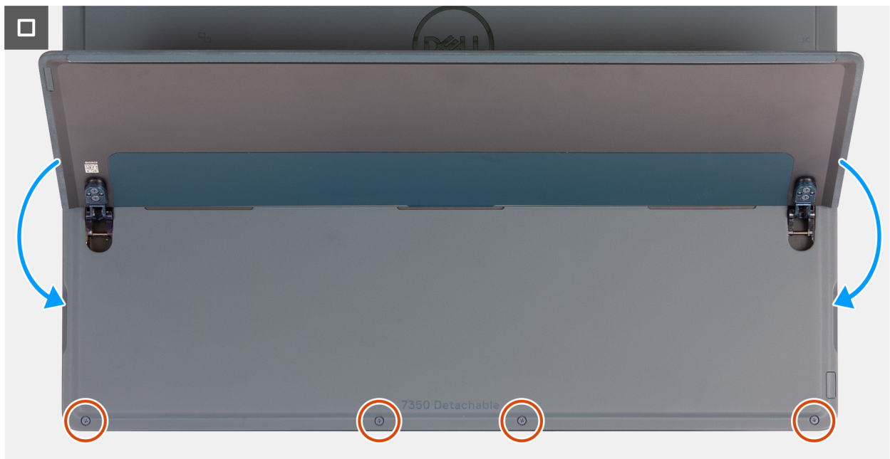
Abbildung 23. Einbauen der Bildschirmbaugruppe
