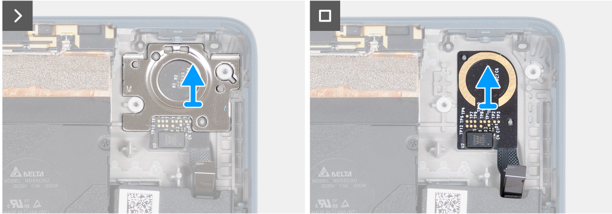
Abbildung 63. Entfernen des Fingerabdruck-Lesegeräts
