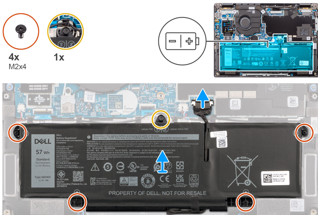
Abbildung 31. Entfernen des 4-Zellen-Akkus
