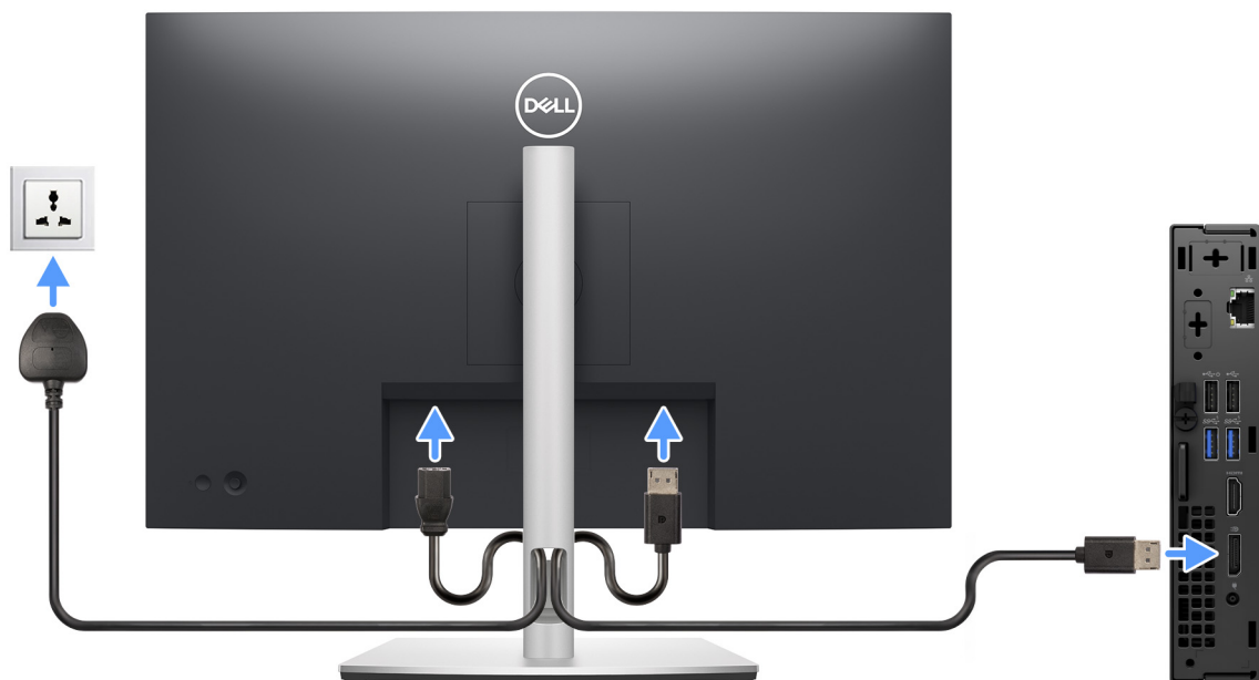
Figura 5. Connessione del display
