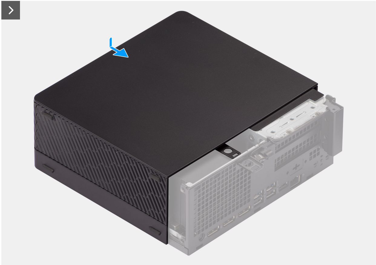
Afbeelding 12. De zijplaat plaatsen
