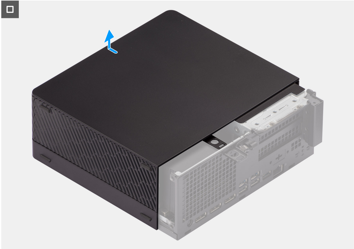
Afbeelding 11. Het zijpaneel verwijderen
