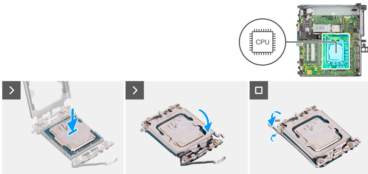
Afbeelding 41. De processor plaatsen
