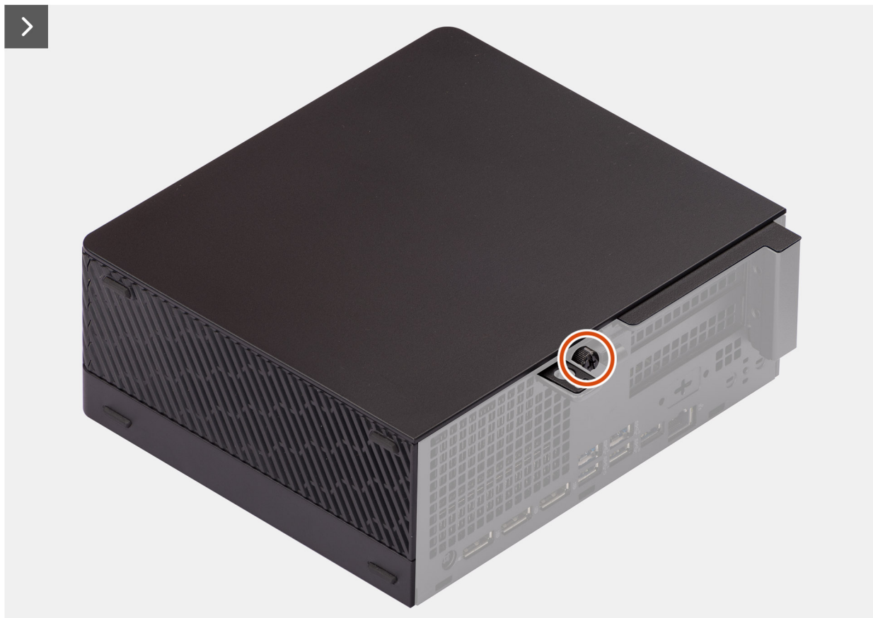
Afbeelding 10. Het zijpaneel verwijderen
