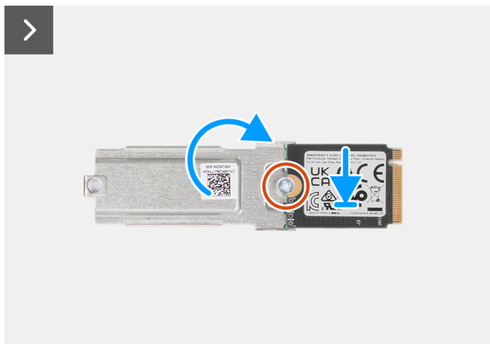
Afbeelding 21. De M.2 2230 PCIe SSD (slot 2) plaatsen
