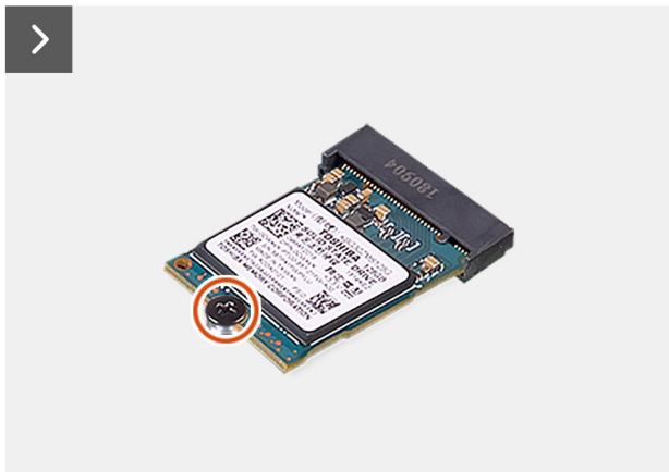
Afbeelding 22. De M.2 2230 PCIe SSD verwijderen
