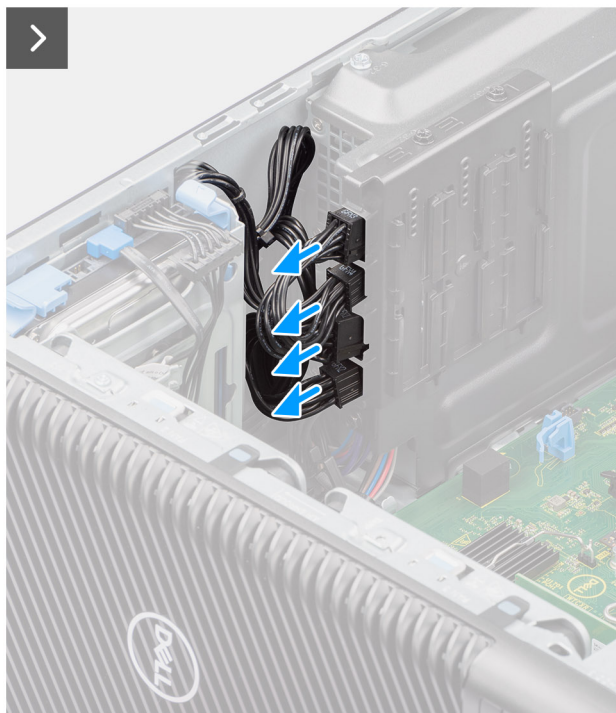
Afbeelding 46. De kap van de voedingseenheid verwijderen
