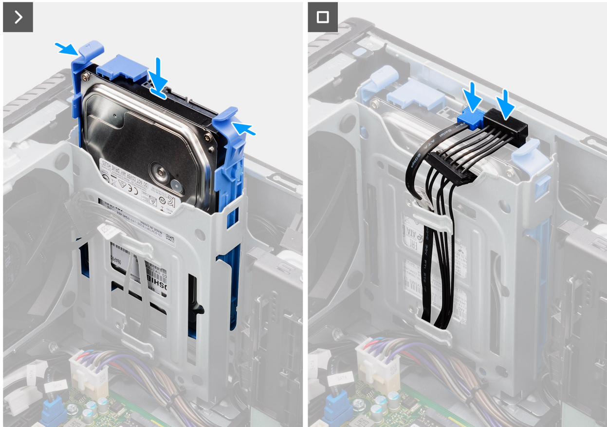
Afbeelding 21. De 3,5-inch harde-schijf eenheid vanuit bay 1 installeren
