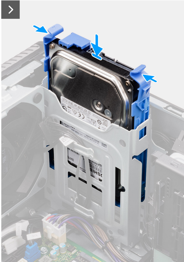
Afbeelding 20. De 3,5 inch harde-schijfeenheid (bay-2) installeren
