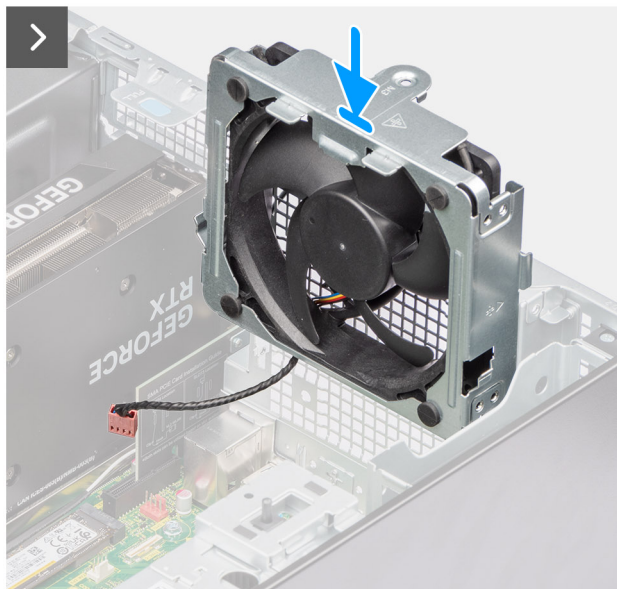
Afbeelding 67. De achterste ventilator installeren (1000 W PSU)
