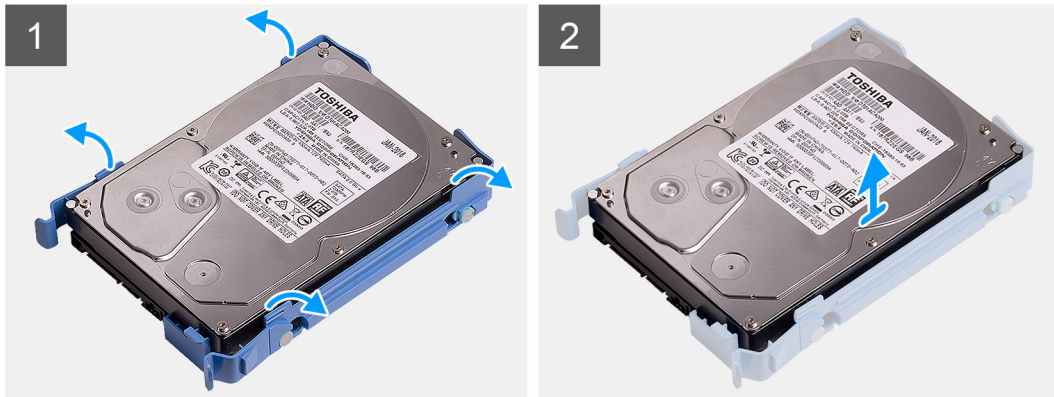
Afbeelding 18. De beugel van de 3,5-inch harde schijf verwijderen
