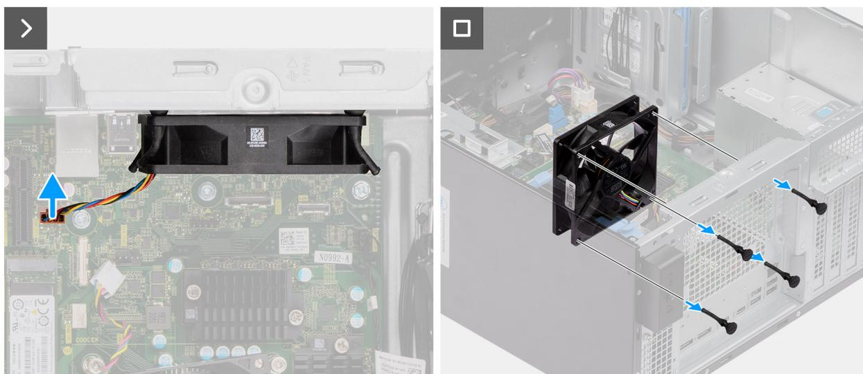
**Abbildung 64. Entfernen des hinteren Lüfters bei Systemen mit 300-W-Netzteilen**
