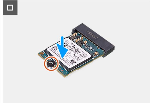
Abbildung 23. Einbauen des M.2 2230-PCIe-SSD-Laufwerks
