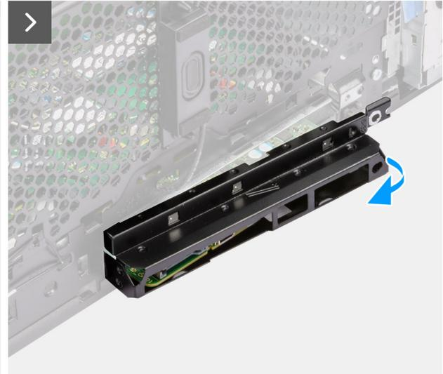
Abbildung 75. Entfernen der Systemplatine
