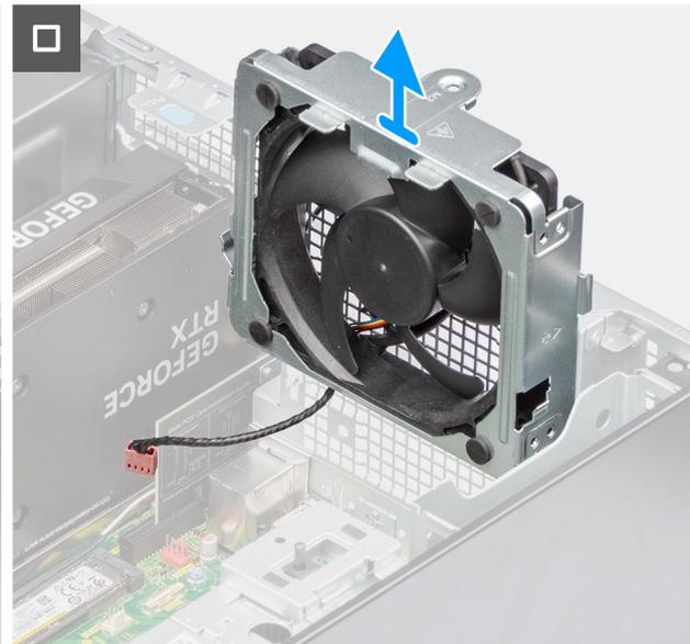
Abbildung 66. Entfernen des hinteren Lüfters (1000-W-Netzteil)
