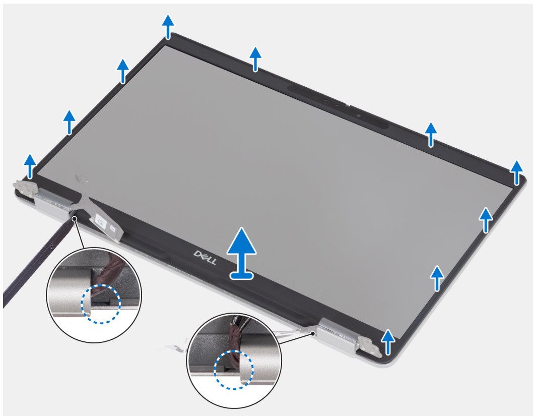
Afbeelding 67. De beeldschermbezel verwijderen (laptop)
