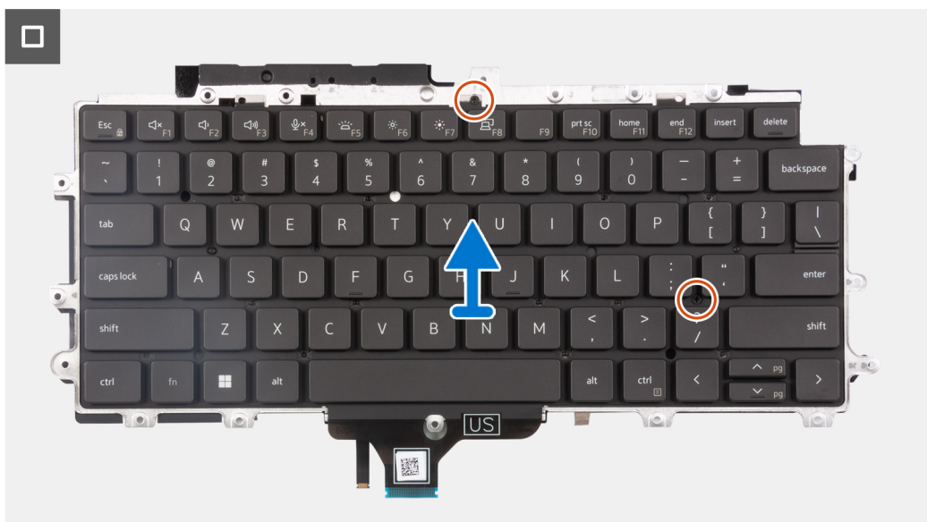
Afbeelding 60. De toetsenbordeenheid verwijderen
