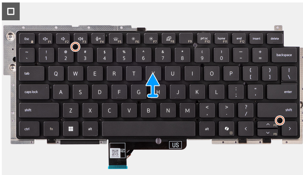
Afbeelding 66. Het toetsenbord verwijderen
