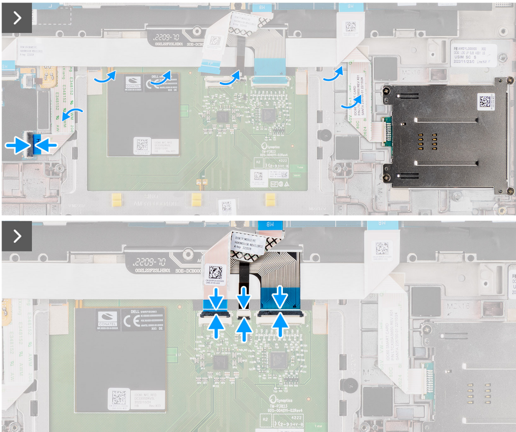
Afbeelding 48. De smartcardlezer installeren
