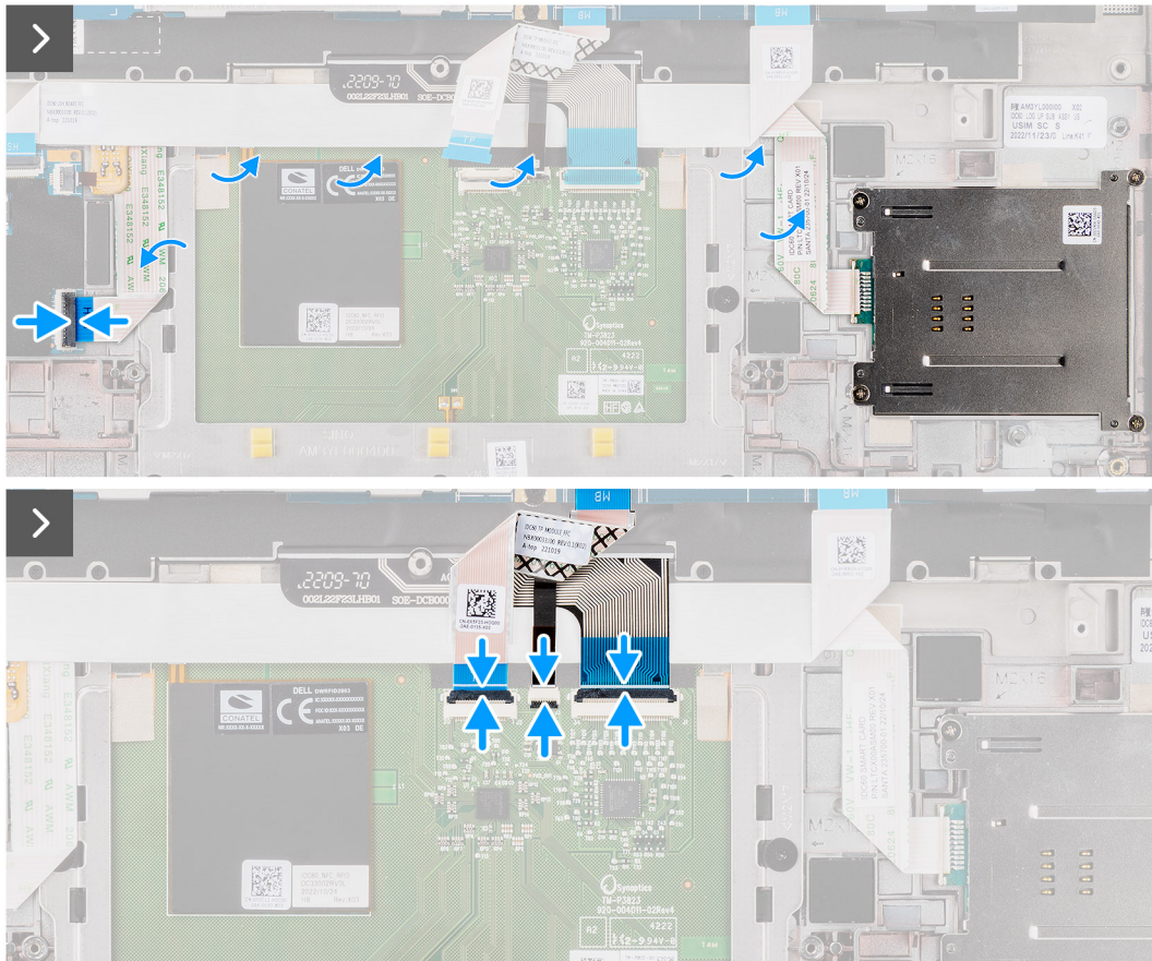
Afbeelding 48. De smartcardlezer installeren
