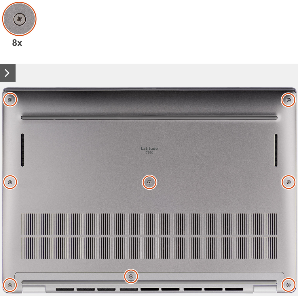
Afbeelding 12. De onderplaat verwijderen
