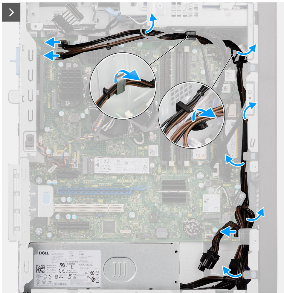
Figura 74. Rimozione dell'unità di alimentazione
