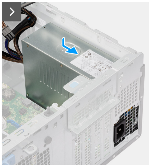
Figura 76. Installazione dell'unità di alimentazione
