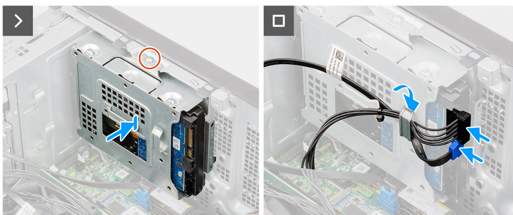
Figura 43. Installazione del disco rigido secondario da 3,5 pollici
