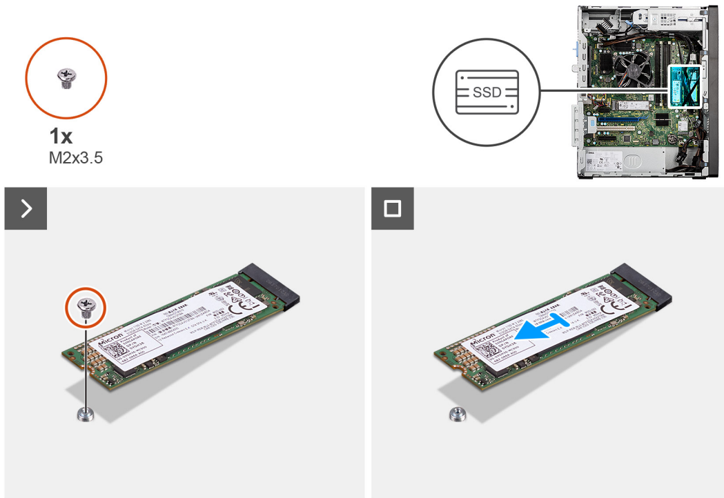
Figura 21. Rimozione dell'unità SSD M.2 2280
