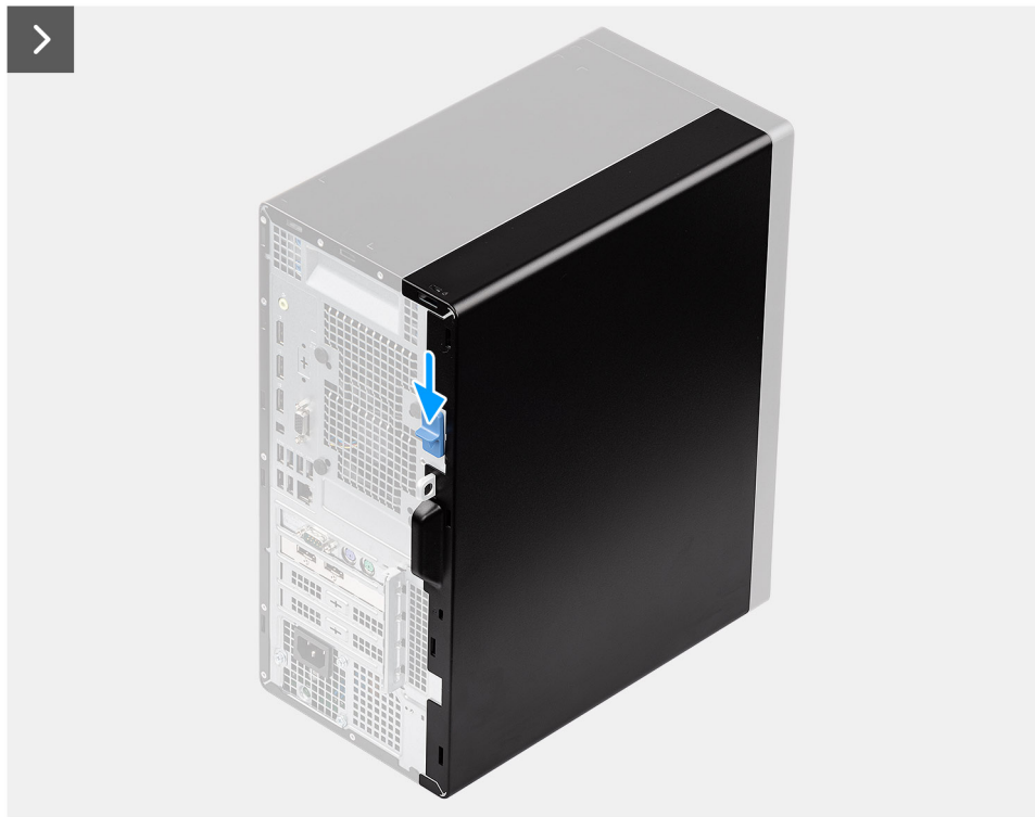
Figura 9. Rimozione del coperchio laterale
