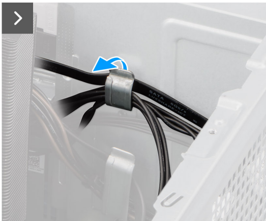
Figura 44. Rimozione dell'unità ottica slim
