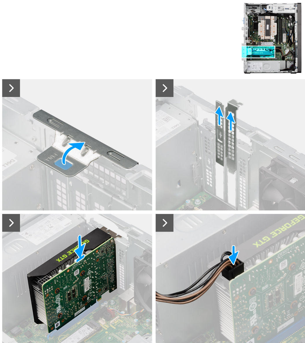
Figura 30. Installazione della scheda grafica alimentata
