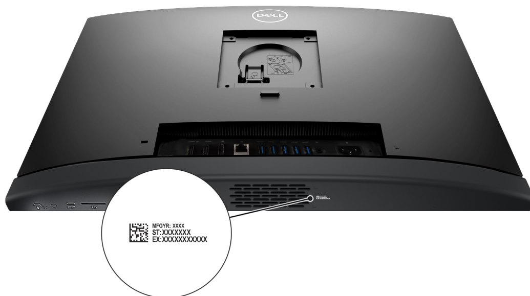
Figura 9. Localização da etiqueta de serviço do OptiPlex All-in-One 7420
