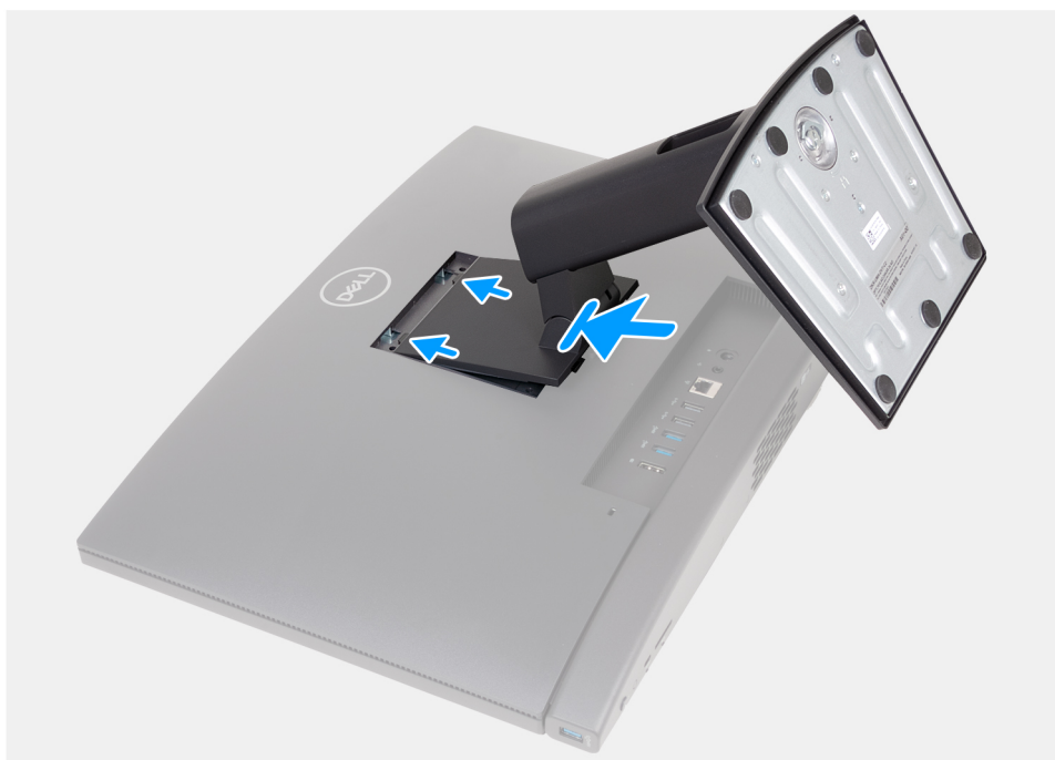
Figura 80. Como instalar o suporte
