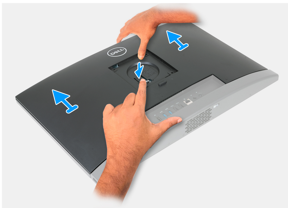
Figura 82. Como remover a tampa traseira
