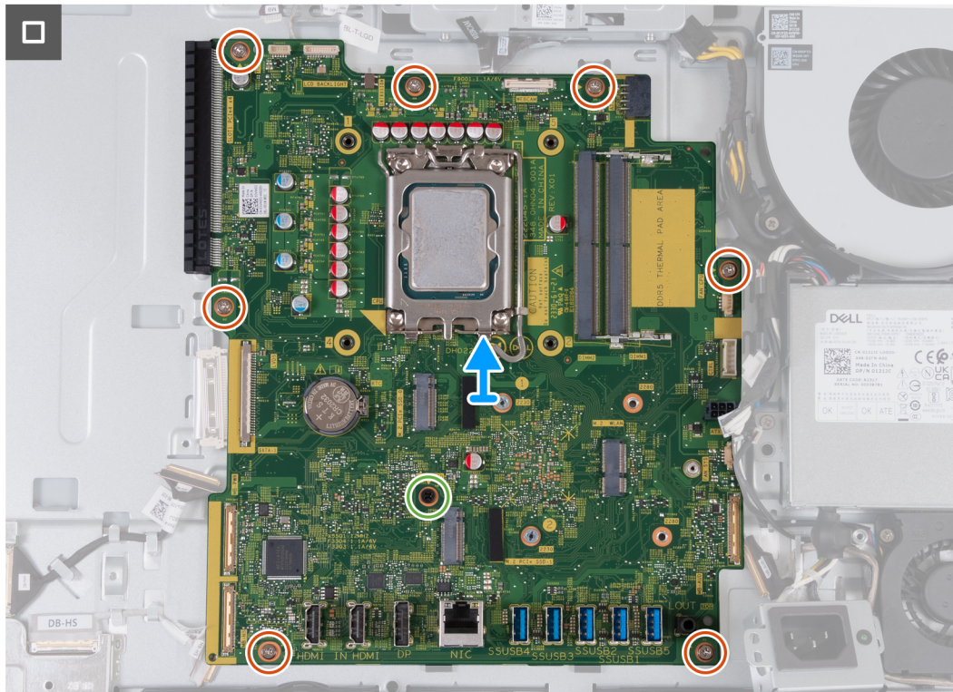
Figura 68. Como remover a placa de sistema
