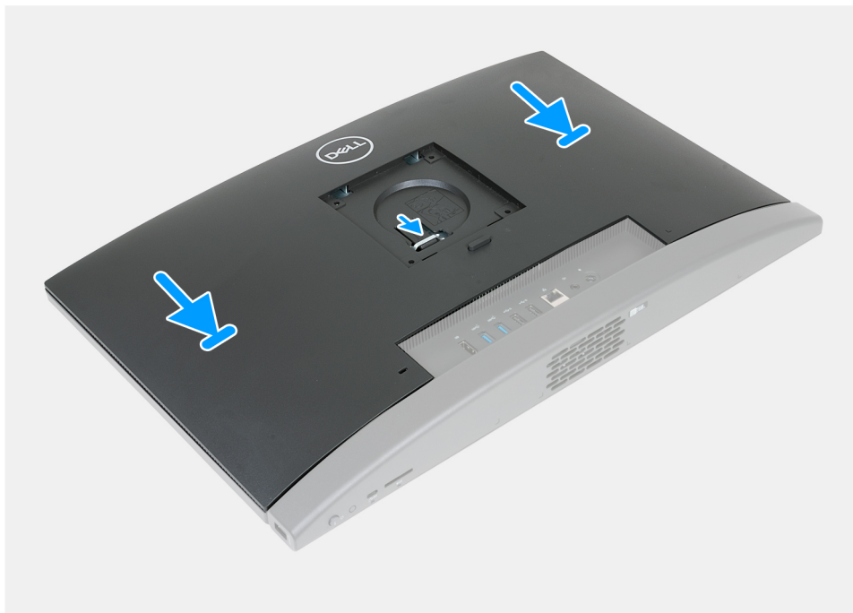
Figura 83. Como instalar a tampa traseira
