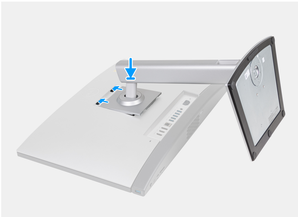
Figura 20. Como instalar o suporte ajustável de altura (HAS)
