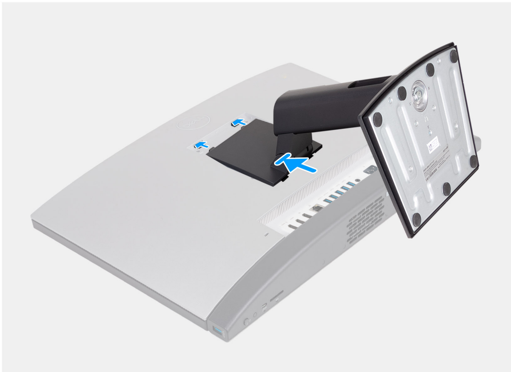
Figura 21. Como instalar o suporte fixo
