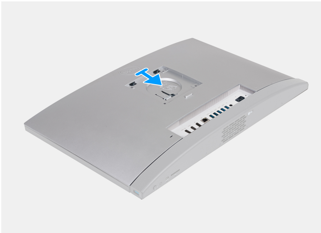
Ilustración 23. Instalación de la cubierta posterior
