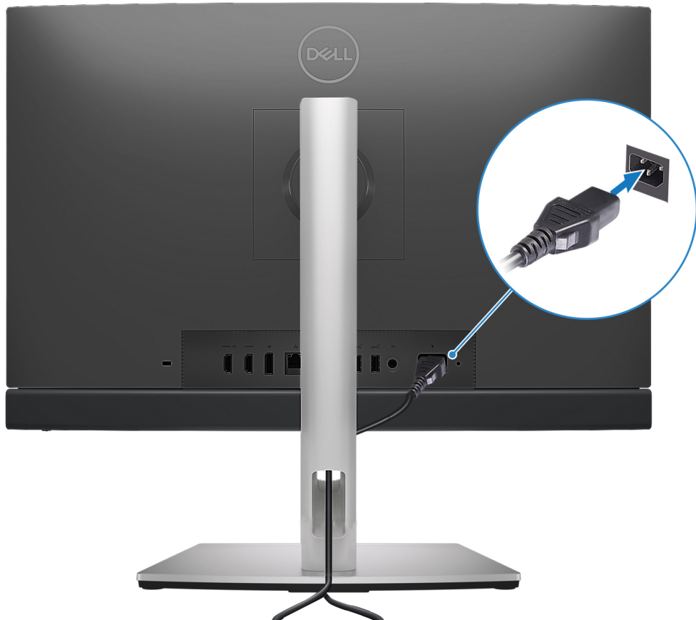
Ilustración 13. Conexión del cable de alimentación
