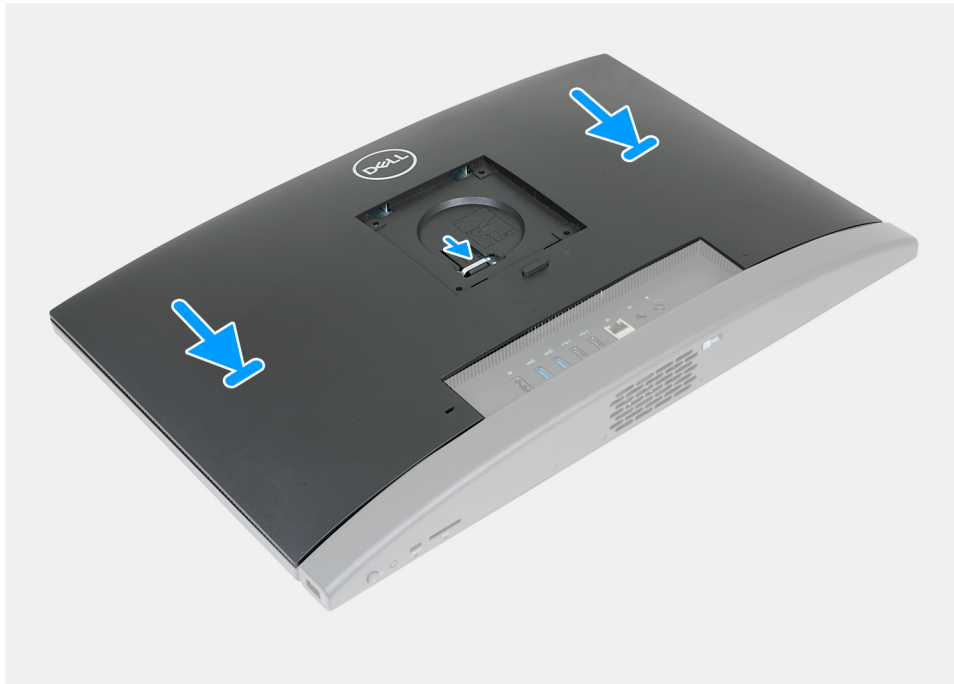
Ilustración 83. Instalación de la cubierta posterior
