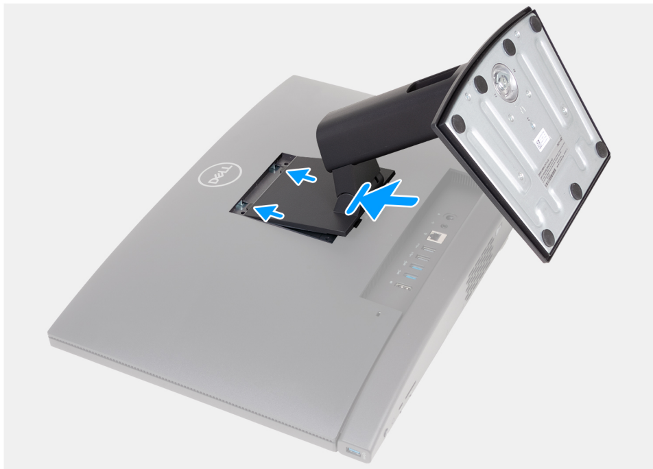
Ilustración 80. Instalación de la base
