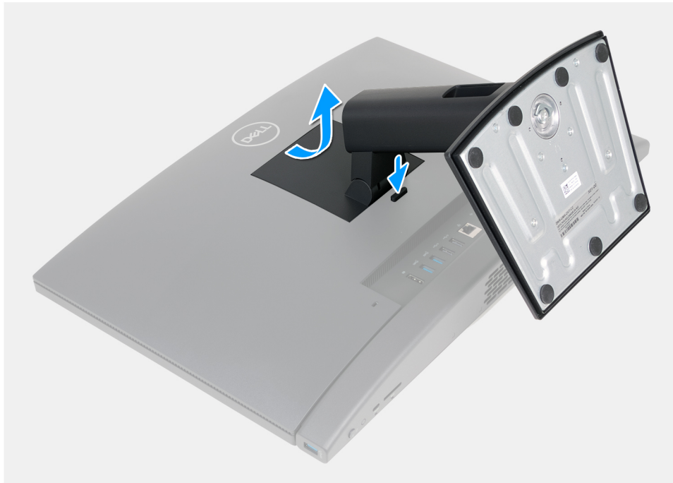
Ilustración 78. Extracción de la base
