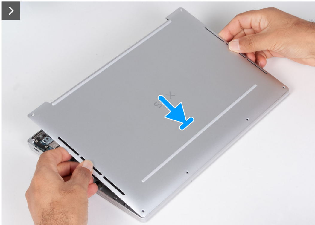
Figura 16. Installazione del coperchio della base
