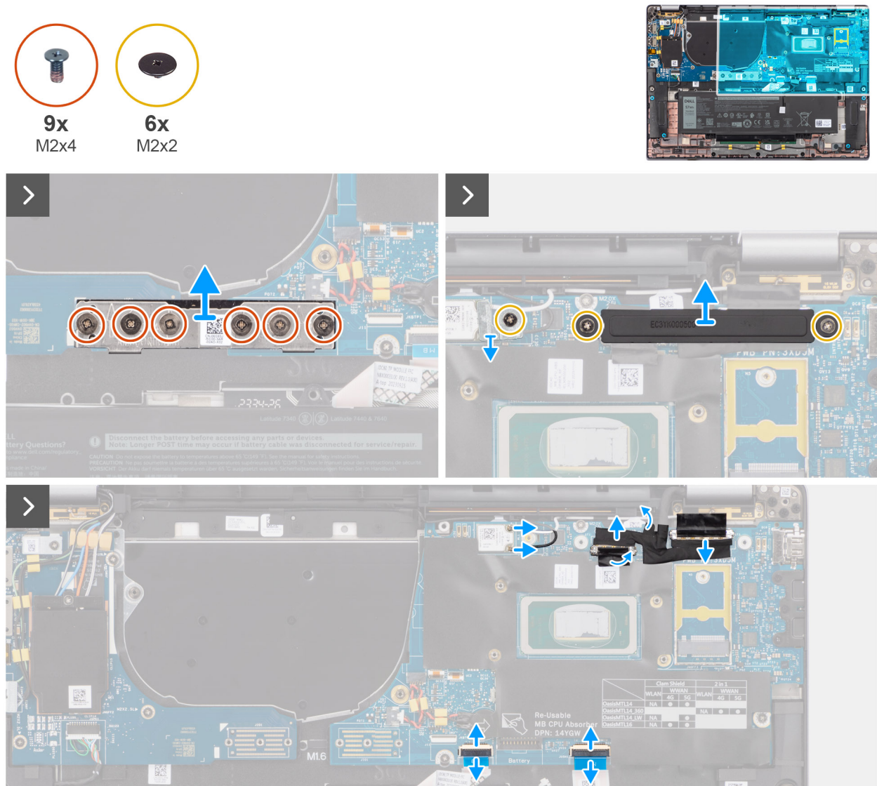
Figura 50. Rimozione della scheda di sistema
