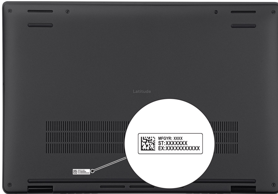
Figura 6. Posizione del codice di matricola
