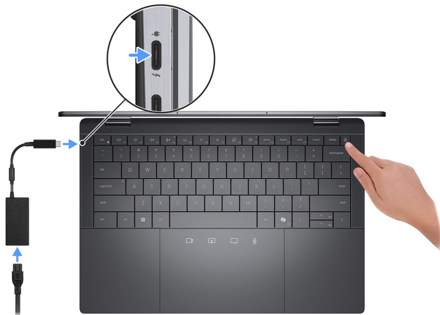
Figura 11. Collegare l'adattatore per l'alimentazione
