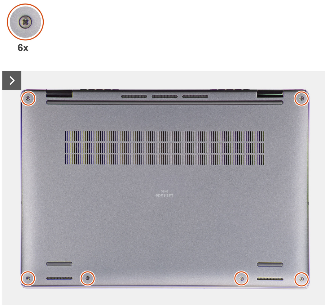
Figura 19. Rimozione del coperchio della base
