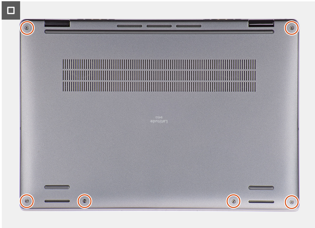
Figura 23. Installazione del coperchio della base
