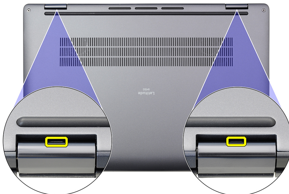
Figura 21. Punti di leva del coperchio della base
