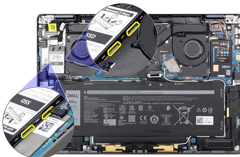
Figura 29. Copertura di protezione unità SSD M.2
