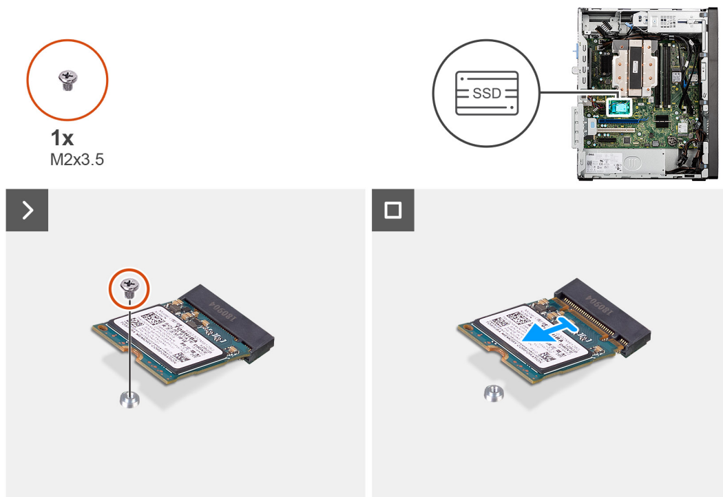
Abbildung 18. Entfernen des M.2-2230-Solid-State-Laufwerks
