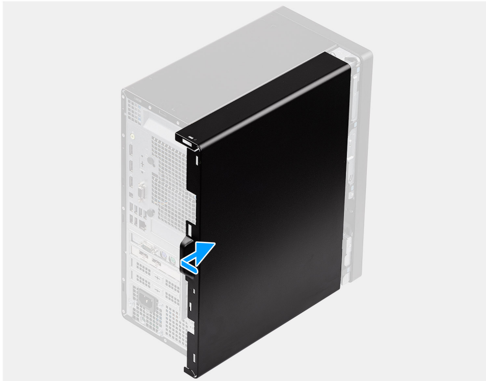
Abbildung 11. Anbringen der Seitenabdeckung
