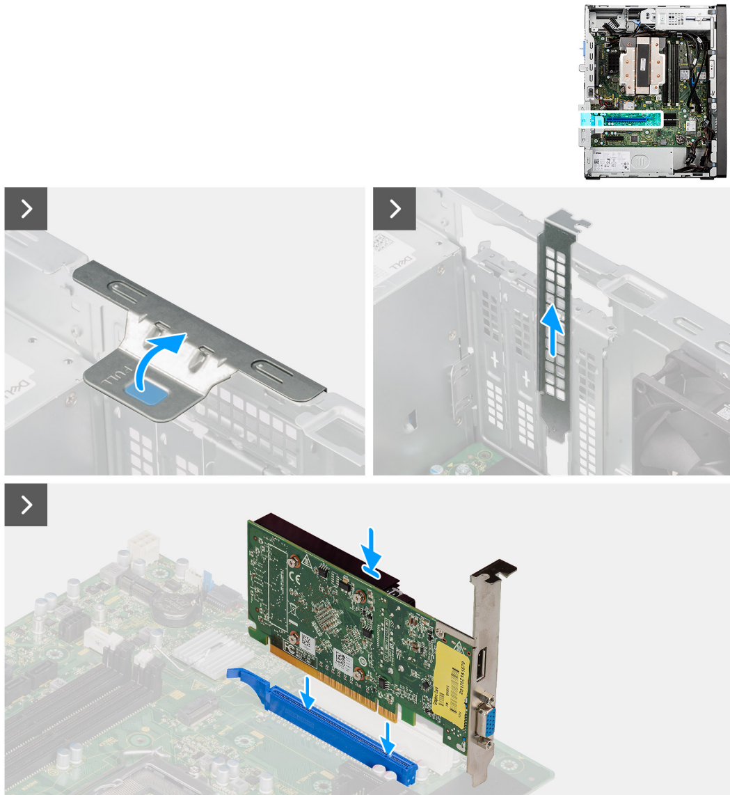
Abbildung 56. Installieren der Erweiterungskarte mit seriellen/parallelen Ports
