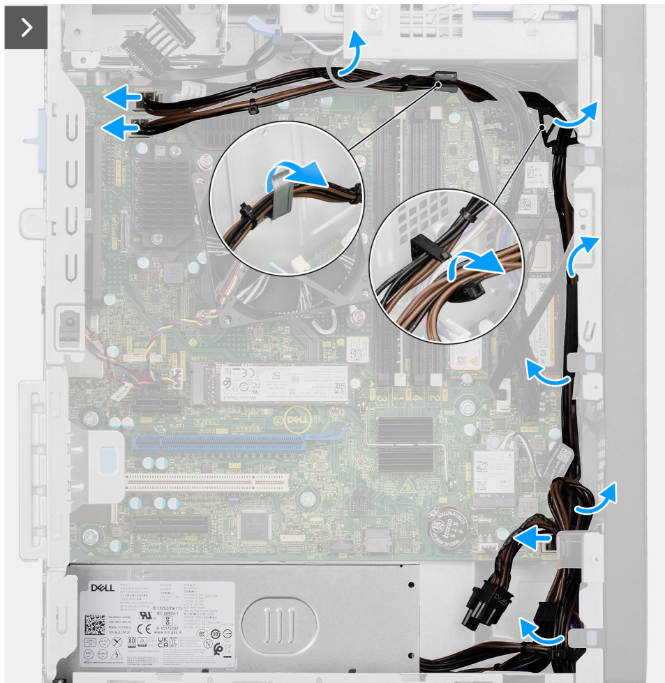
Abbildung 74. Entfernen der Stromversorgungseinheit
