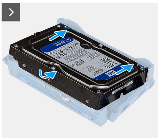
Abbildung 37. Einbauen der 3,5"-Festplatte
